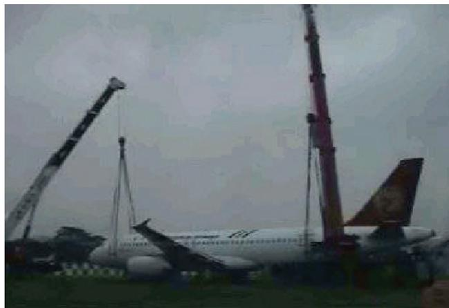
圖 1.18-4 機身 15、21 及 62 橫框處以吊帶拖吊
