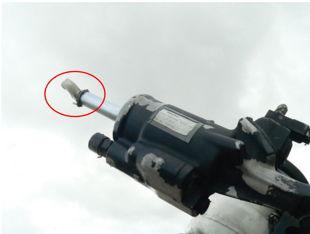
圖 1.12-2 後紅邊旋翼減震器組件接頭裂斷 1 (紅圈處)
