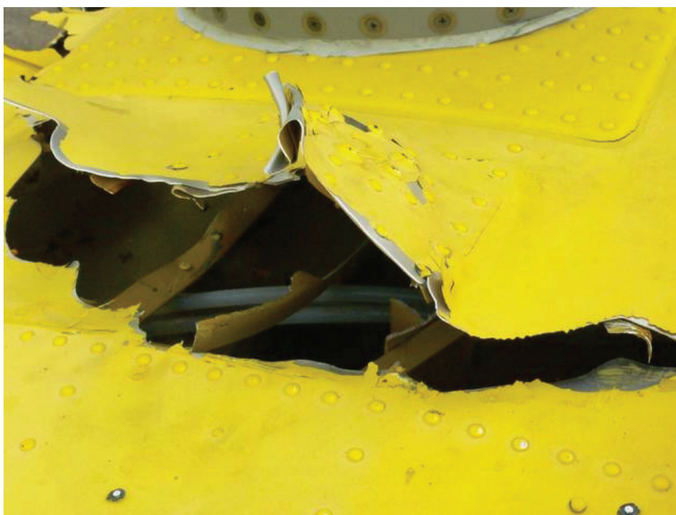
圖 1.12-7 左機身上方 STA 210~240, WL+130, LBL 20~40 蒙皮結構破裂
