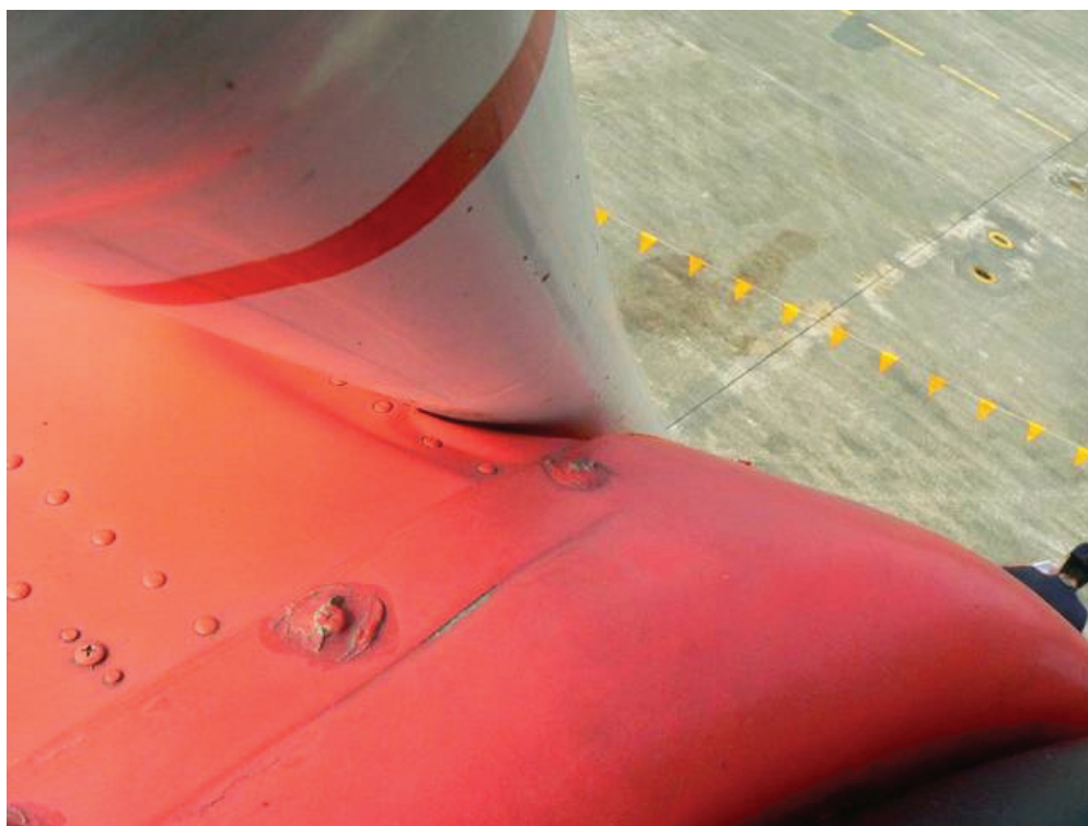
圖 1.12-9 機尾後旋翼艙左側上方 STA 560~580, WL+130, LBL10 蒙皮及結構變形
