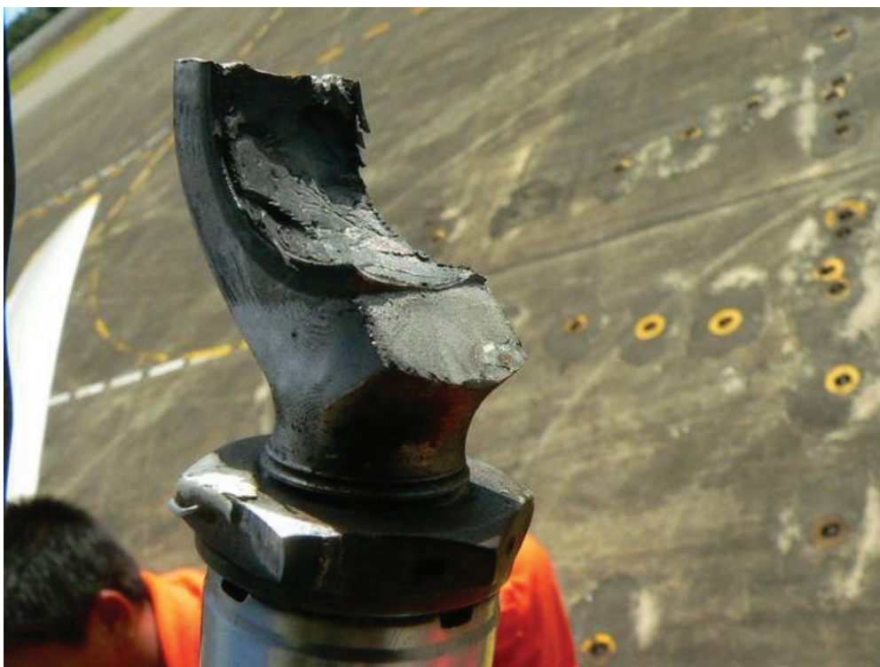
圖 1.12-3 後紅邊旋翼減震器組件接頭裂斷 2
