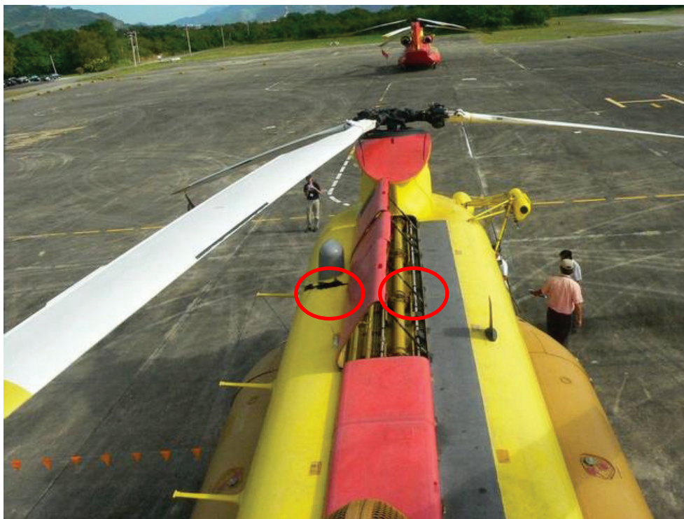
圖 1.12-6 左機身上方 STA 210~240, WL+130, LBL 20~40 蒙皮結構破裂與傳動軸蓋連結處 STA 240, WL+130, LBL 10 結構變形
