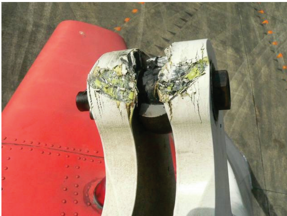
圖 1.12-4 後紅邊旋翼減震器組件連桿接頭裂斷
