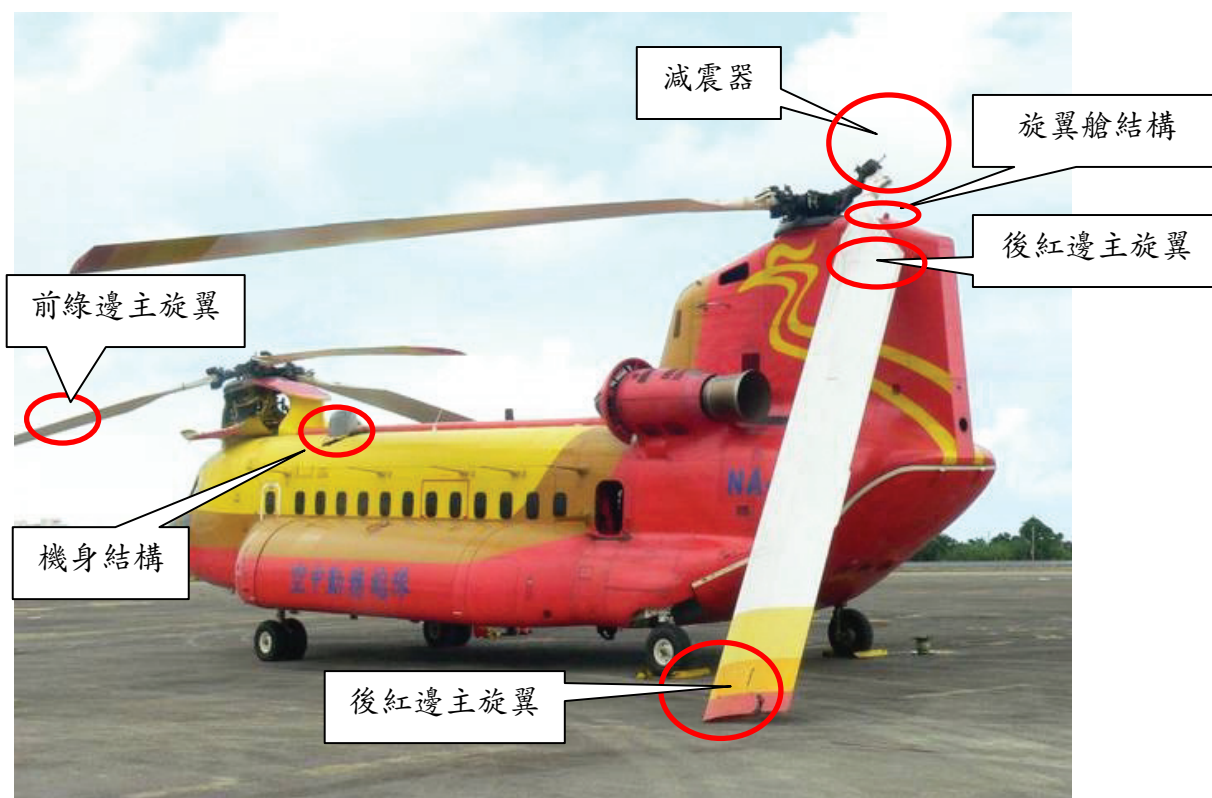
圖 1.12-1 NA-603 機損害外觀圖（紅圈處）
