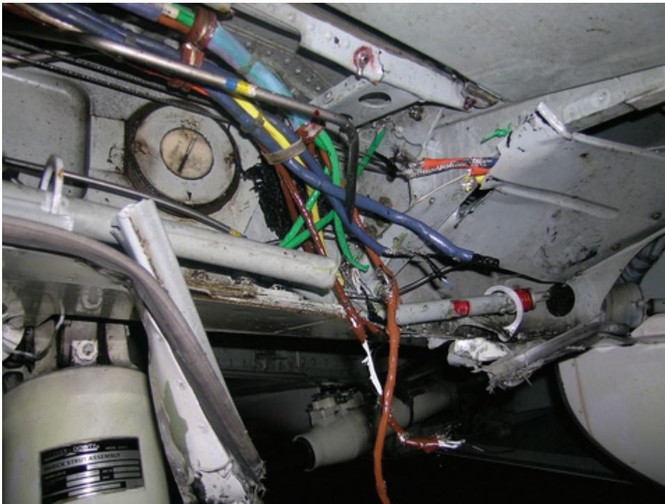
圖 1.8-3 左內側主輪上方機翼次結構破裂
