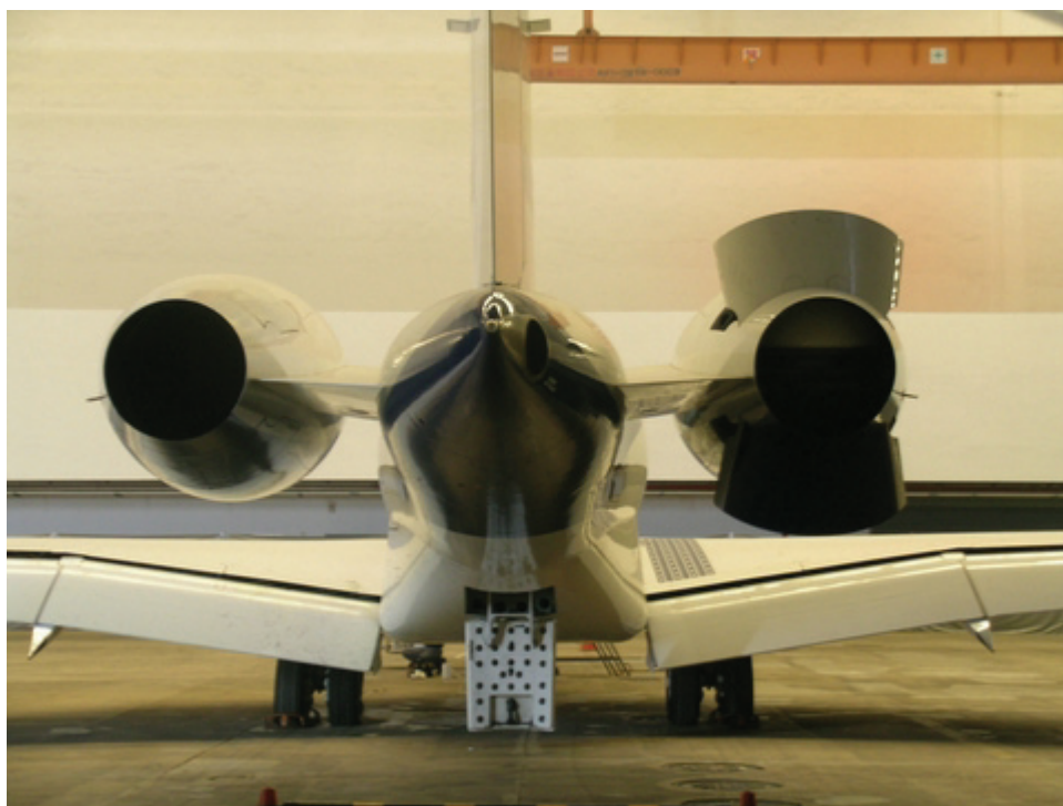
圖 1.8-1 右發動機反推力器仍於開展位置
