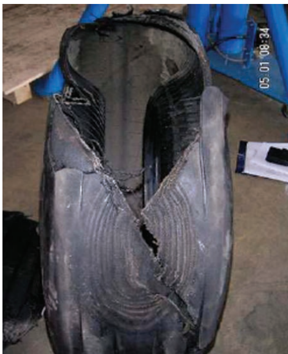
圖 1.9-3 損壞部位沒有熱生成和外物切割的現象
