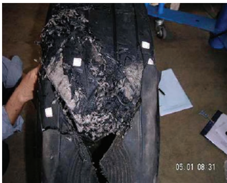
圖 1.9-4 胎面碎片自輪胎的 12 點鐘位置至 3 點鐘位置脫離
