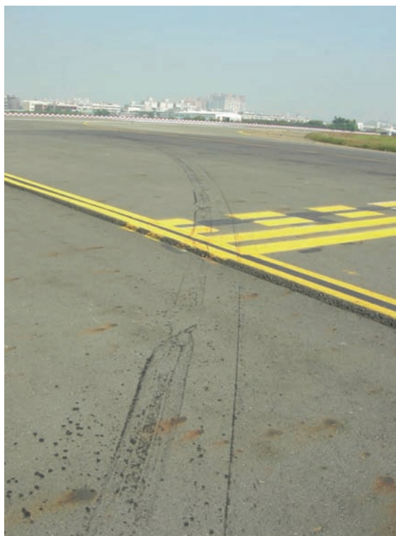
圖 1.8-4 左側內外主輪軌跡及液壓油洩漏痕跡圖
