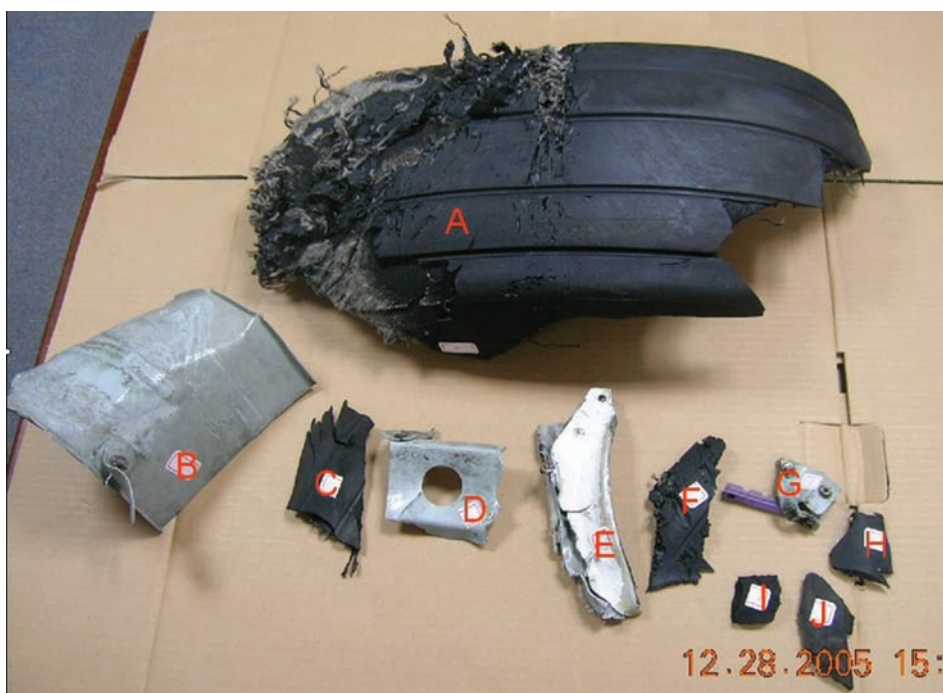
圖 1.8-6 由航機脫落之零件
