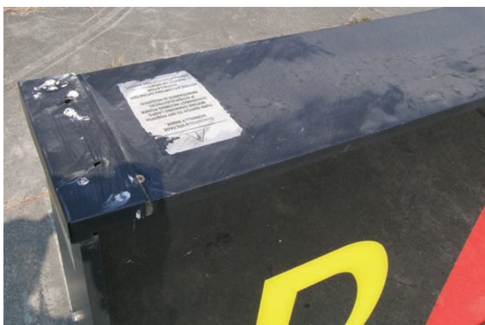
圖 1.8-8 強制性指示牌磨損情形
