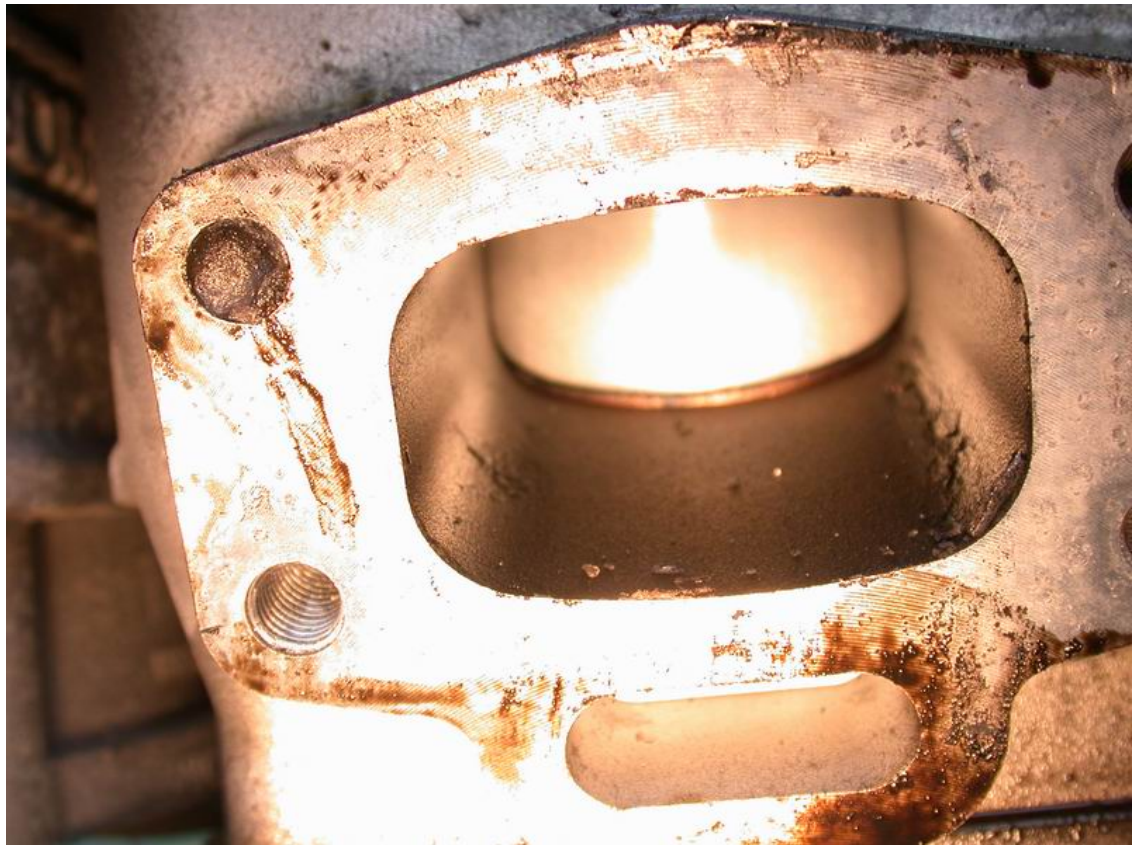
圖八 二號汽缸排氣門與附著之銅屑
