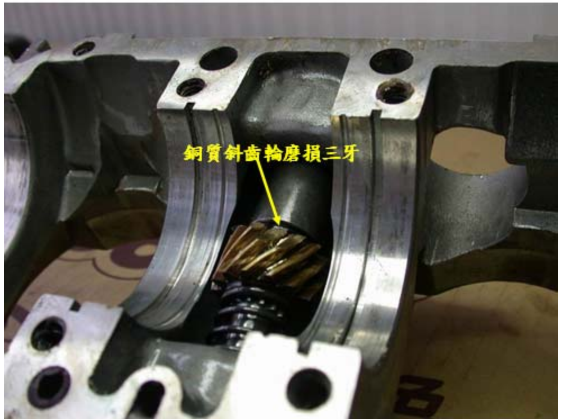
圖五銅質斜齒輪磨損
