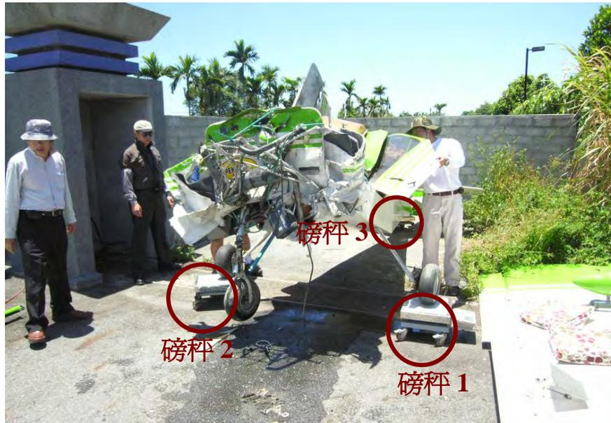
圖 21 量測飛機本體 A 之重量(不含發動機)
