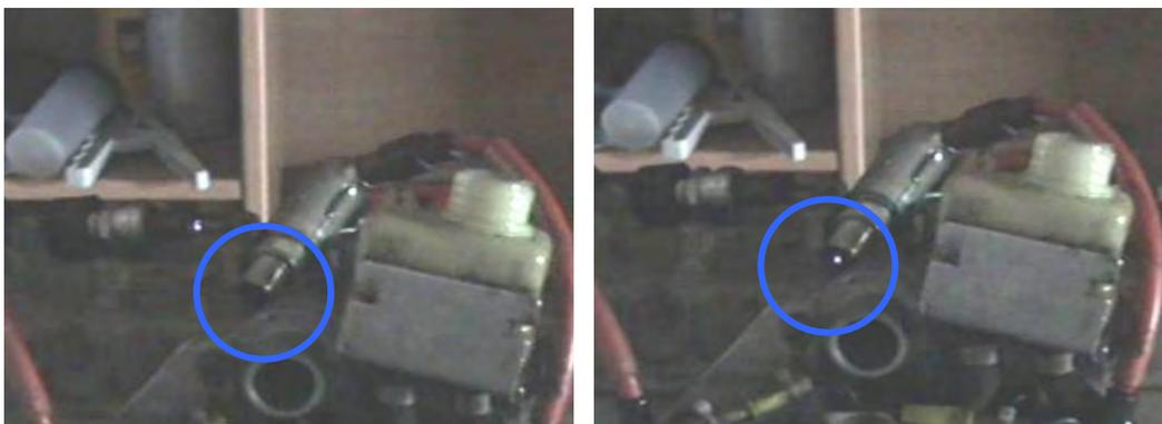
圖 1.29 高壓線圈及火星塞點火測試
