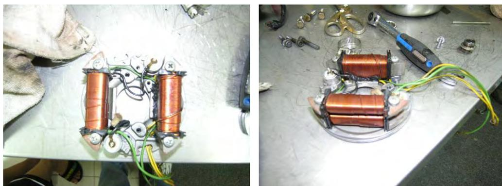
圖 1.26 檢查磁電機線圈及接點
