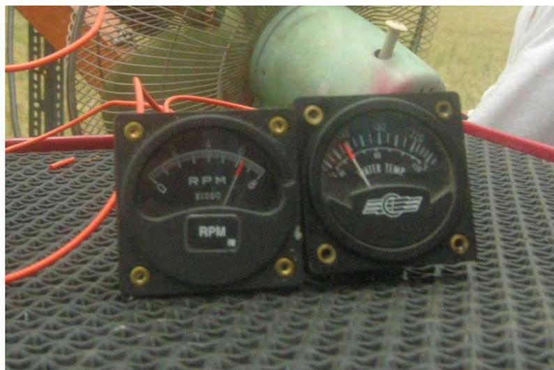
圖 1.31 全馬力 6,400 RPM (冷卻水溫度 80 °C)
