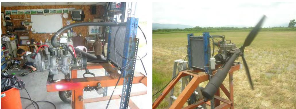
圖 1.30 發動機上測試台模擬五邊航線的動力狀況
