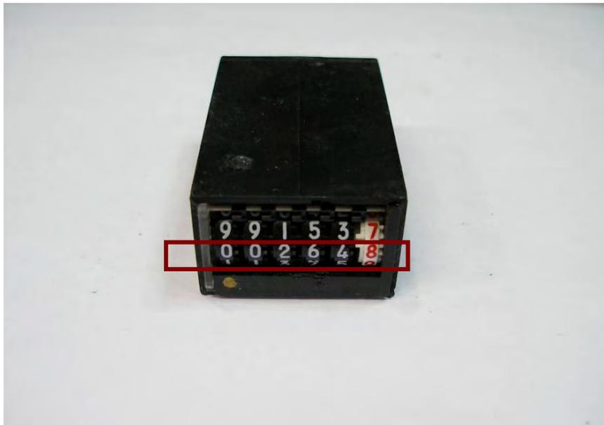
圖 8 發動機運轉時間表
