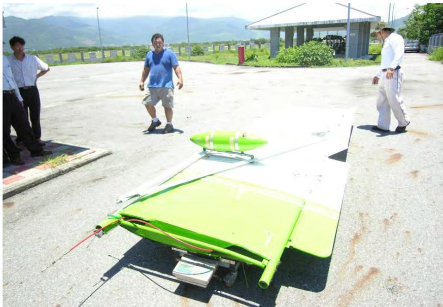
圖 22 量測左機翼 B 之重量
