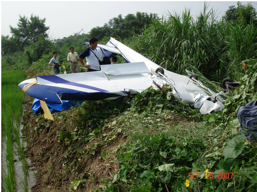
圖 4：左機翼受損情形
