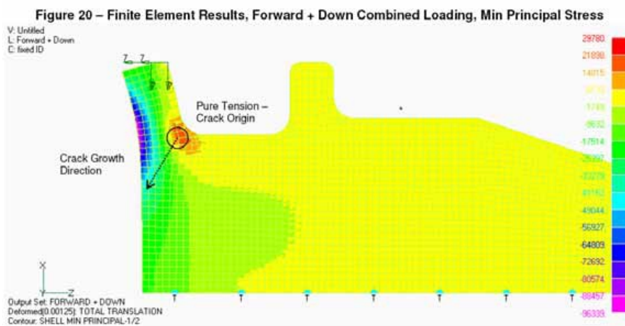
圖 1.16-19 有限元素分析-應力 vs.模式 1 裂縫
