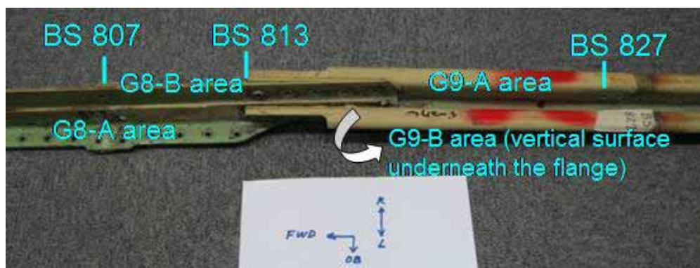
圖 1.12-33 G8-A, G8-B, G9-A, G9-B 區腐蝕情形
