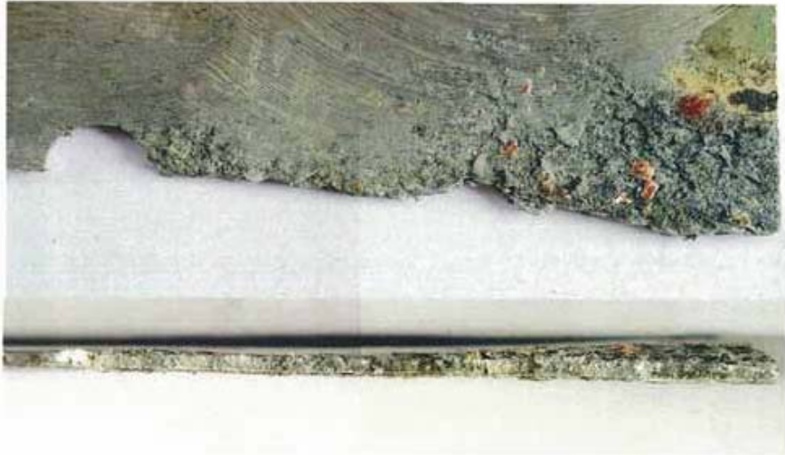
圖 3、編號 1 蒙皮試片巨觀觀察(下圖為斷面正視)。
