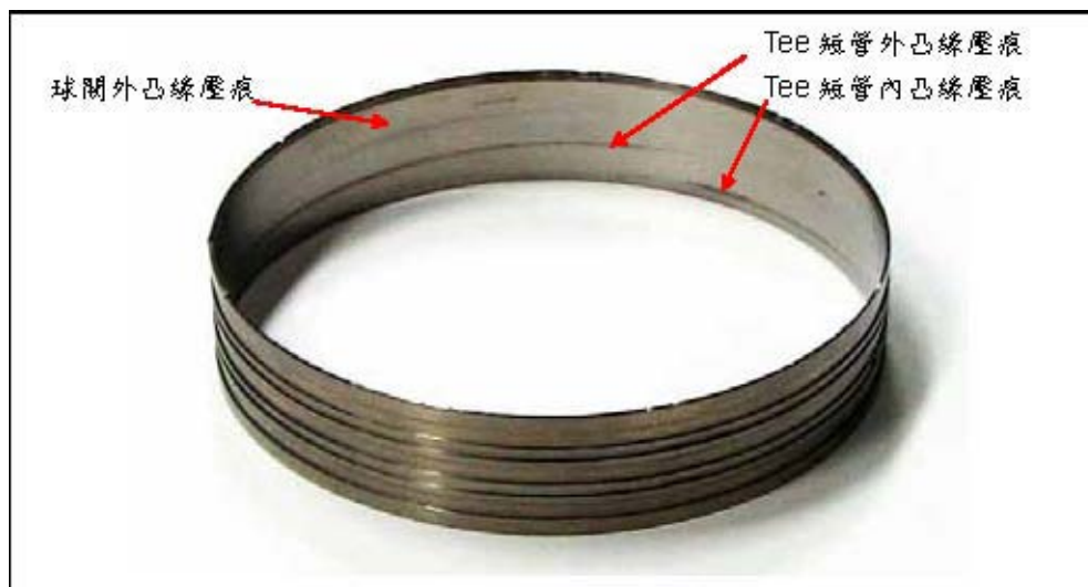
圖 2.3-9 襯套內側之凸緣壓痕
