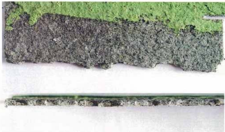
圖 6、編號 4 蒙皮試片巨觀觀察(下圖為斷面正視)。
