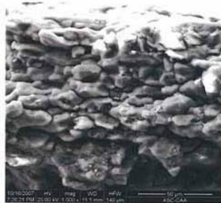
圖 17、編號 5 號試片鄰近內側表面之破斷面微觀特徵觀察。
