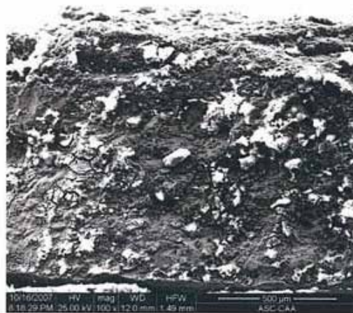
圖 14、編號 1 號試片 SEM 下之破斷面微觀特徵觀察。
