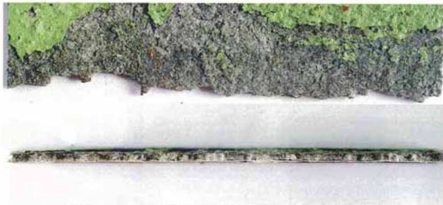
圖 5、編號 3 蒙皮試片巨觀觀察(下圖為斷面正視)。
