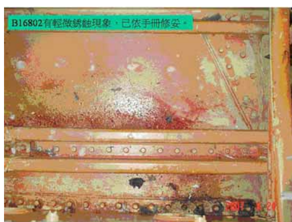
圖 1.16-2 飛機編號 B-16802 機腹蒙皮銹蝕
