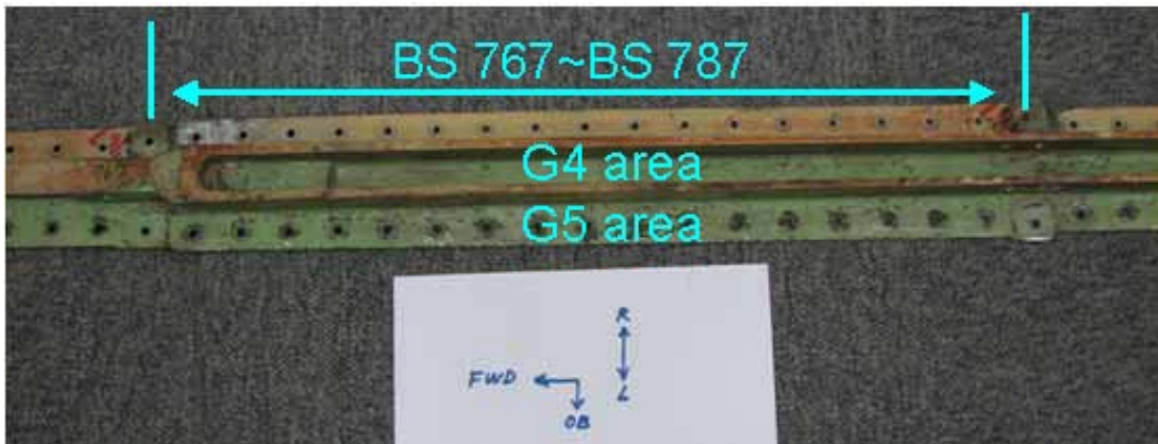
圖 1.12-29 G4、G5 區縱桁腐蝕情形
