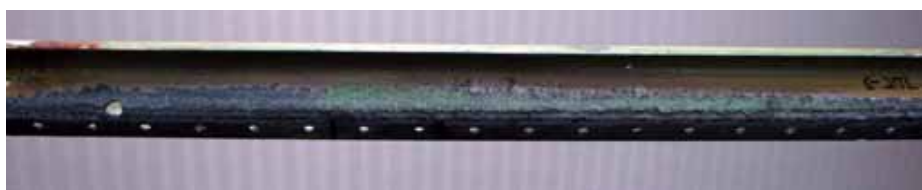
圖 1.12-36 G10-B 區腐蝕情形
