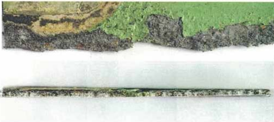
圖 4、編號 2 蒙皮試片巨觀觀察(下圖為斷面正視)。
