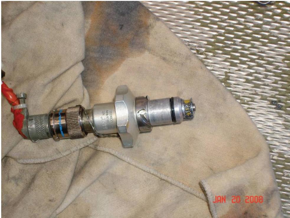
圖 1.12-9 發動機磁性塞吸附有金屬屑
