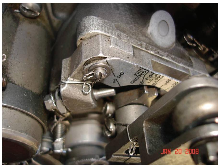
圖 1.12-6 發動機油門位於飛行慢伸位置
