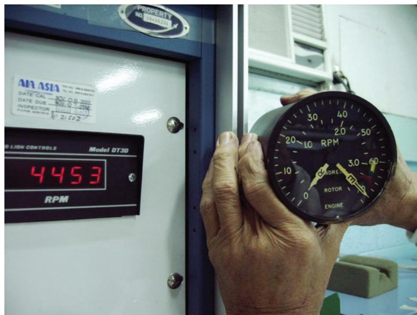
圖 1.16-8 發動機轉速指示功能檢測
