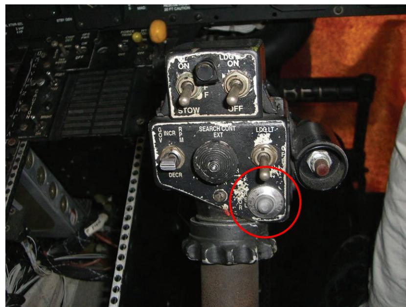
圖 1.16-5 油門手柄上之「ENGINE IDLE」按鈕（紅圈處）
