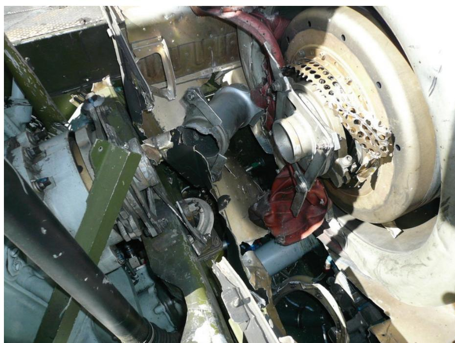
圖 1.12-4 主驅動軸組件斷落
