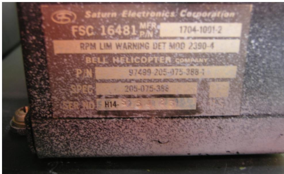
圖 1.12-7 低轉速警報偵測器
