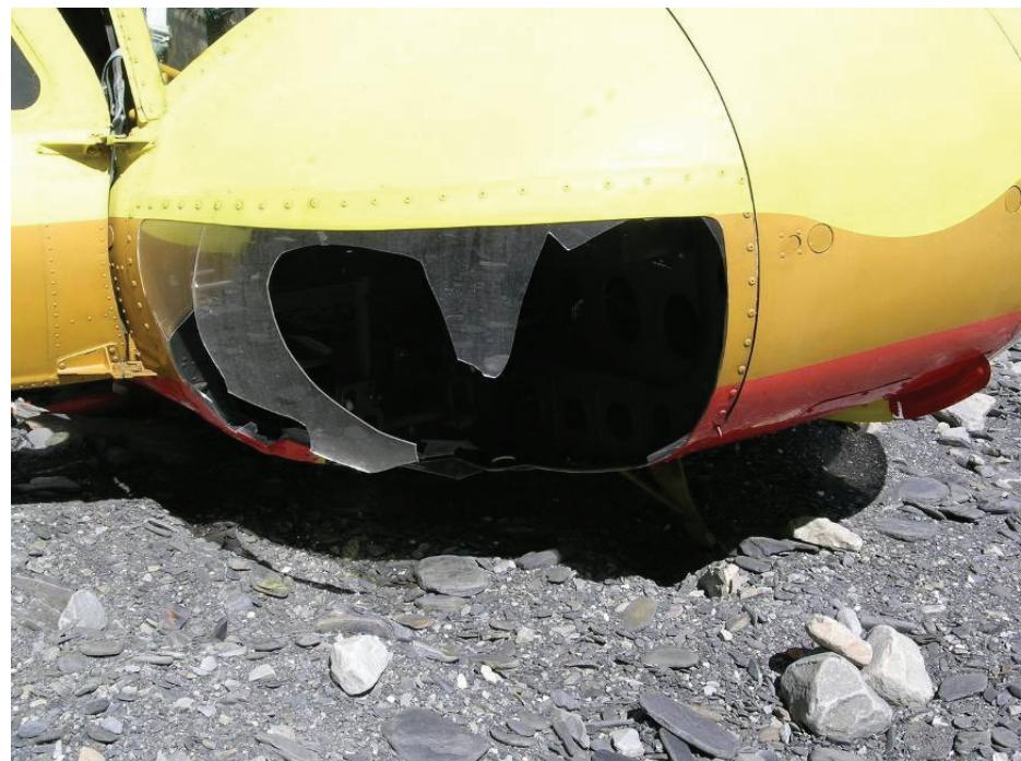
圖 1.12-3 右下視窗破裂
