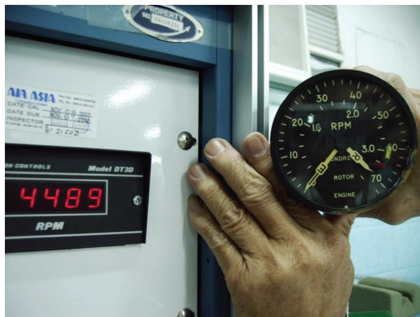
圖 1.16-9 主旋翼轉速指示功能檢測
