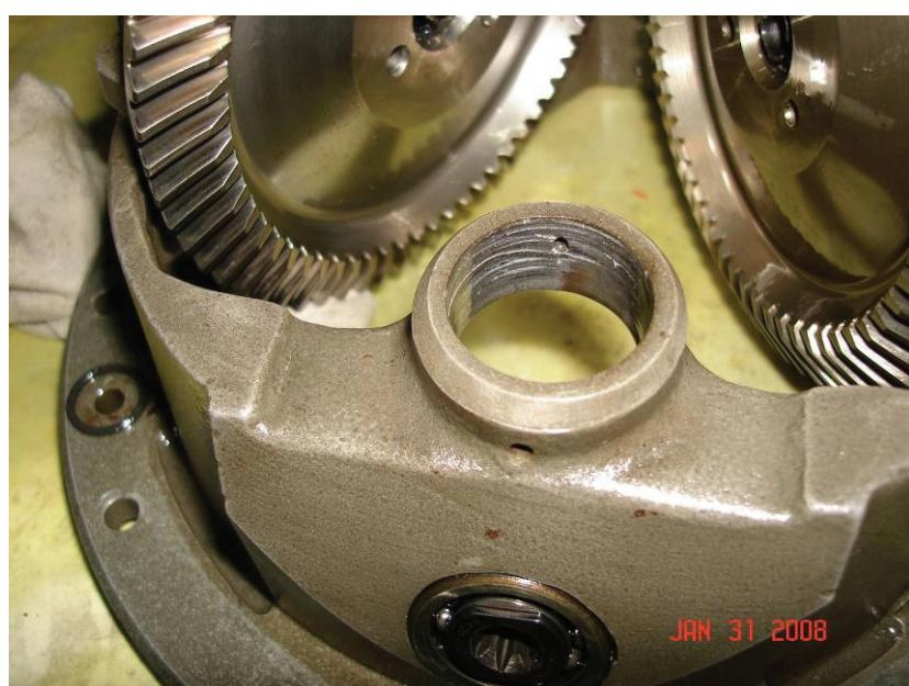
圖 1.16-20 軸承室內壁壓印痕跡
