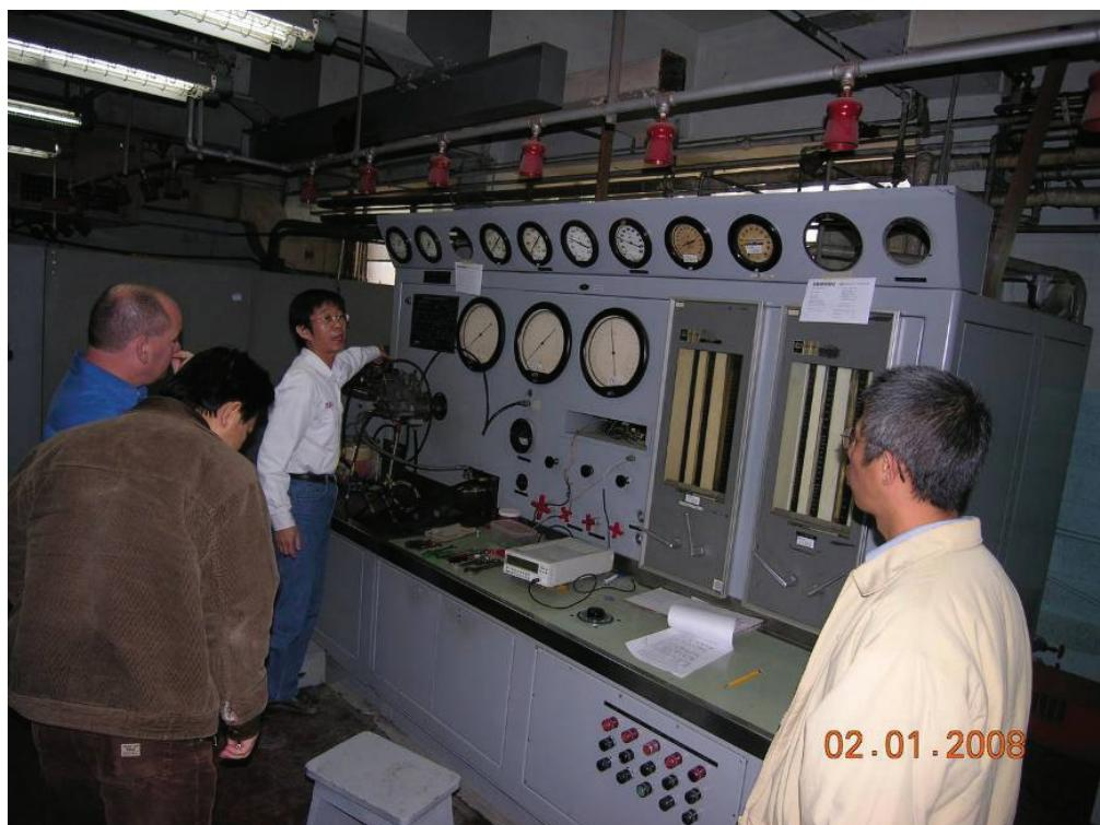
圖 1.16-1 發動機燃油控制器及超速調速器功能測試
