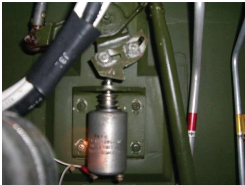
圖 1.16-6 測試時油門推桿可調至關停位置
