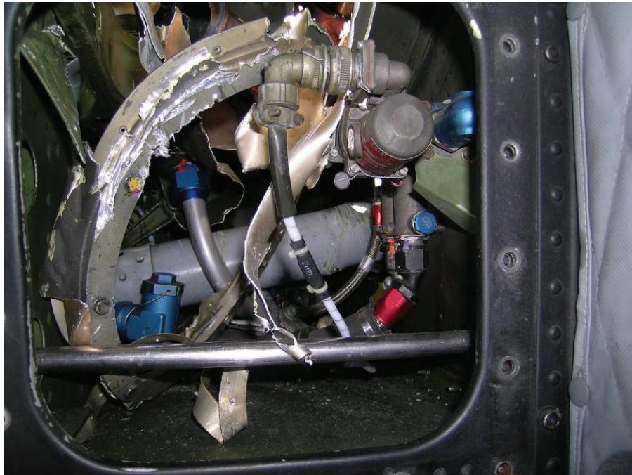
圖 1.16-2 燃油關斷瓣電線遭附近斷裂結構割斷
