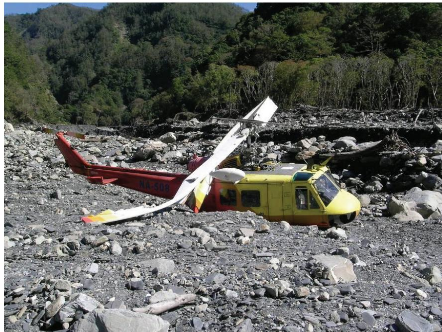
圖 1.12-1 直升機主旋翼斷折
