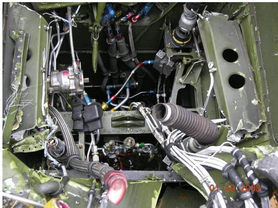
圖 1.12-5 傳動齒輪箱鄰近管路、電線及基座結構損害
