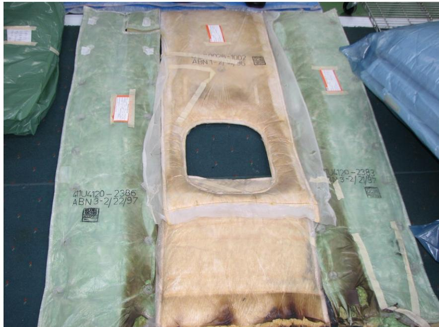
圖 1.12-4 側牆板隔熱毯底端至中段煙燻及變色
