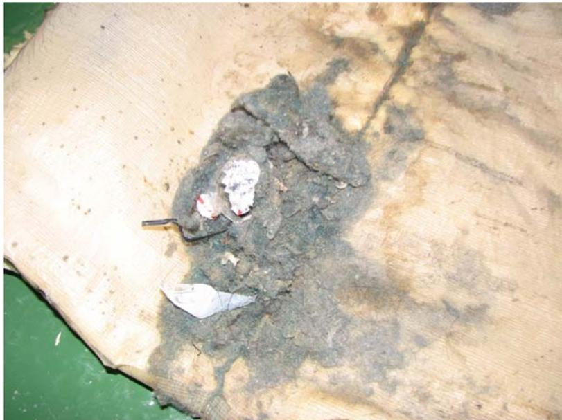
圖 1.12-12 部份焚毀隔熱毯殘塊灰塵、污漬及客艙異物堆積狀況
