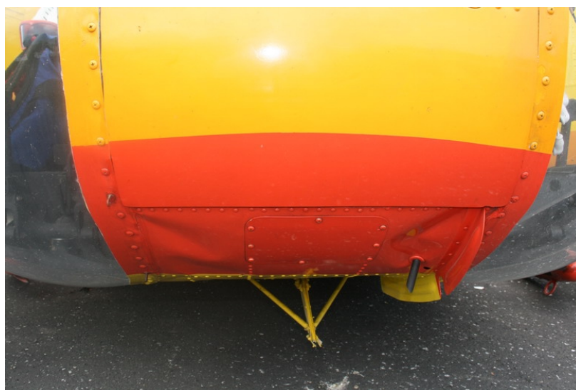
圖 1.12-4 電瓶艙下方鋁合金蒙皮損傷
