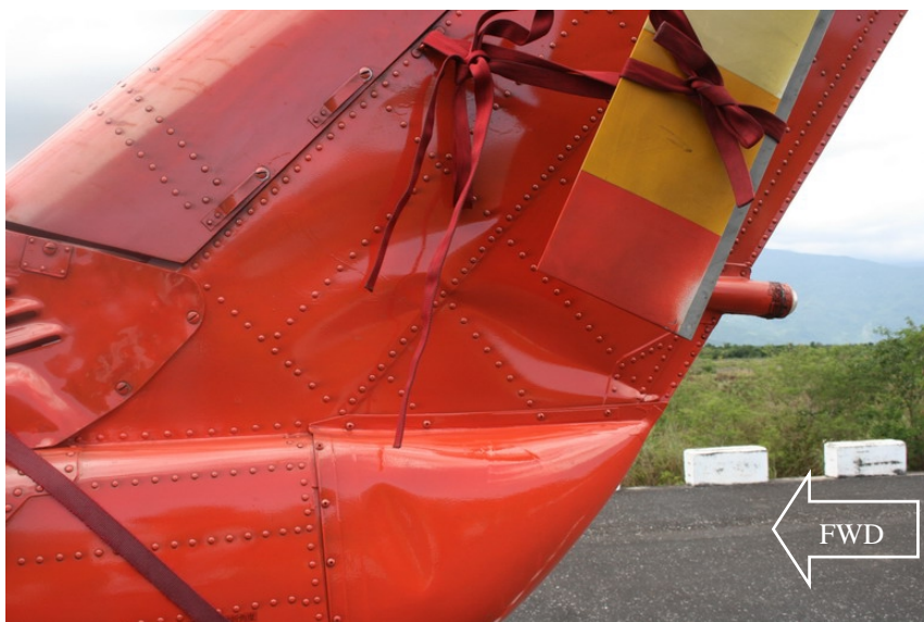
圖 1.12-15 垂直安定面左側蒙皮皺摺變形
