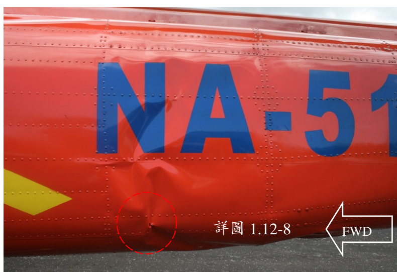
圖 1.12-7 尾桁左側 B 區之蒙皮皺摺變形
