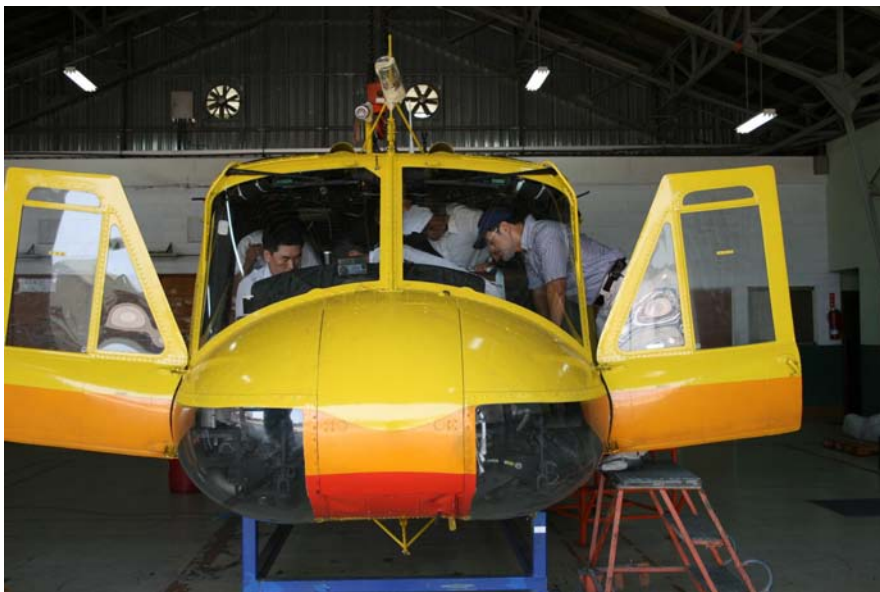
圖 1.16-6 油門桿控制調整之檢查
