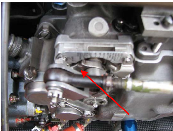
圖 1.16-2 油門流量指示關斷位置 (箭指處)
