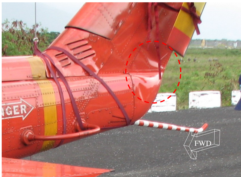
圖 1.12-9 壓縮挫曲型態之尾椎罩蒙皮皺摺變形
