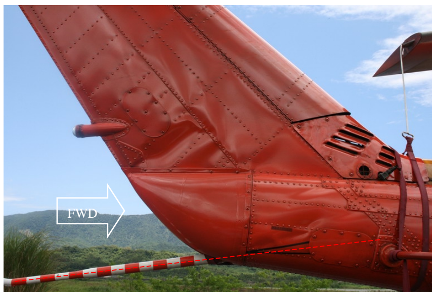
圖 1.12-16 垂直安定面右側蒙皮皺摺變形
