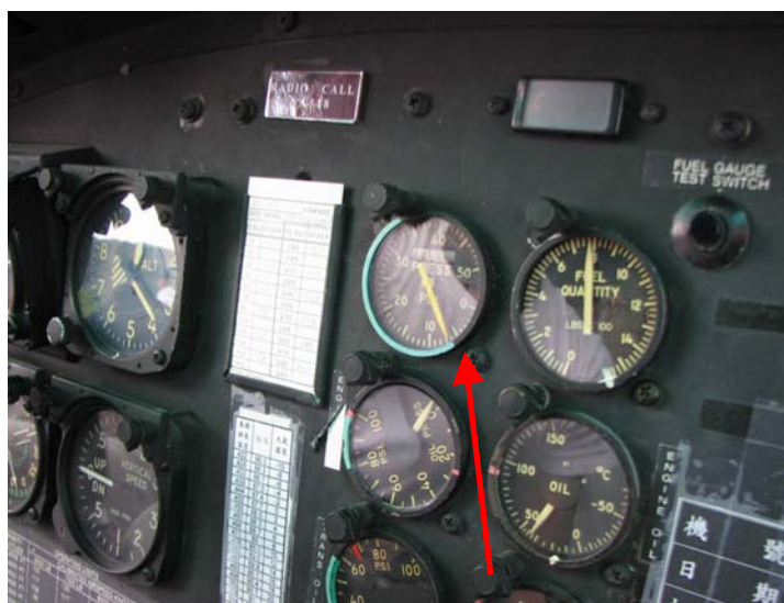
圖 1.16-3 燃油增壓泵壓力指示於正常綠線範圍內 (箭指處)
