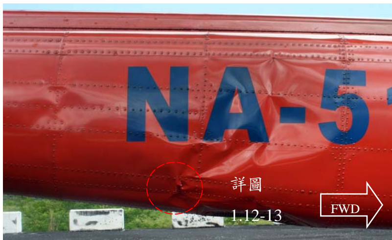
圖 1.12-12 尾桁右側 E 區之蒙皮皺摺及變形
