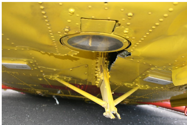
圖 1.12-2 機鼻下方蒙皮破裂 (後視圖)
