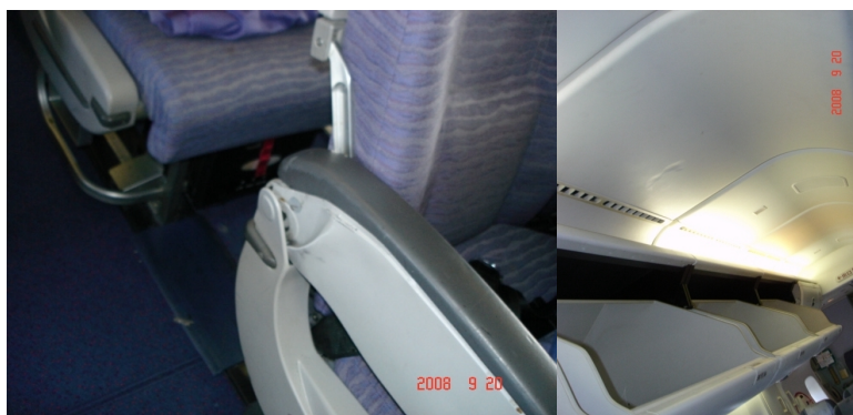
圖 1.12-3 57G 扶手彎折，53CD 上方天花板損害
