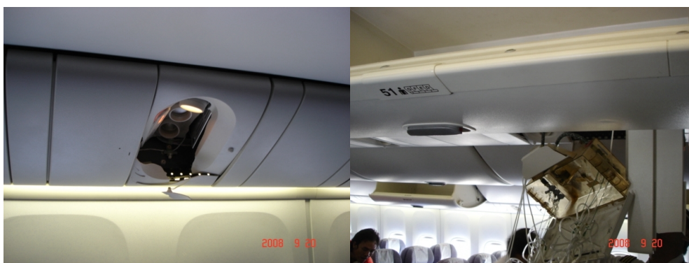
圖 1.12-2 42HJK 閱讀燈面板破損，51DEFG 氧氣及閱讀燈模組落下
