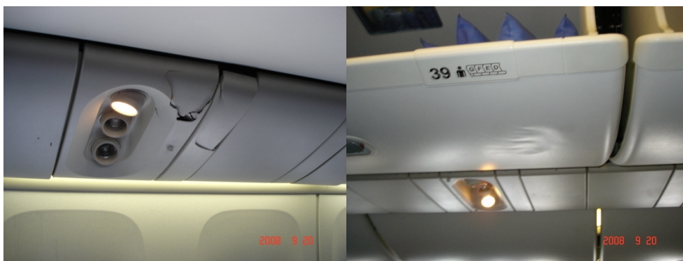
圖 1.12-1 31HJK 閱讀燈面板破損，39DEFG 置物箱表面凹陷
