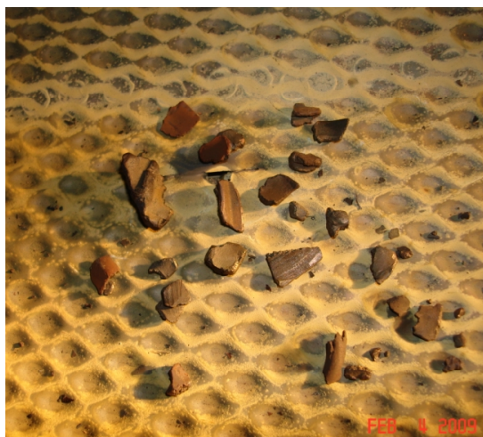
圖 1.12-1 1 號發動機尾管內發現之金屬碎片
