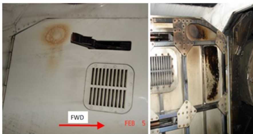
圖 2.3-3 416AR 面板外部（左圖）及內部（右圖）高溫變色情形
