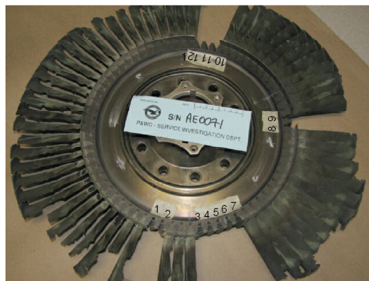
圖 1.16-9 PT2 轉子及編號 B1 至 B9 受損葉片
