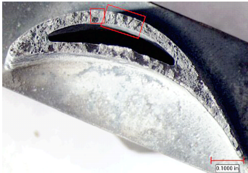
圖 1.16-13 PT1 編號 A2 葉片斷裂面
