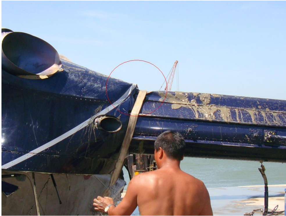
圖 1.12-18 傳動軸整流罩前端壓毀變形
