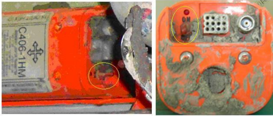
圖 1.16-3 傳送器本體控制開關設定位置
