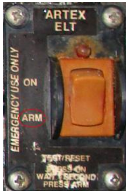
圖 1.16-2 駕駛艙內 ELT 控制開關設定位置
