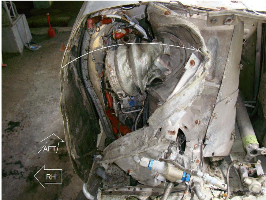
圖 1.12-10 (f) 右發動機前方防火牆損壞
