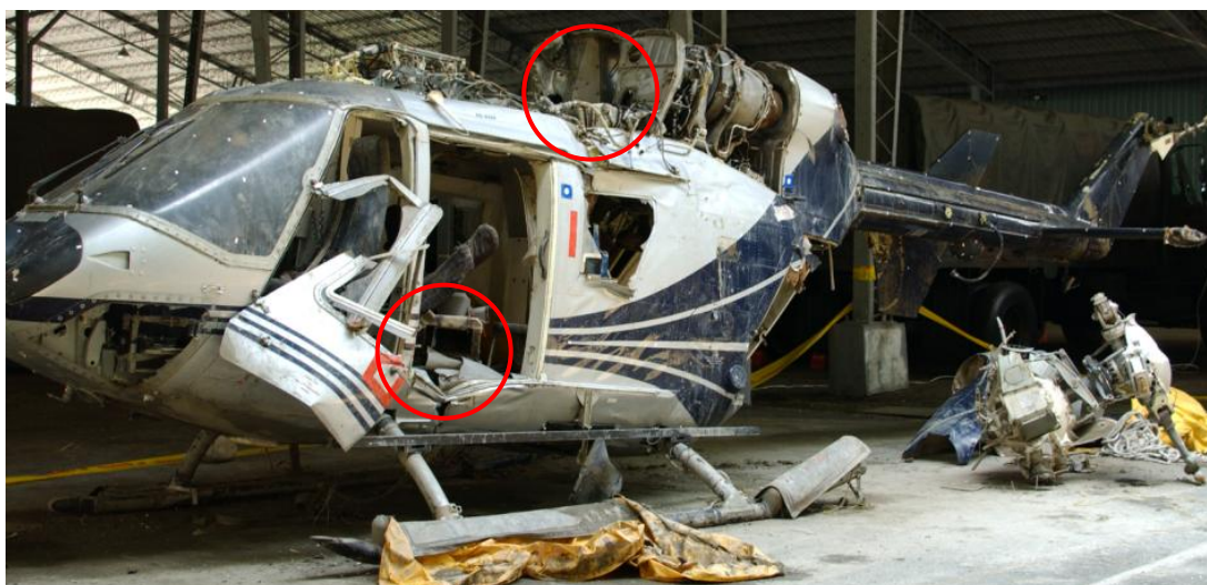
圖 1.18-7 圓圈所示為吊掛過程造成之傷害
