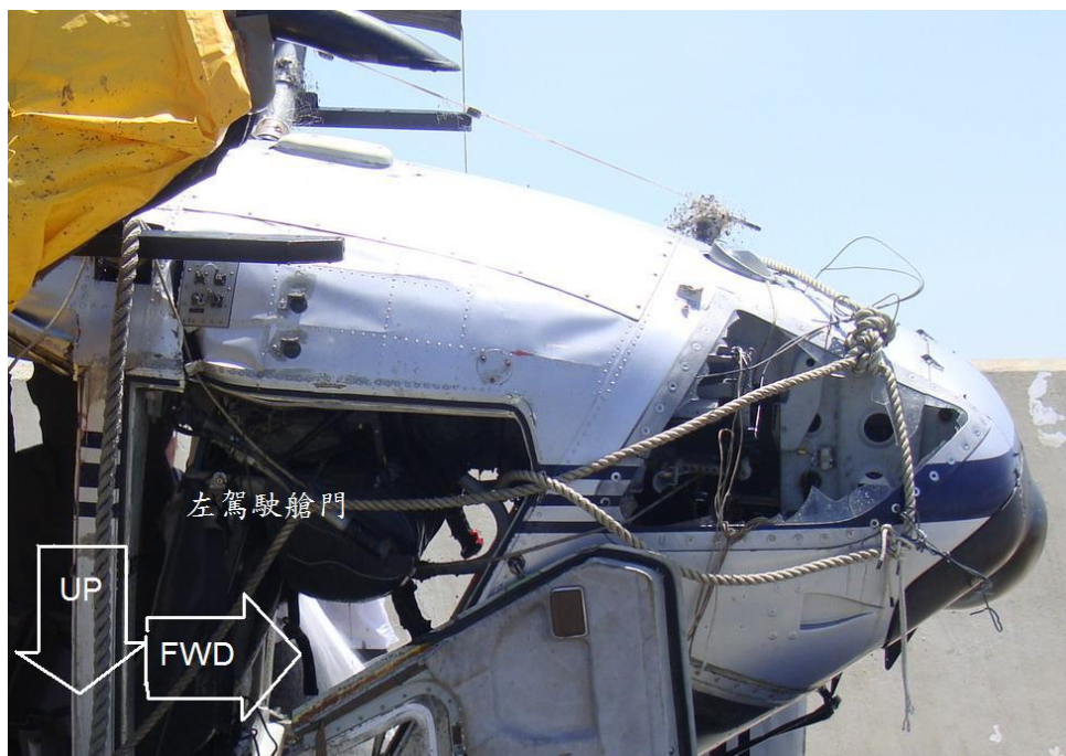
圖 1.12-10 (e) 左駕駛艙門以下機腹側蒙皮損壞
