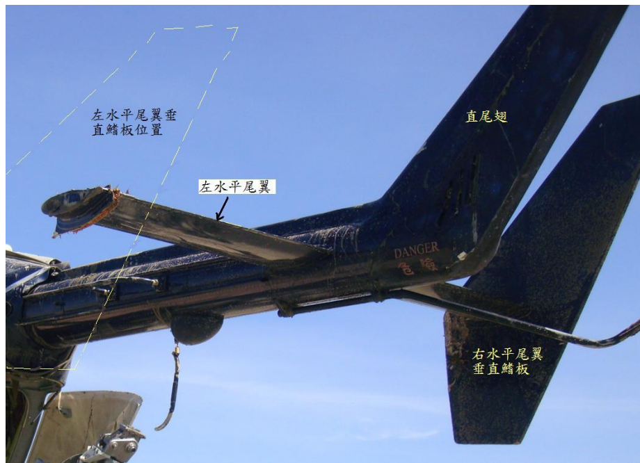
圖 1.12-15 左水平尾翼垂直鰭板由基座斷裂脫落
