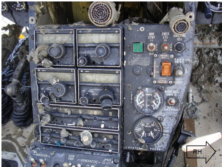
圖 1.12-20 導航無線電開關旋鈕彎折脫落
