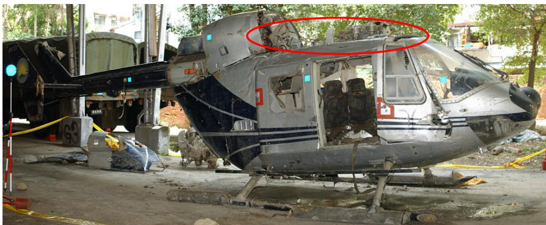
圖 1.18-6 主旋翼及主傳動箱已分離
