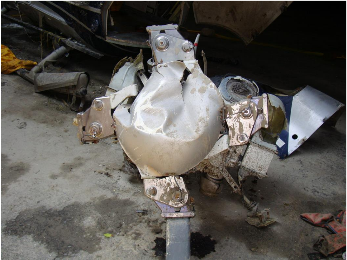
圖 1.12-6 主旋翼頭上蓋凹陷破裂
