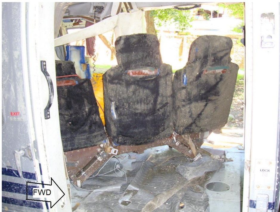
圖 1.12-12 三人式客艙座椅自地板脫落位移
