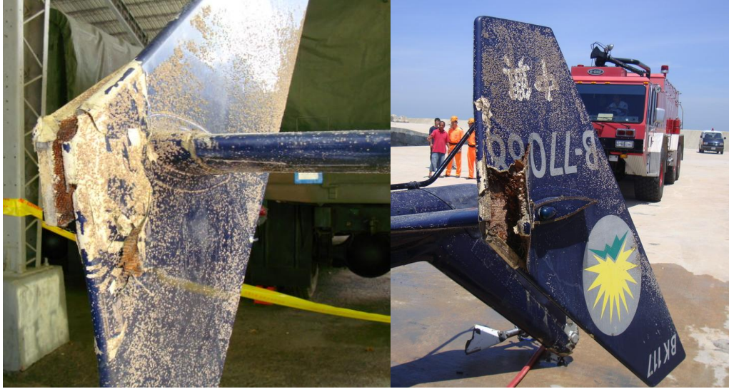
圖 1.12-16 右水平尾翼之垂直鰭板內側與外側損傷
