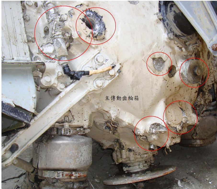
圖 1.12-19 主傳動箱外表鏽蝕情形
