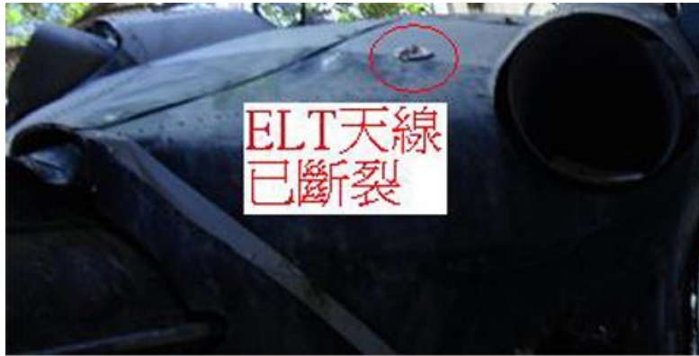
圖 1.16-5 ELT 天線斷落
