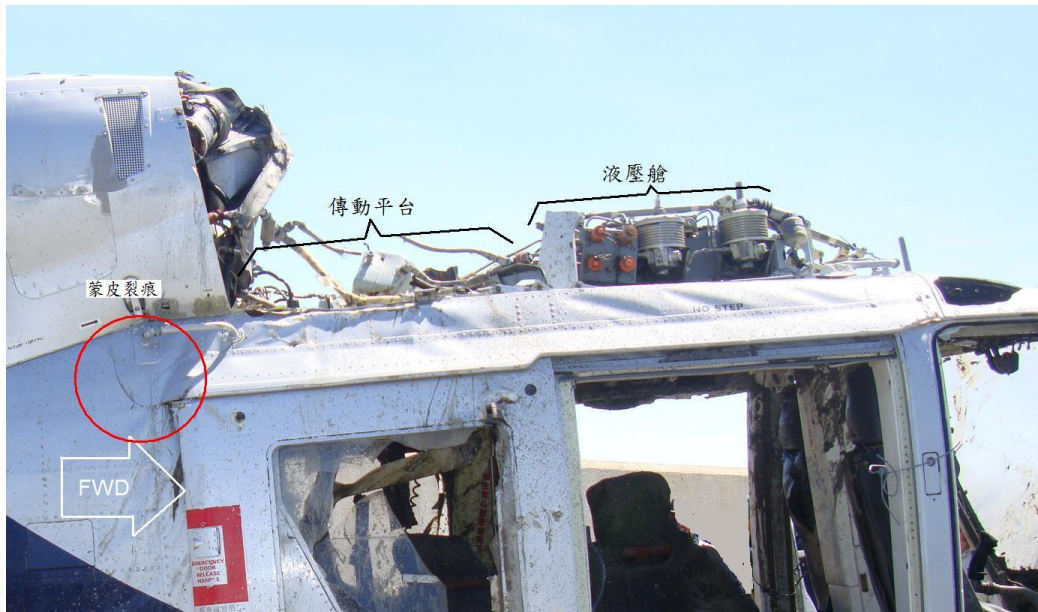
圖 1.12-10 (d) 液壓艙下方之左右機身蒙皮損壞
