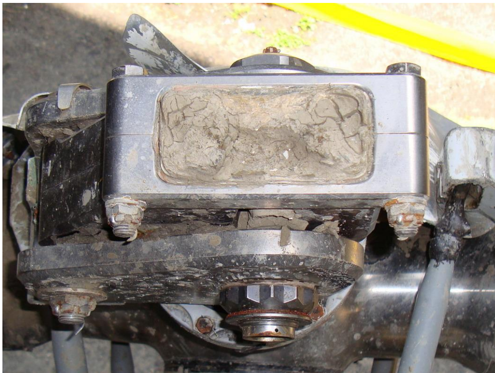
圖 1.12-4 (f) 主傳動箱右側扭力支柱破壞情形
