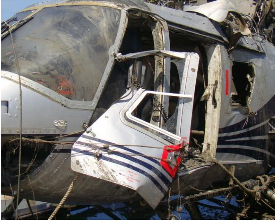
圖 1.12-10 (i) 駕駛艙左艙門框損壞
