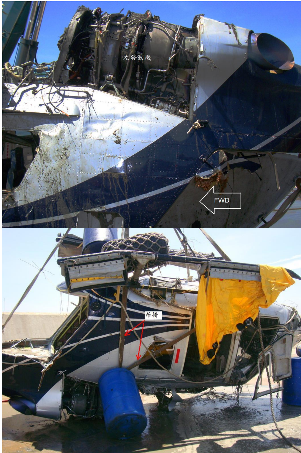
圖 1.12-10 (c) 引擎下方左右機身蒙皮損壞
