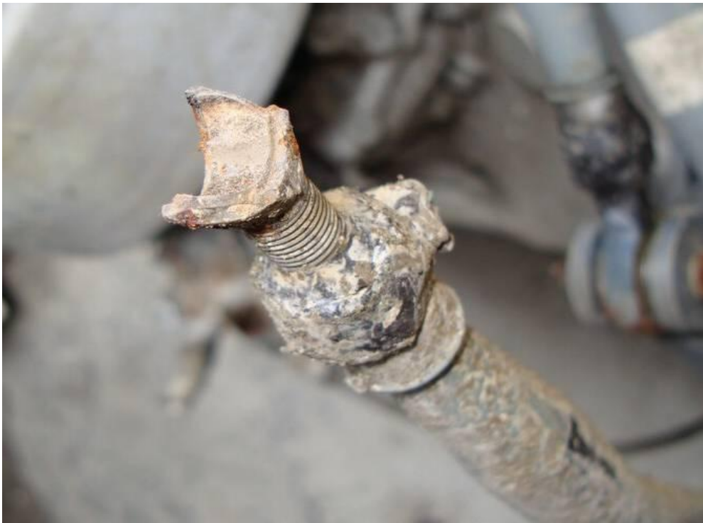
圖 1.12-8 致動連桿斷落處肘節環
