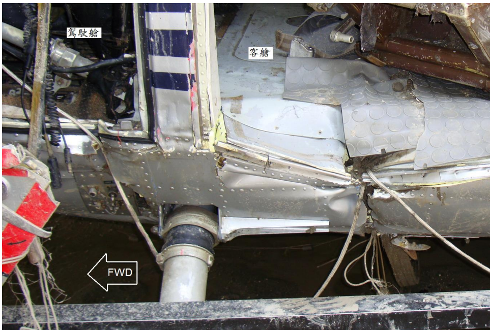
圖 1.12-10 (b) 左駕駛艙門框底部與客艙門框底部結構
