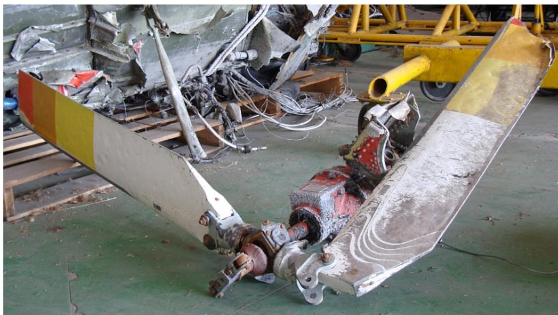
圖 1.12-18 尾旋翼殘骸
