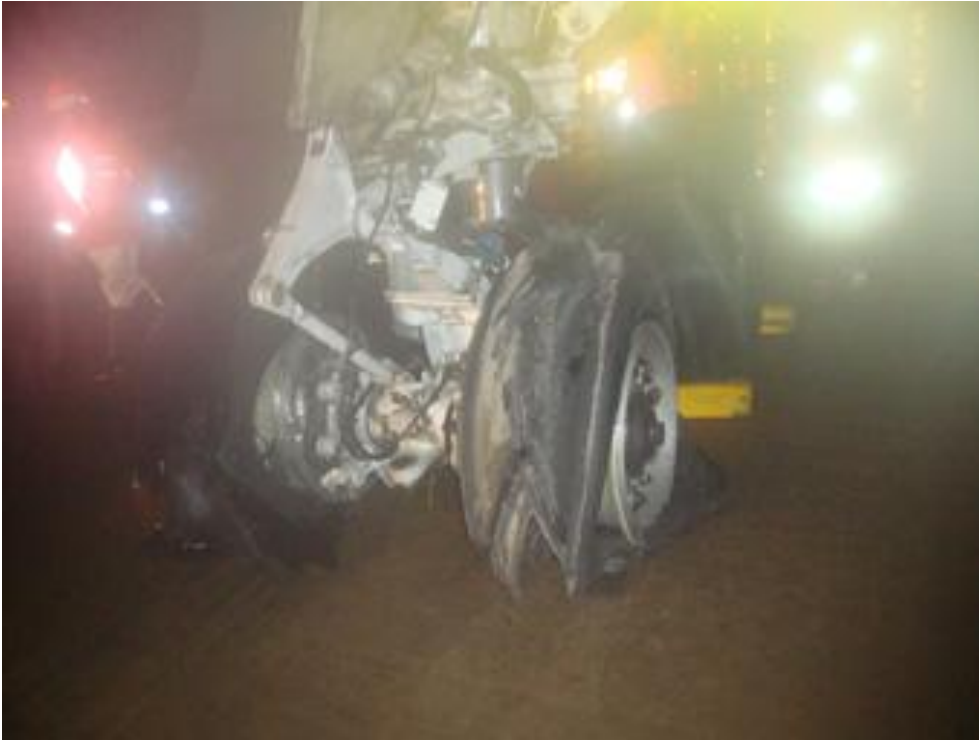
圖 1.12-7 破損之左機翼起落架輪胎
