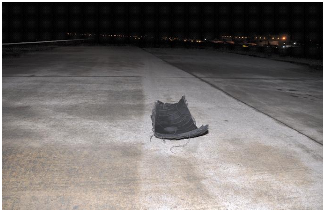
圖 1.12-11 道面遺留之破裂輪胎碎片(距 24 跑道端 7,185 呎)
