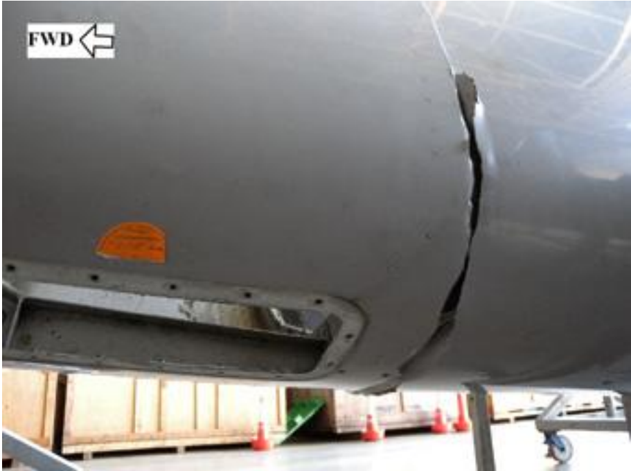
圖 1.12-5 3 號襟翼滑軌整流罩損傷
