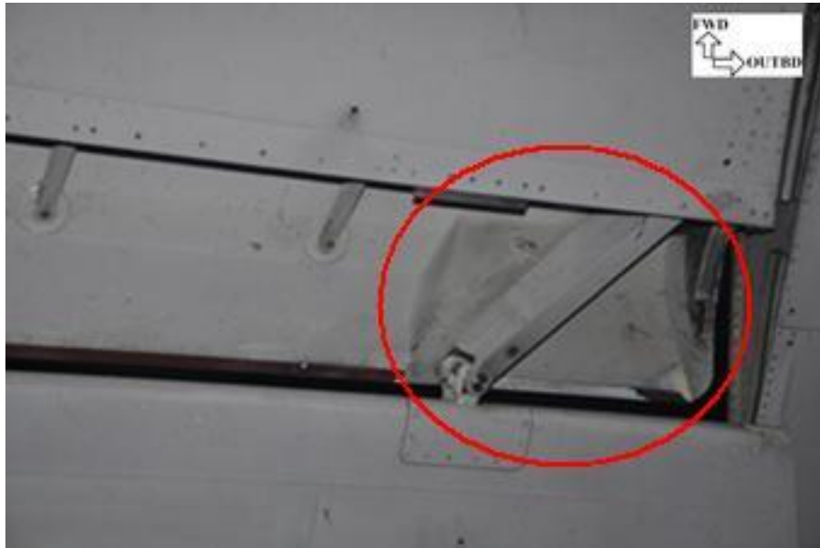
圖 1.12-2 變形之左翼內側前襟翼（仰視）
