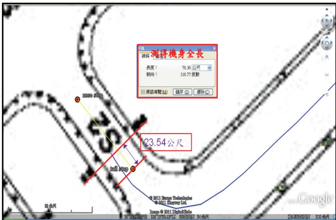
圖 1.12-23 該機停止時尚未完全脫離跑道區域
