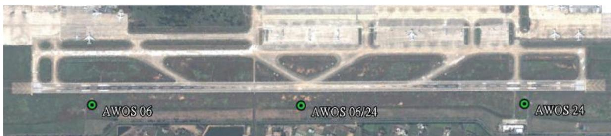
圖 1.7-3 06/24 跑道之地面自動氣象觀測系統位置
