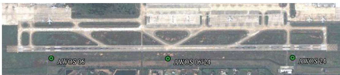
圖 1.7-3 06/24 跑道之地面自動氣象觀測系統位置圖
