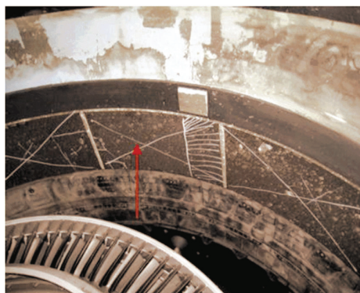
圖 1.12-16 隔音板損害情形 (2)
