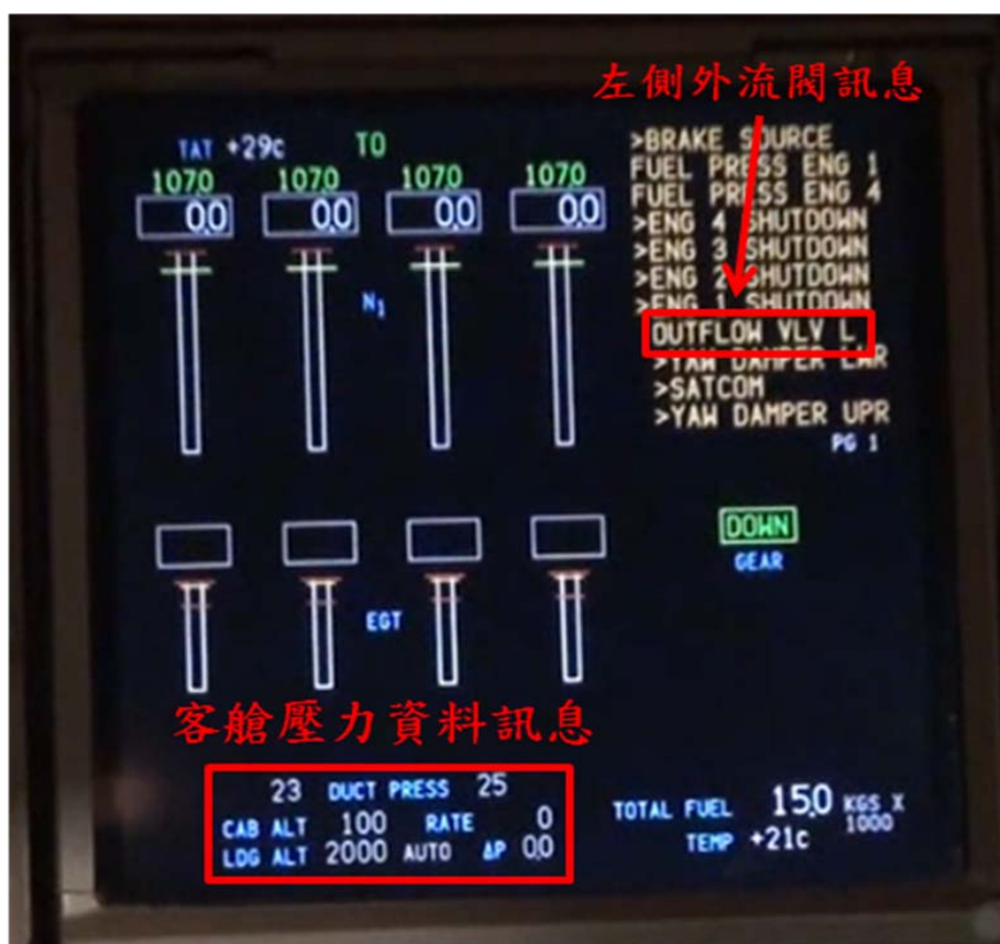
圖 1.16-1 外流閥訊息及客艙壓力資料測試
