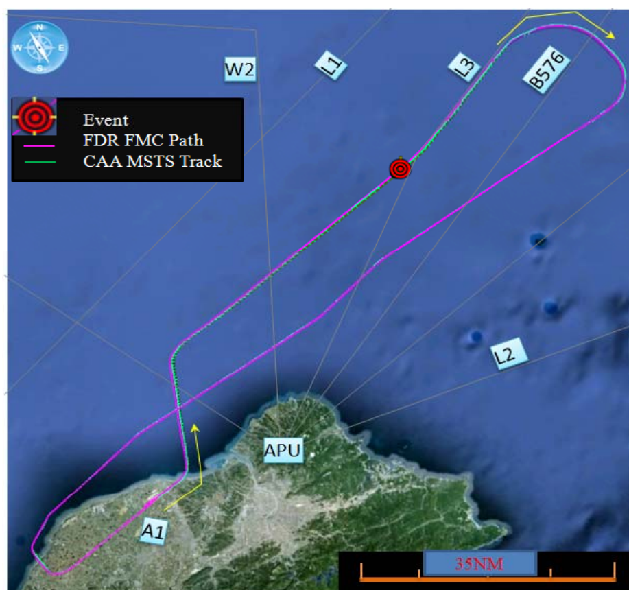
圖 1.11-5 BR702 班機之飛航軌跡與 MSTS 航跡套疊圖
