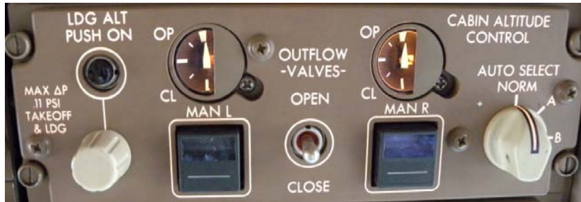
圖 1.6-1 艙壓控制系統選擇面板
