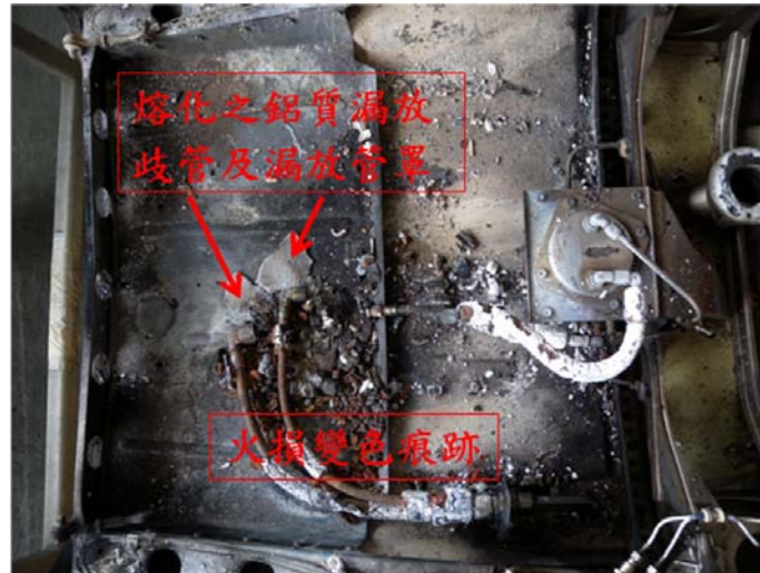
圖 1.14-4 進氣口後段底部整流罩結構火損
