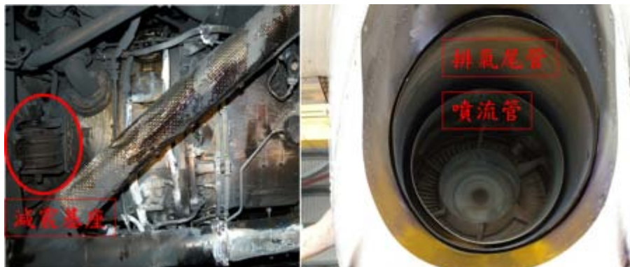
圖 1.14-2 發動機減震基座、排氣尾管及噴流管遭受熱損
