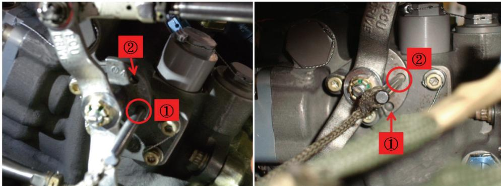
圖 1.16-1 燃油控制器調校插孔位置圖
