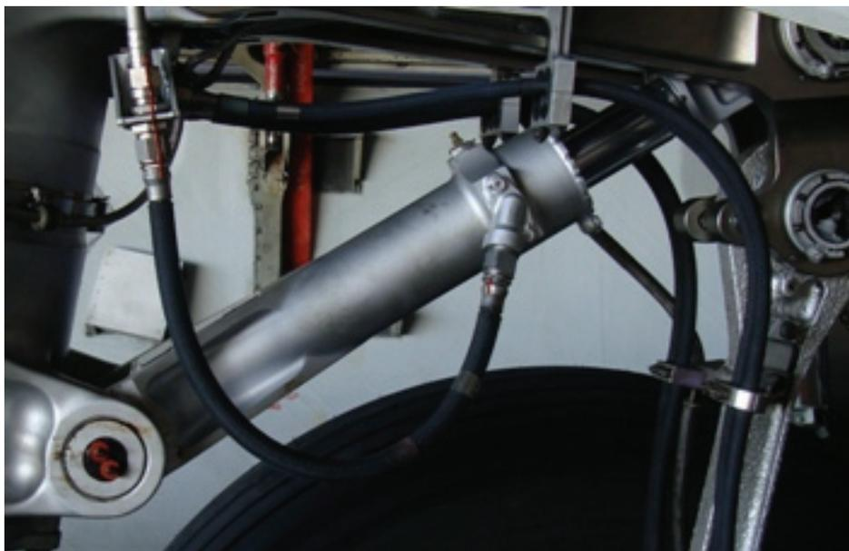
圖 1.12-8 右主輪起落架傾角唧筒液壓油漏洩
