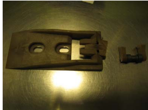
圖 1.12-2 4L 機內通話手機座破損
