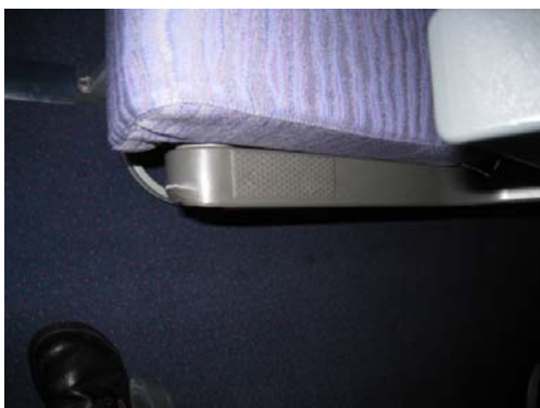
圖 1.12-5 59D 座椅骨架裂痕
