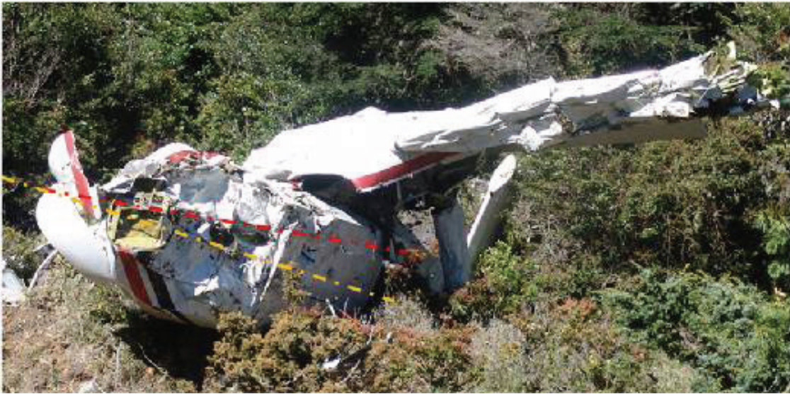
圖 2.7-3 鼻輪起落架彎折變形情形
