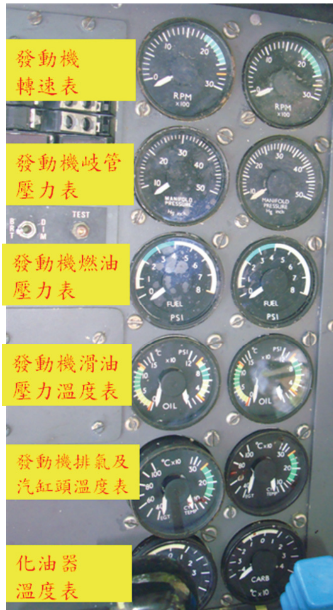
圖 1.12-26 發動機相關儀表指針指示位置
