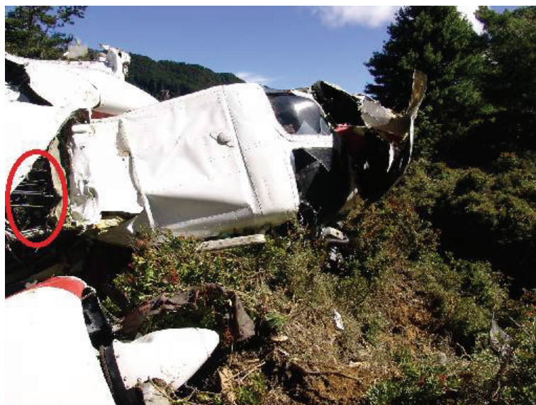
圖 2.5-1 機翼與機身脫離呈歪斜狀態
