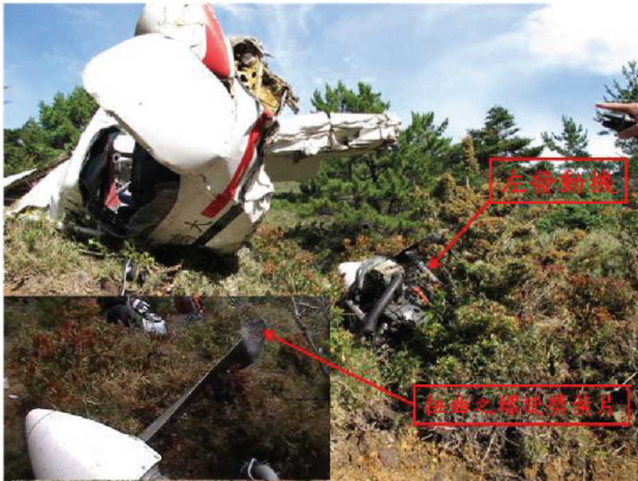
圖 1.12-16 左發動機與機身主殘骸相對位置圖
