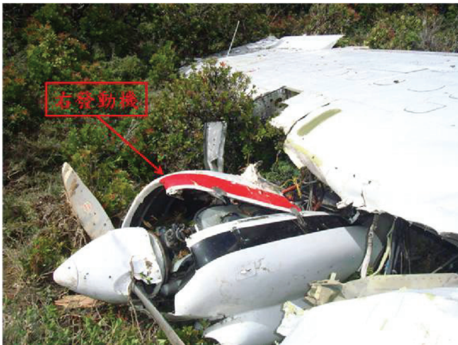
圖 1.12-17 右發動機與右機翼相對位置圖
