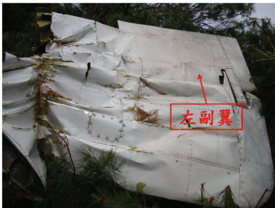
圖 1.12-20 遺留於編號 1 撞擊區之左副翼與外側段左翼
