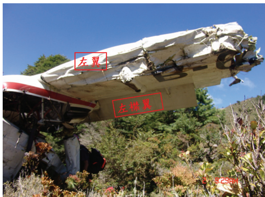
圖 1.12-21 左副翼斷落左襟翼於伸展位置
