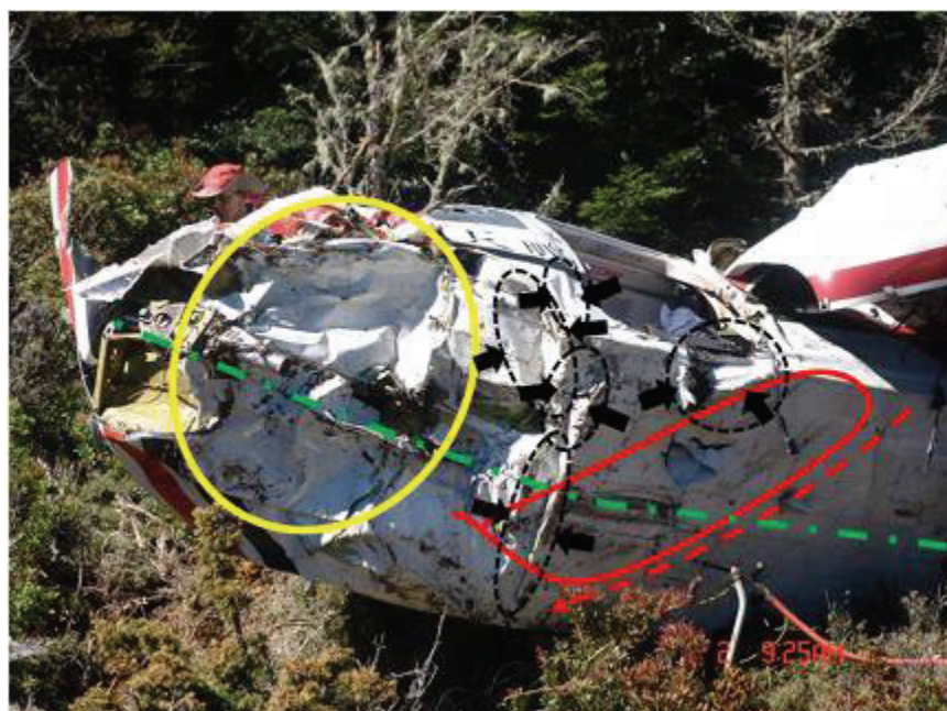
圖 2.7-4 飛機墜地後之結構損害及姿態分析圖
