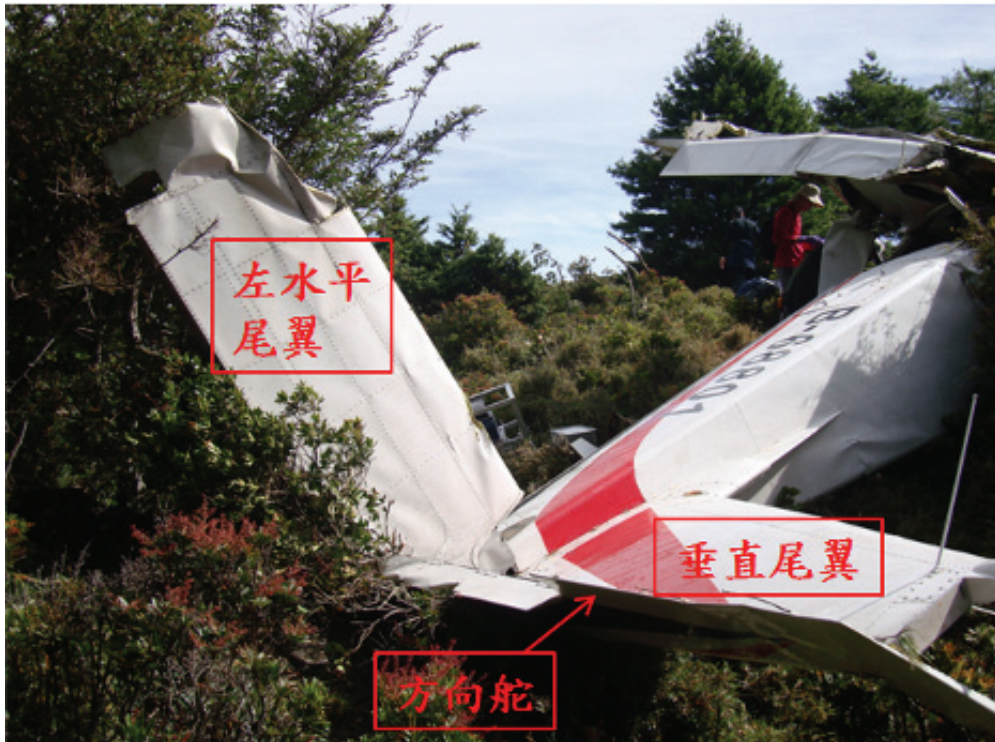
圖 1.12-22 垂直尾翼及左水平尾翼斷落情形
