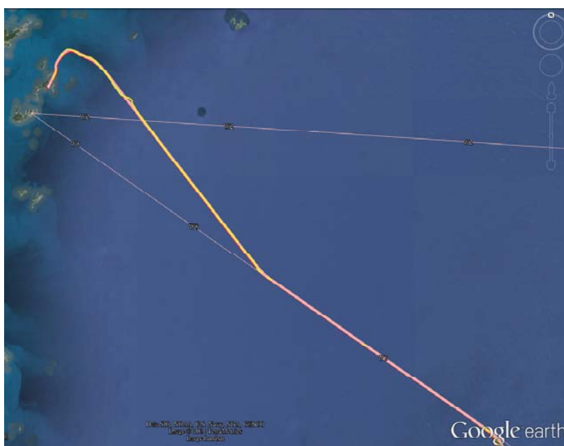
圖 1.11-5 落地前飛航軌跡與雷達軌跡套疊圖
