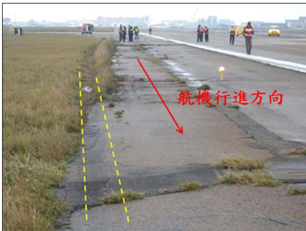
圖 1.12-5 右側主輪返回跑道鋪面之胎痕
