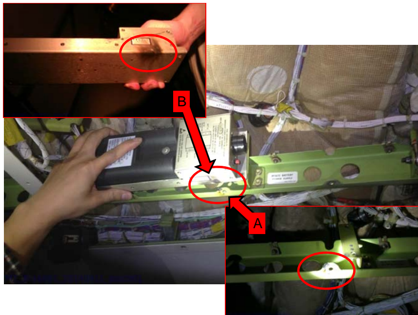
圖 1.1-3 固定樑 A 與電池座 B 熱損情形
