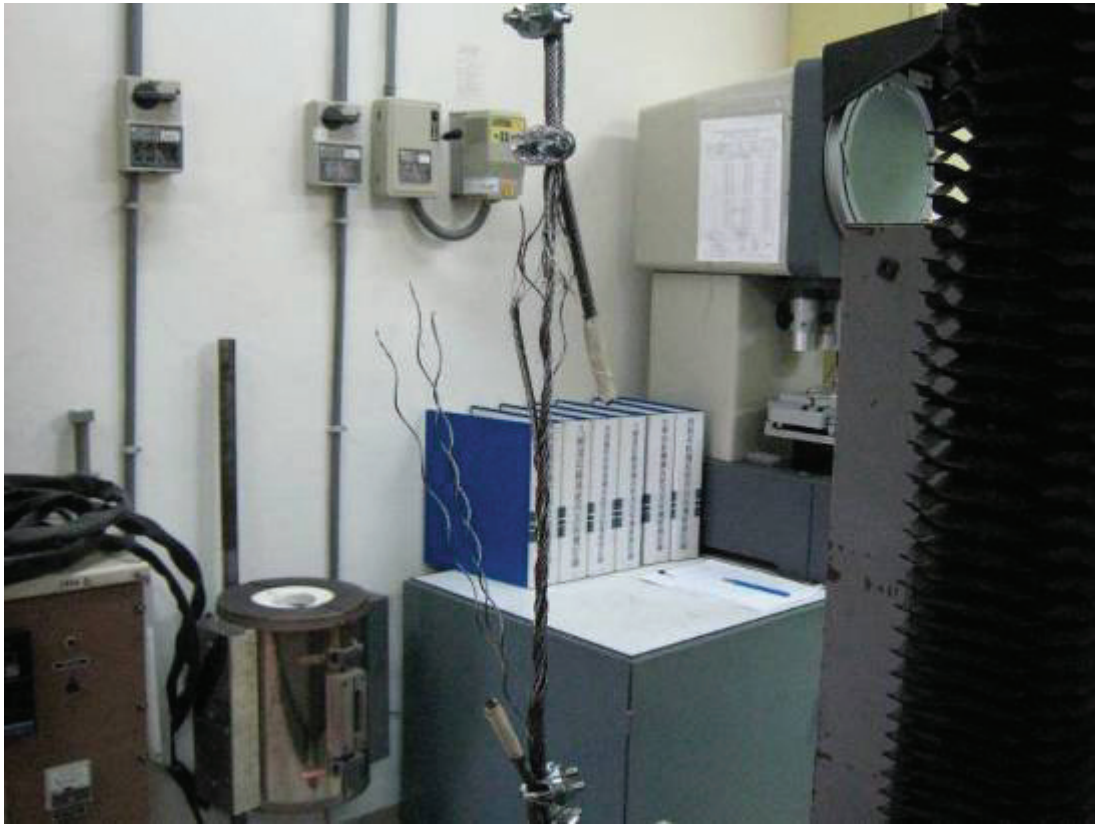
圖 1.16-7 抗拉試驗後鋼索破壞情形
