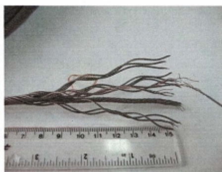
照片四、鋼纜的斷裂處外觀
