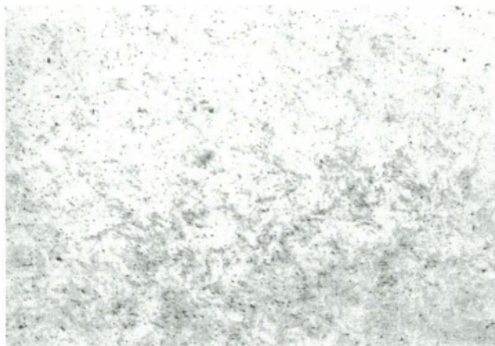
照片二十三、鋼線的橫截面金相，其中多個黑點為金相腐蝕時造成的孔蝕(pitting)現象 (Fry's reagent, x 1000)
