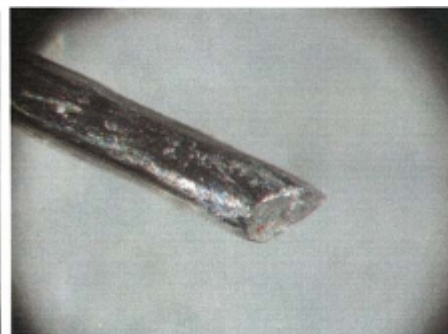
照片六、此支鋼線斷口呈剪破壞形態
