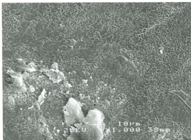
照片十、為照片九之鋼線斷面方框區域放大的形態，呈現混合拉、剪應力造成的凹窩形態
