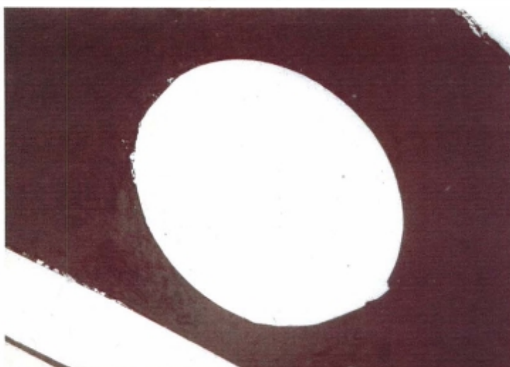
照片二十一、鋼纜試樣之鋼線的橫截面未腐蝕的金相 (OM, x200)
