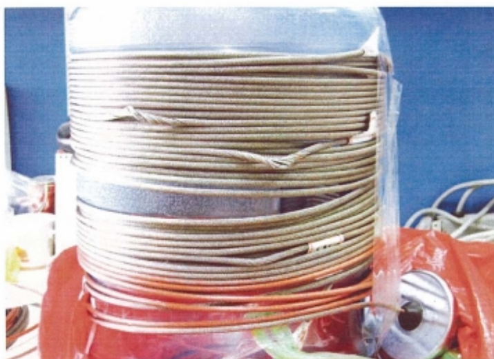
照片二十六、靠吊掛物端的鋼纜呈現扭曲形態，鋼纜的外部呈扭緊狀而心部擠出
