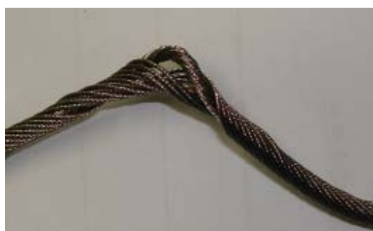
圖 1.16-9 Core Protrusion 損傷 (ID 8)
