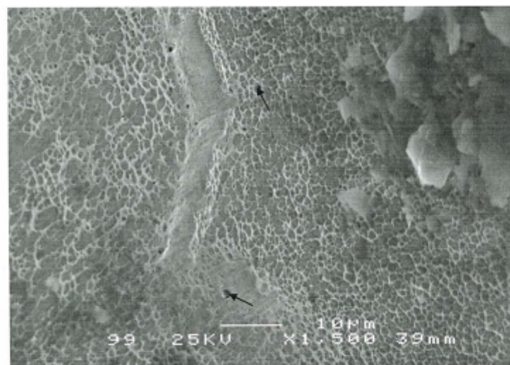
照片十二、#4 鋼線局部斷面的形態，呈現混合拉、剪應力造成的凹窩形態，箭頭處為孔洞
