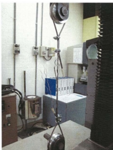
照片二十五、鋼纜拉伸試驗時於最大負荷斷裂後的破壞形態，心部七股鋼纜全斷
