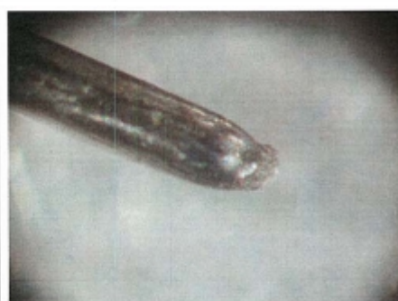
照片五、此支鋼線斷口呈頸縮現象
