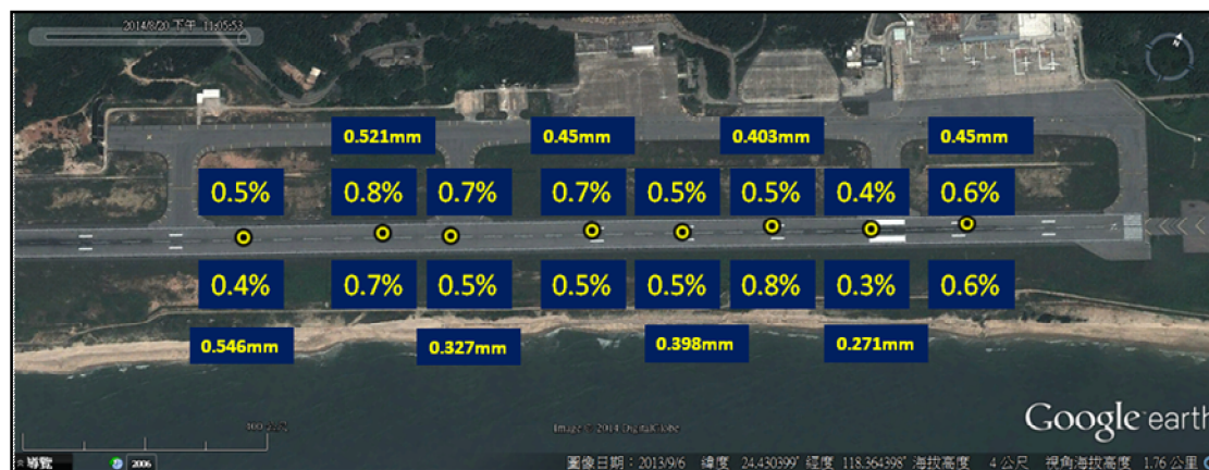
圖 1.10-3 06 跑道粗質紋理及橫坡度量測結果圖
