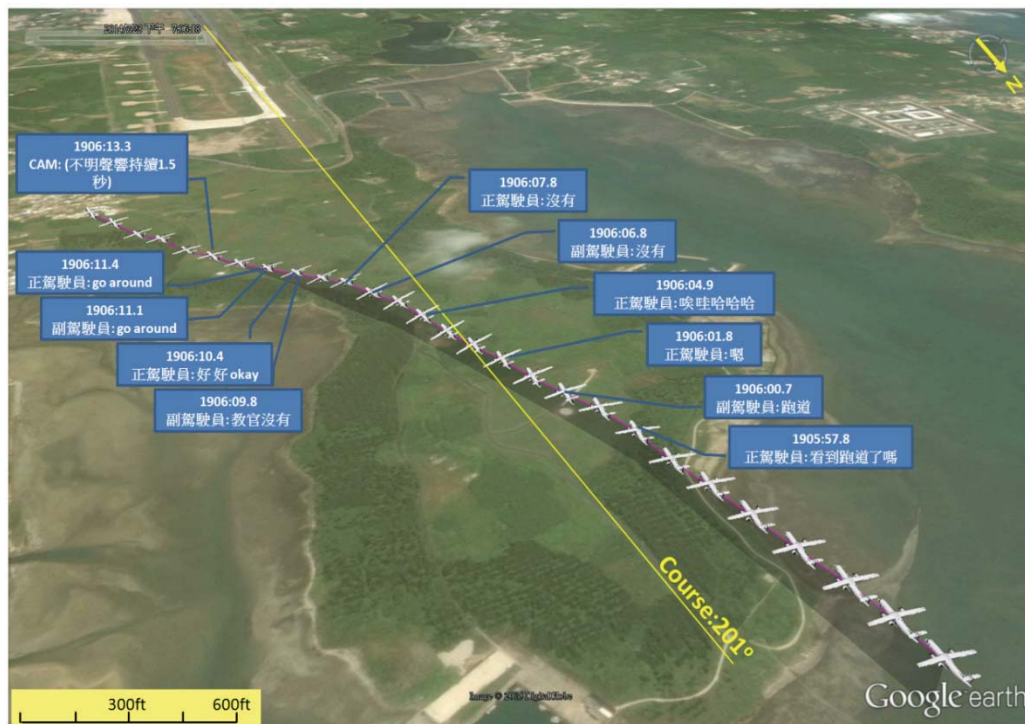
圖 2.2-2 飛航組員試圖目視尋找跑道期間航機高度與航向偏離
