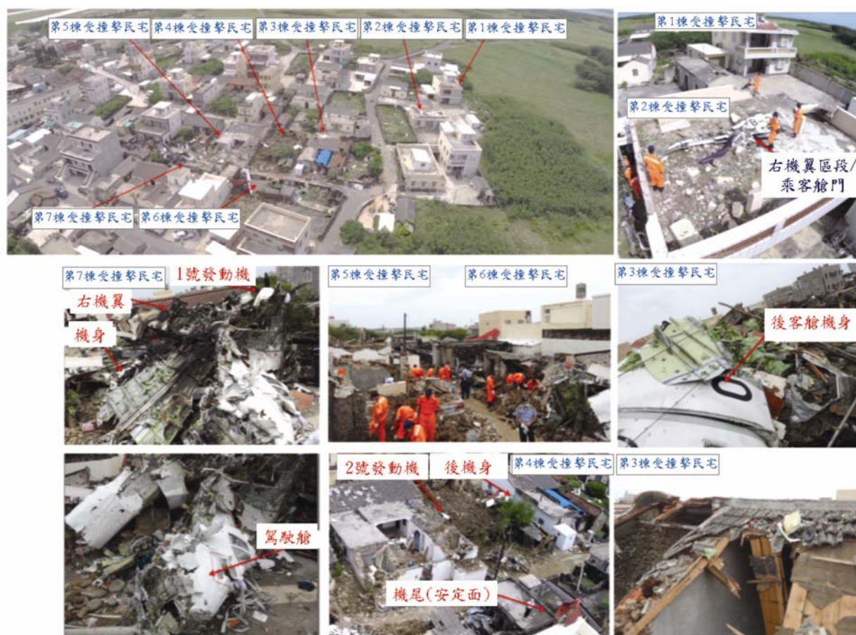
圖 1.12-8 事故航機主要殘骸及遭撞擊建築物照片
