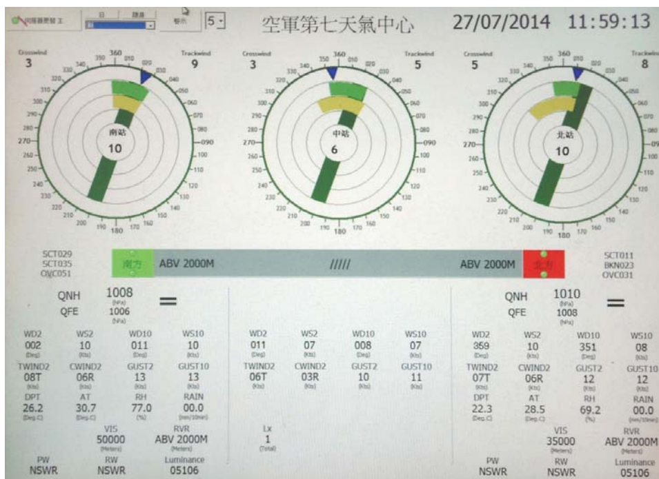
圖 1.7-2 天氣中心及塔臺 AWOS 螢幕顯示
