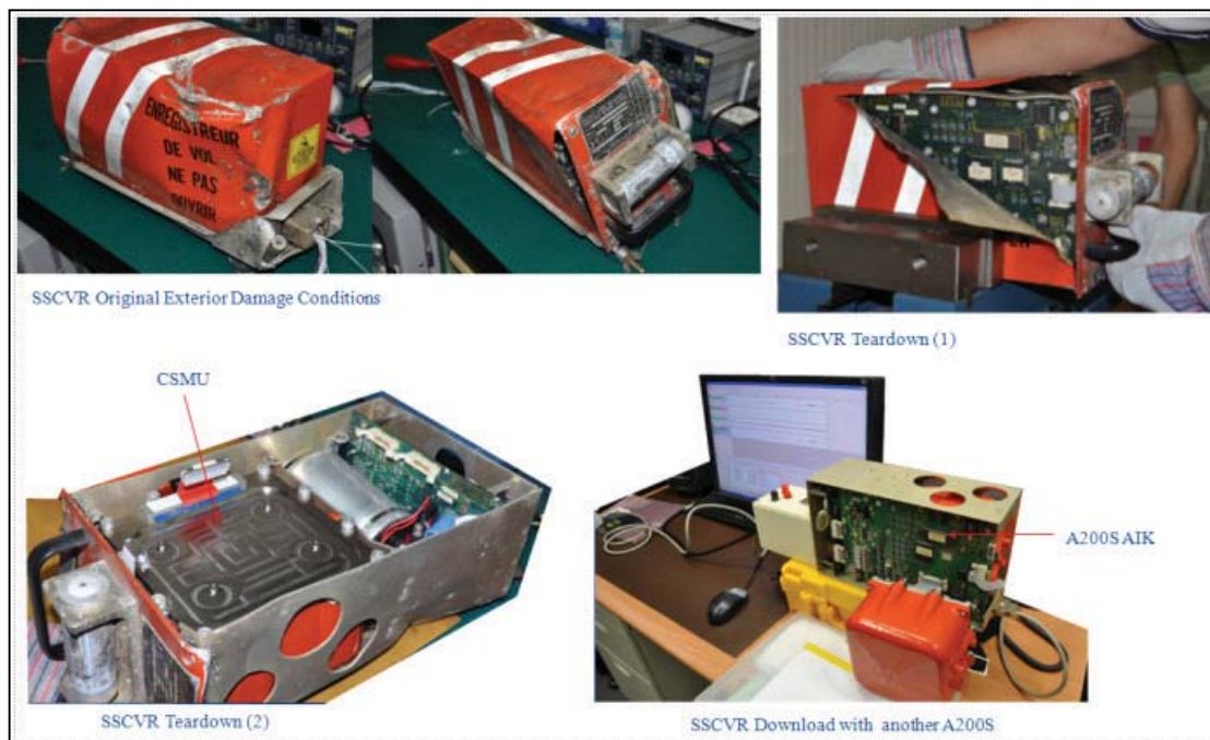
圖 1.11-1 (a)損壞 CVR 外觀與拆解作業 (b)依據 A200S AIK 進行資料下載
