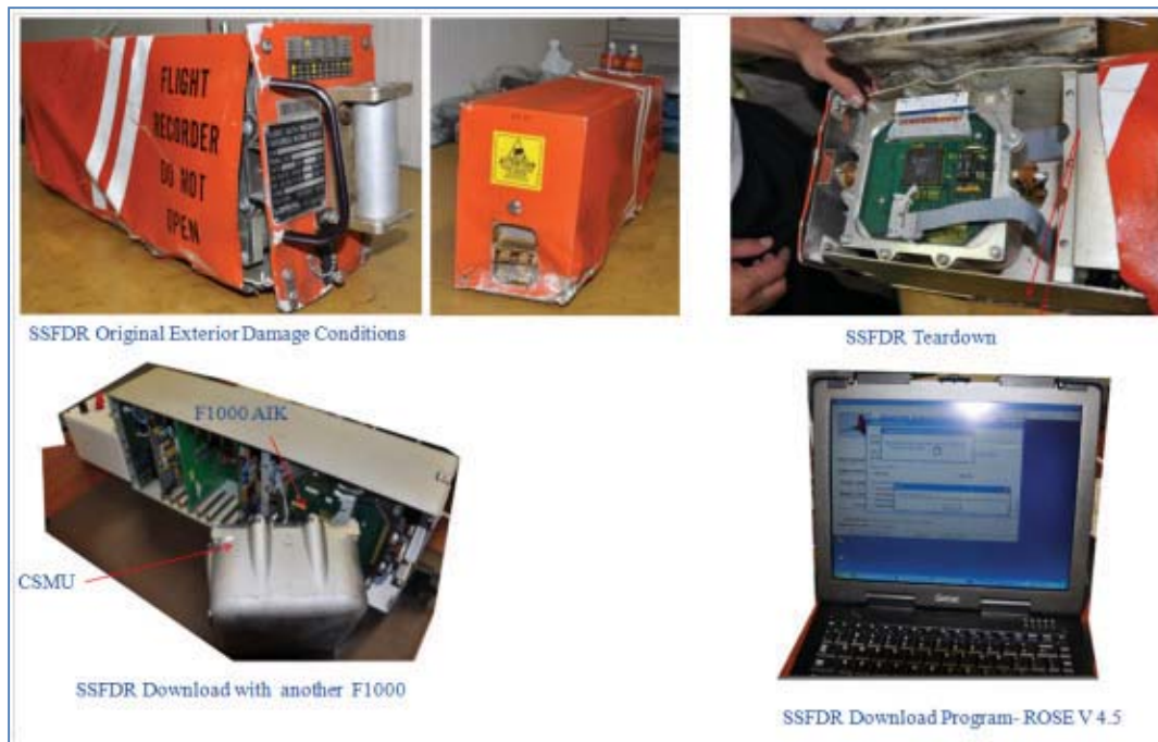
圖 1.11-2 損壞 FDR 外觀、拆解作業與資料下載
