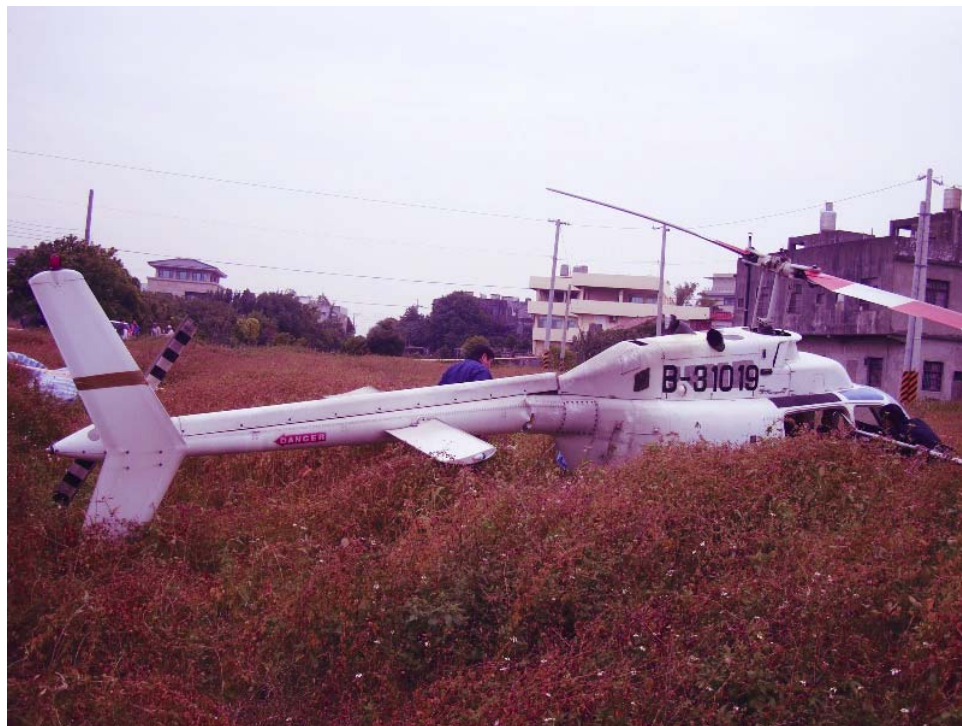
圖 1.12-2 右側尾桁蒙皮破裂、尾桁彎折
