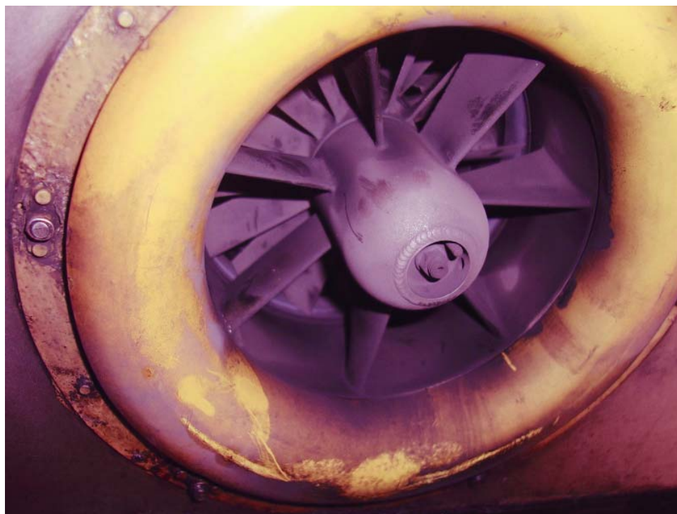
圖 1.16-3 發動機進氣口髒污情形
