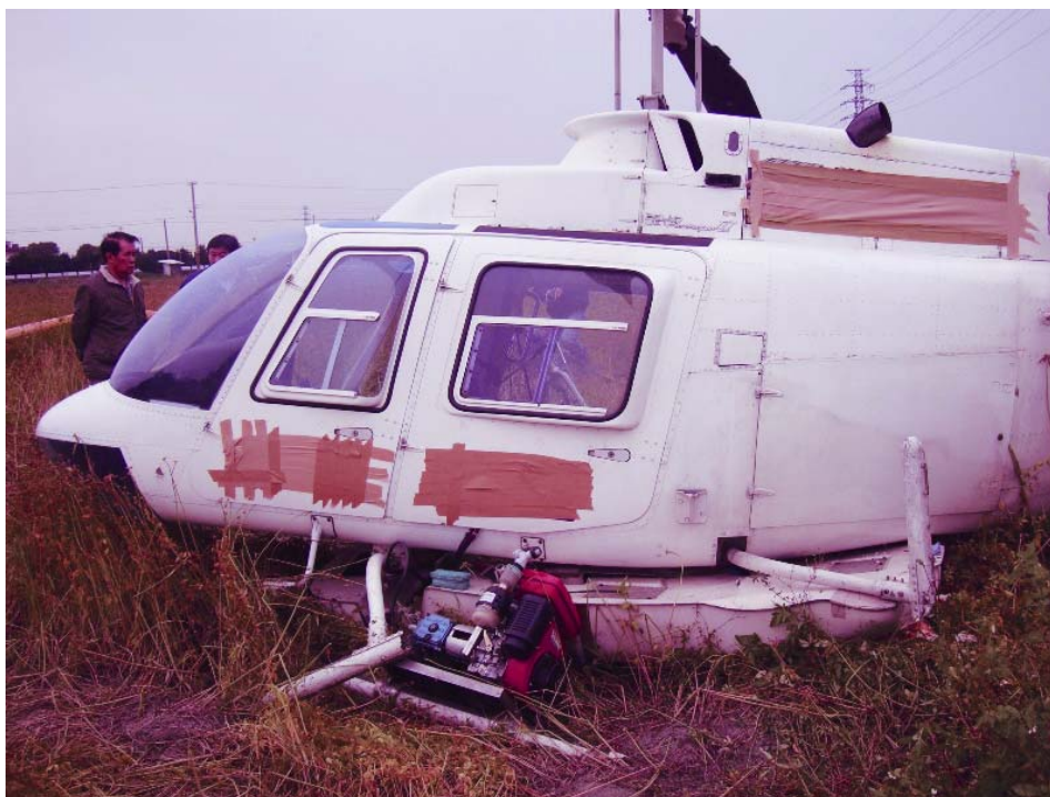
圖 1.12-3 左側起落架滑橈、水箱、水槍馬達損壞
