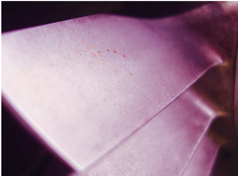
圖 1.16-33 B-31169 機發動機壓縮器轉子葉片腐蝕鏽斑
