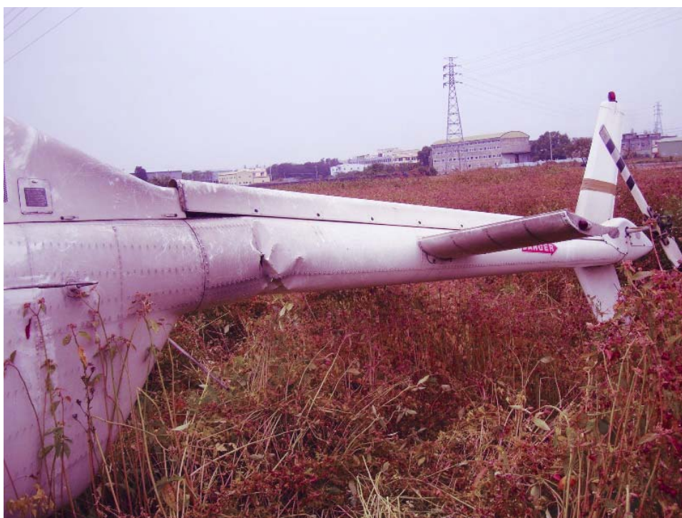
圖 1.12-4 左側尾桁蒙皮破裂、尾桁彎折
