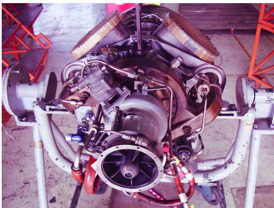
圖 1.16-8 發動機安裝於治具
