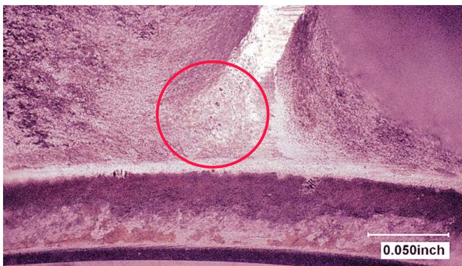
圖 1.16-16 腐蝕孔於第 4 級轉子葉片之圓角上
