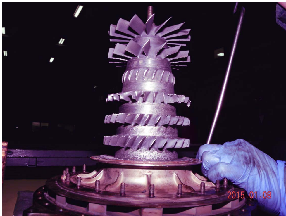
圖 1.16-11 轉子第 3 級葉片損壞情形
