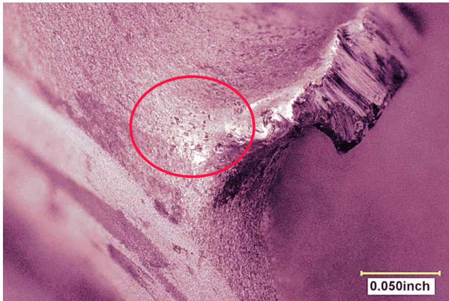
圖 1.16-14 腐蝕損害普遍存在葉片與輪轂的圓角表面
