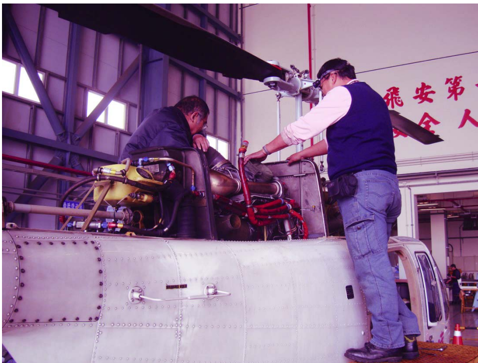
圖 1.18-1 凌天之發動機壓縮器檢查作業
