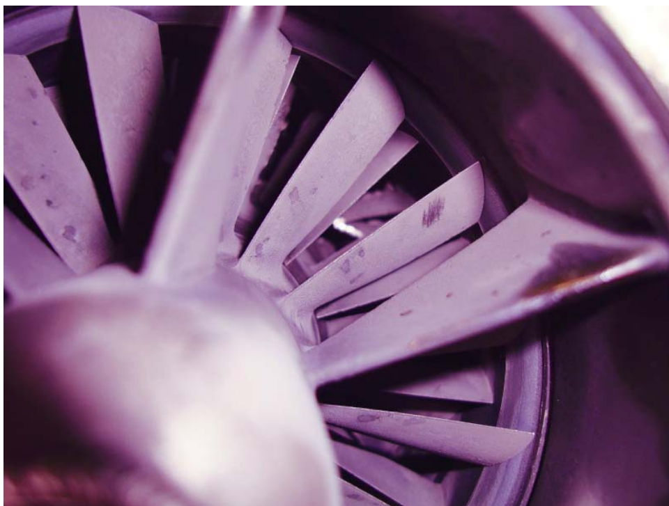
圖 1.16-9 壓縮器進氣口及第 1 級轉子葉片污染情形
