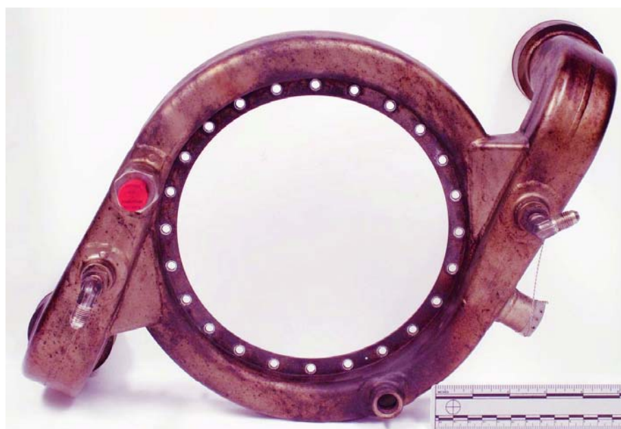
圖 1.16-20 壓縮器出口擴散器（後視圖）腐蝕情形
