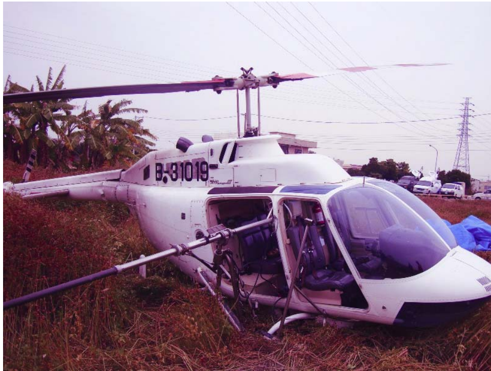
圖 1.12-1 航機右側起落架滑橇、水槍損壞
