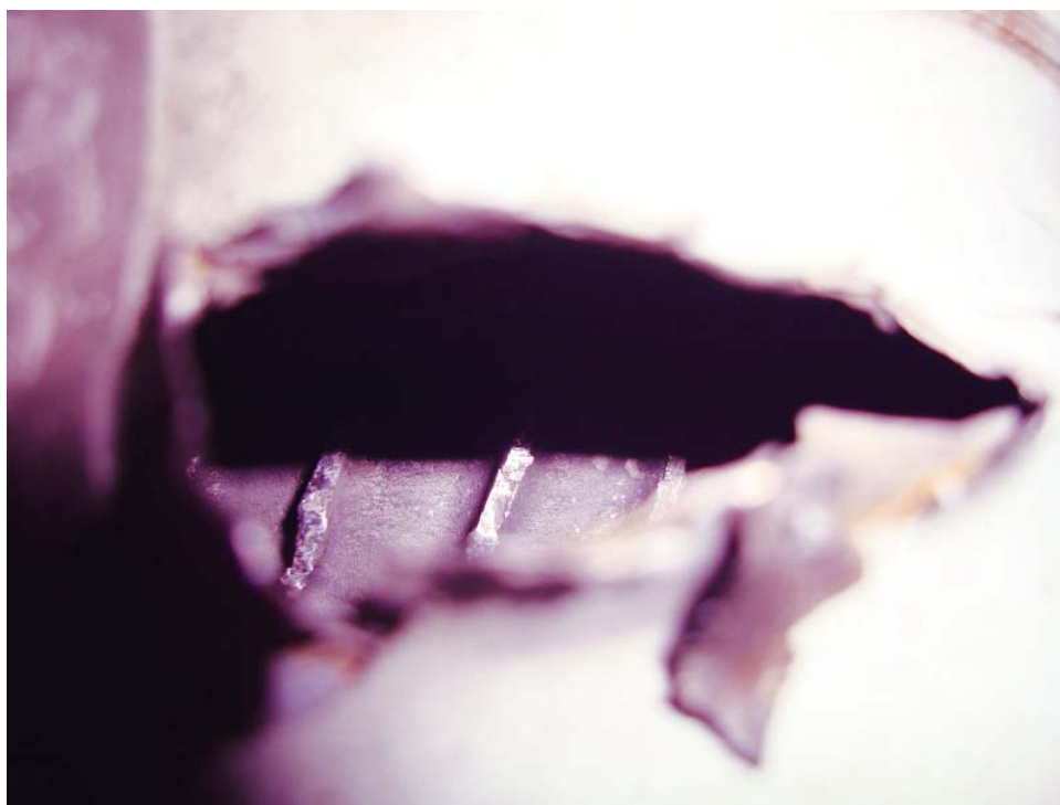
圖 1.16-5 自機匣外部可目視壓縮器轉子葉片斷落情形
