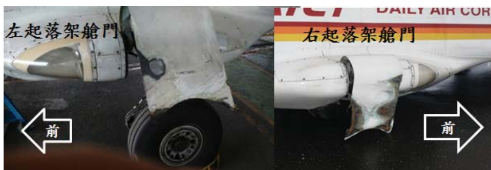
圖 1.12-3 起落架輪艙區結構損傷
