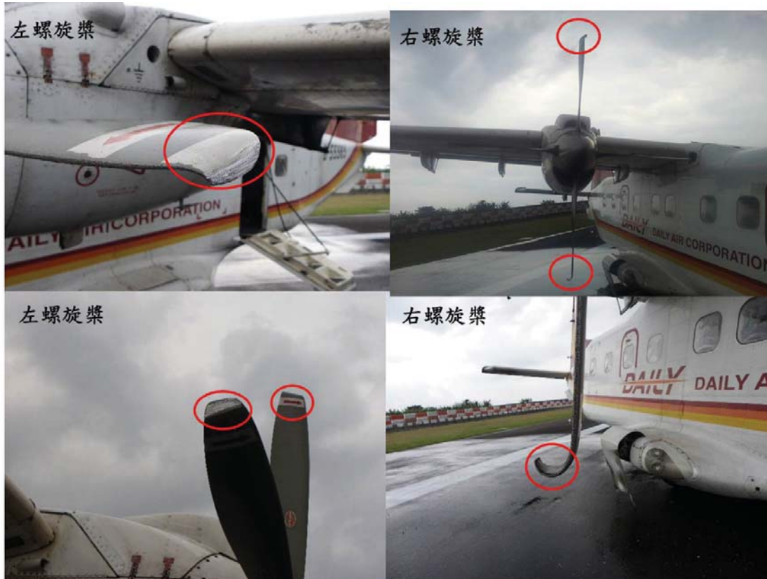
圖 1.12-6 螺旋槳槳葉損傷 左、右發動機壓縮器葉片經檢視發現有損傷狀況，詳圖 1.12-7。
