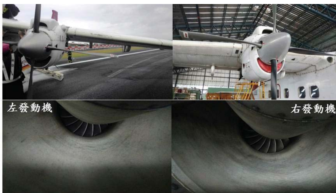
圖 1.12-7 左、右發動機壓縮器葉片損傷
