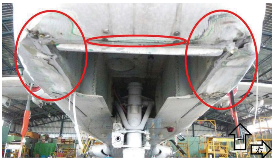
圖 1.12-2 機身前段鼻輪艙結構損傷
