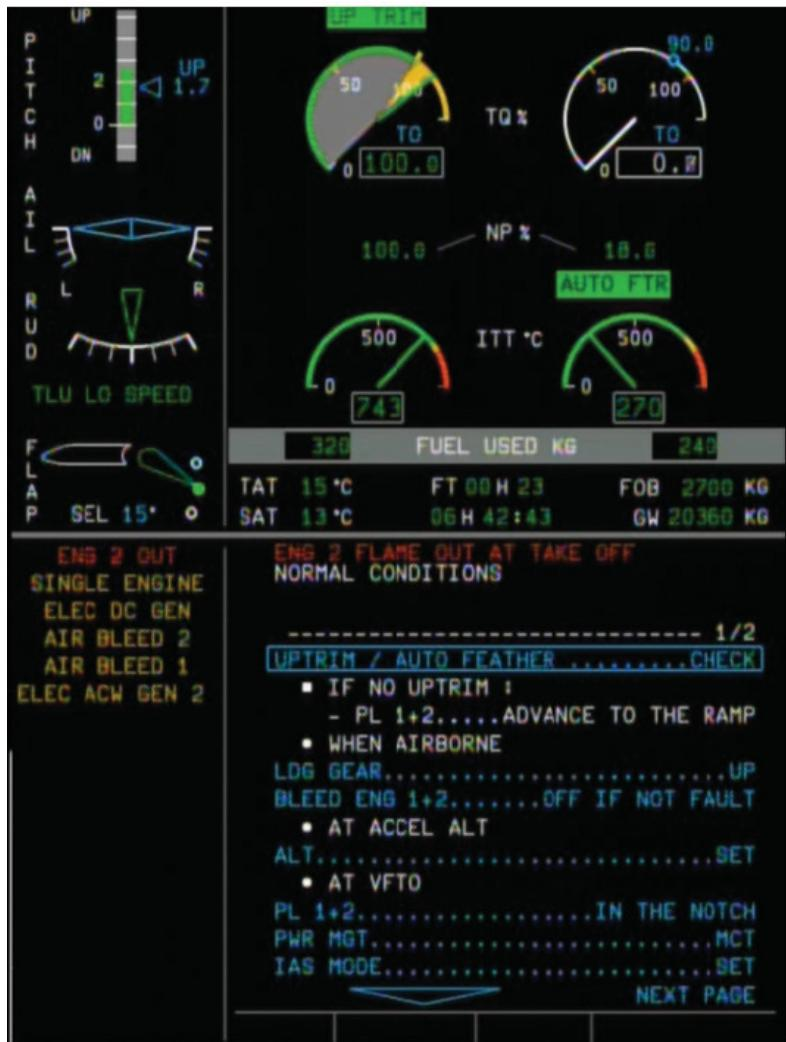
圖 1.6-4 模擬二號發動機自動順槳時之 EWD 顯示<sup>21</sup>
