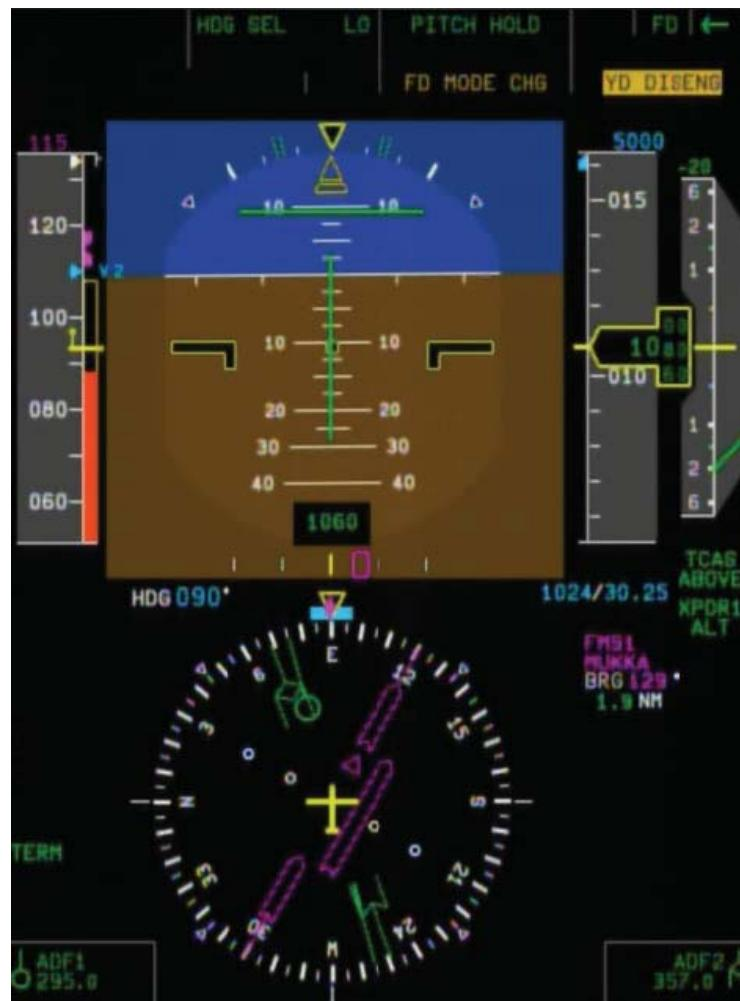
圖 1.16-1 控制桿推桿啓動時之 PFD 顯示
