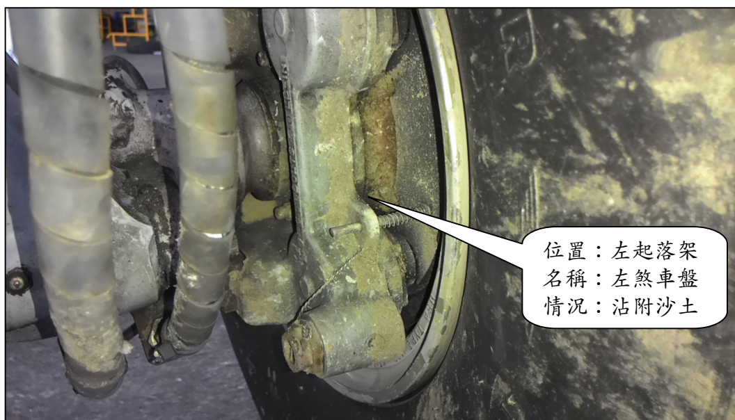
圖 1.6-5 左煞車盤沾附沙土
