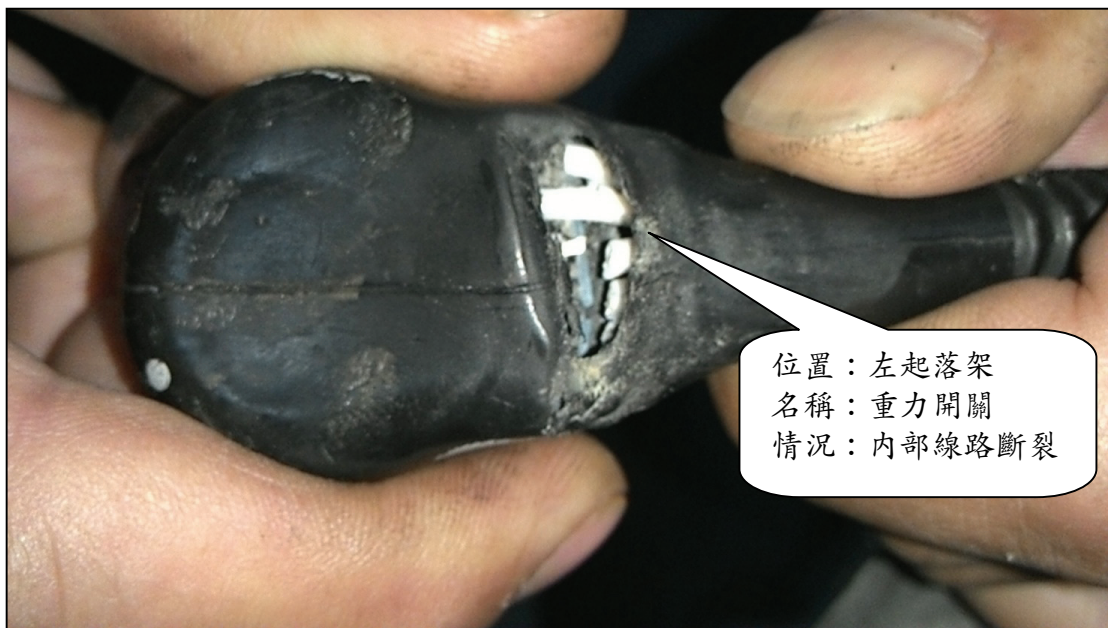
圖 1.6-3 左起落架重力開關內部線路斷裂
