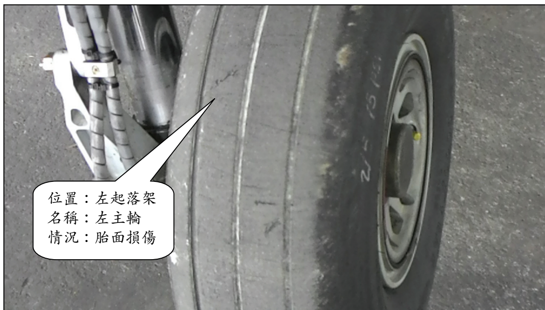
圖 1.6-1 左主輪胎面損傷
