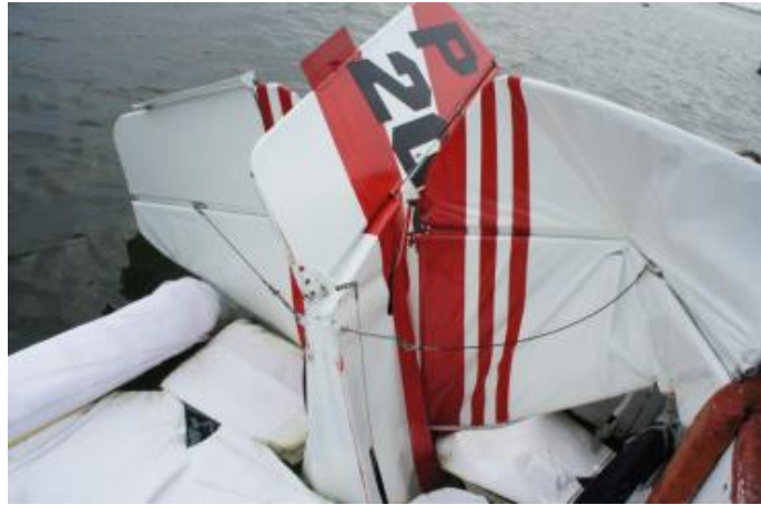
圖 6 右水平尾翼與船舷碰撞損害
