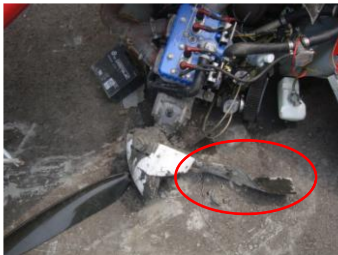
圖 10 螺旋槳葉片皺褶情形
