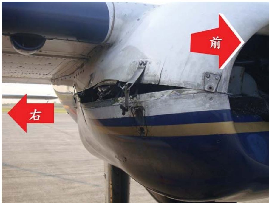
圖 1.1-1 左發動機及整流罩損害情形
