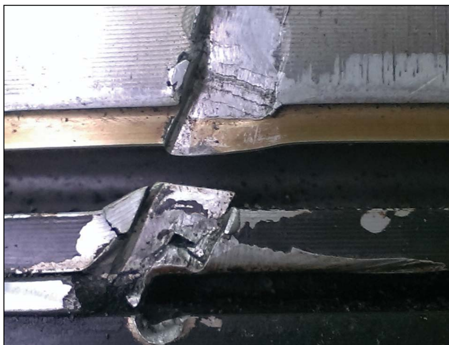
圖 1.16-14 活塞壁面呈現壓擠傷痕
