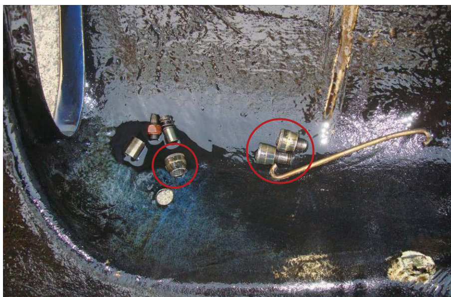
圖 1.16-8 斷落之螺栓 s1 及 s3
