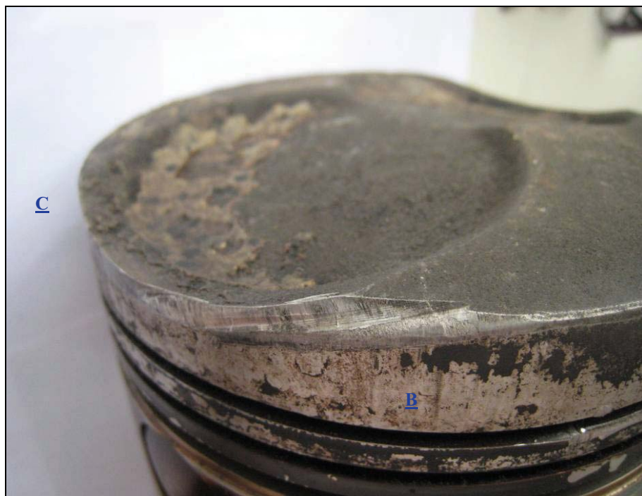
圖 1.16-12 破損活塞之巨觀觀察
