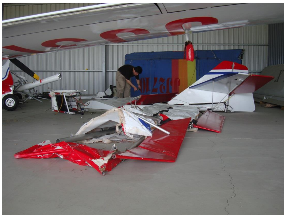
圖 12 左翼前緣及翼尖結構呈外物撞擊損壞
