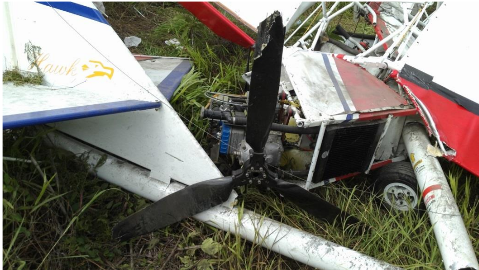
圖 9 發動機螺旋槳損壞
