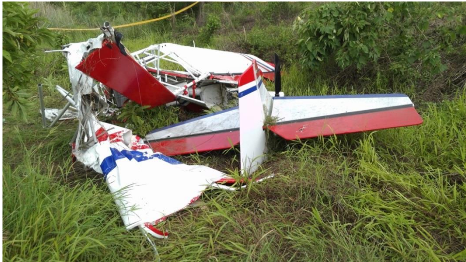
圖 10 載具尾翼輕微受損
