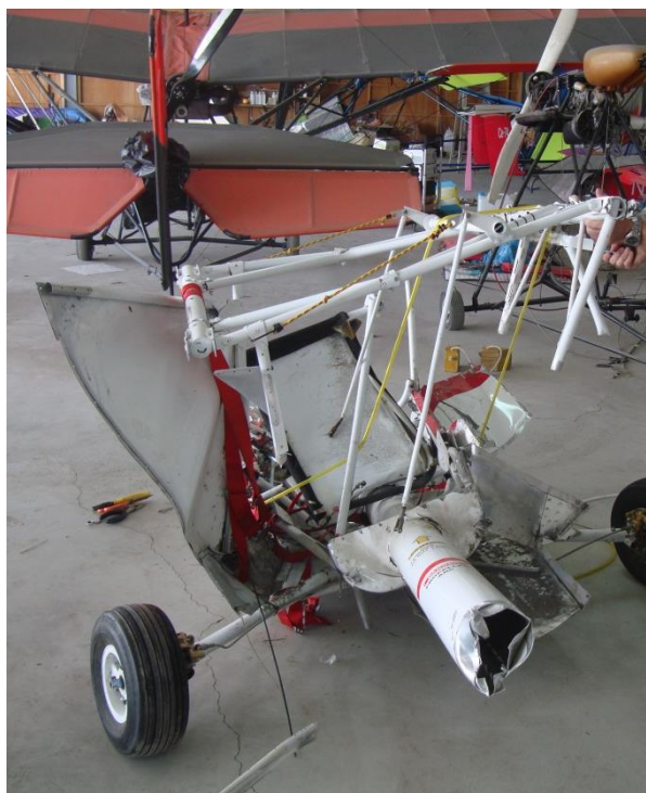
圖 13 駕駛艙、起落架與機翼支撐結構呈外物撞擊損壞
