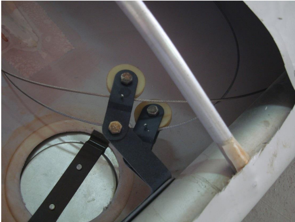
圖 15 右副翼操控鋼繩與滑輪結構正常
