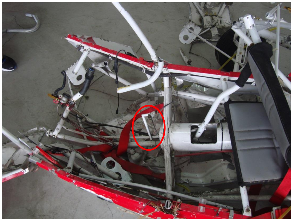
圖 16 副翼操控鋼繩連桿斷落情形一
