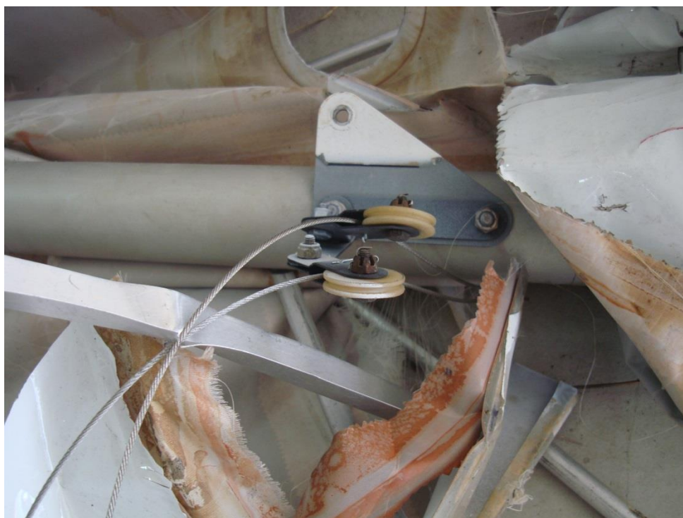
圖 14 左副翼操控鋼繩與滑輪結構正常
