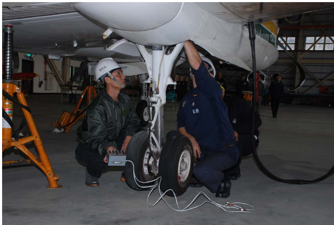
圖 1.16-2 主輪起落架收放系統迴路開關測試
