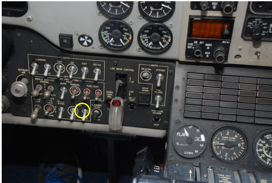
圖 1.12-1 2 安培斷電器位於跳出位置
