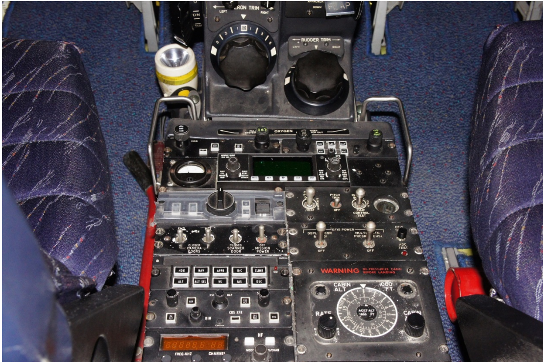
圖 1.6-6 正駕駛座旁之手動泵操作手柄
