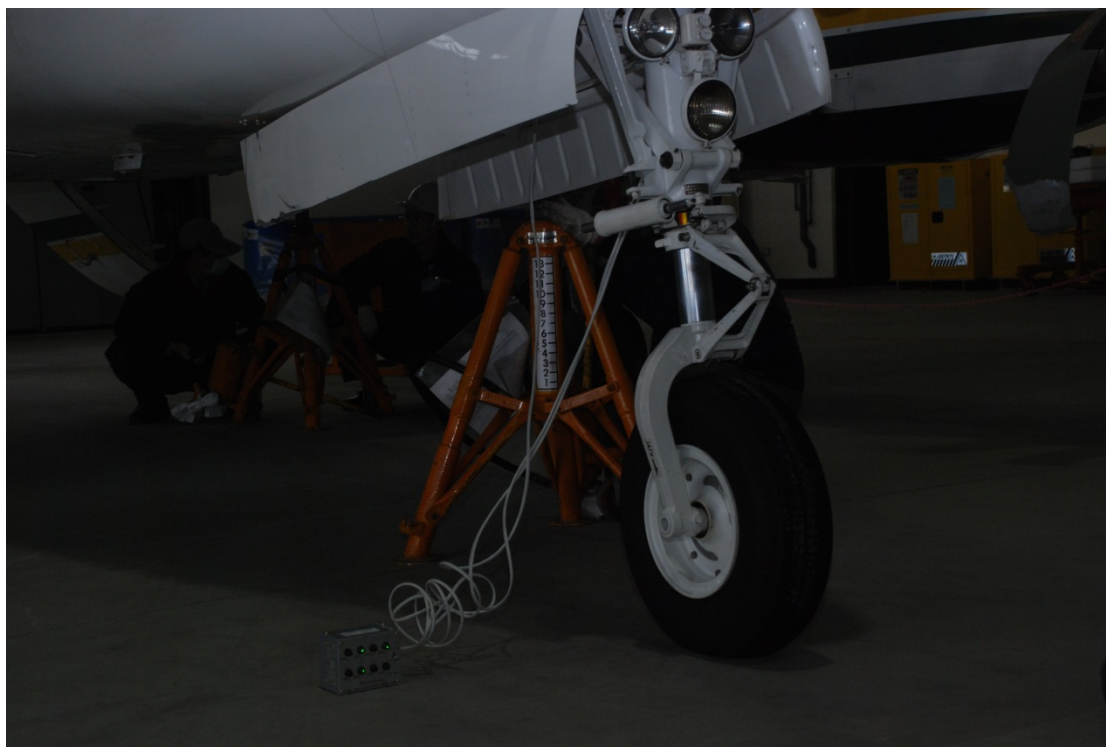
圖 1.16-1 鼻輪起落架收放系統迴路開關測試
