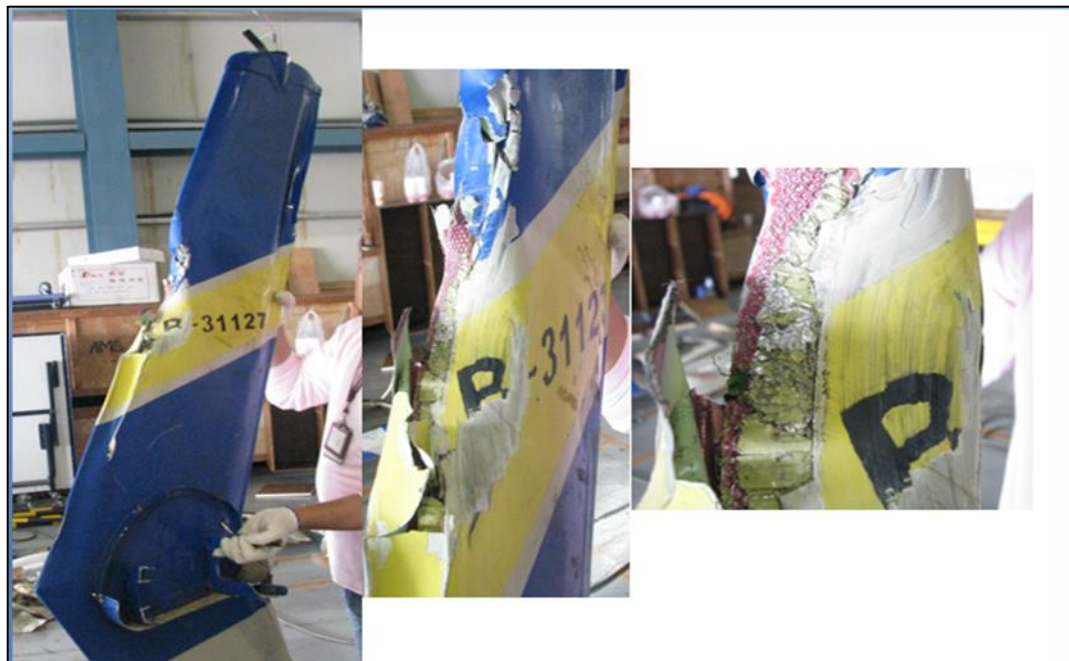
圖 1.16-13 垂直尾翼損壞狀況
