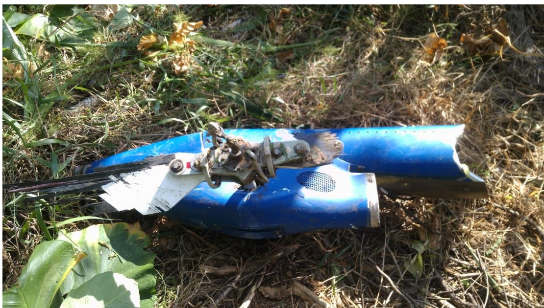
圖 1.12-11 尾旋翼斷落情形
