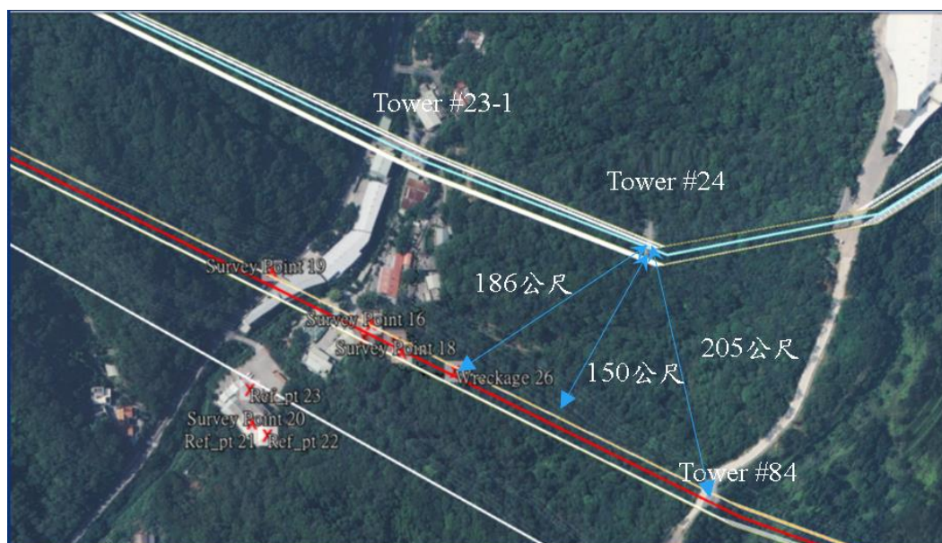
圖 1.12-3 事故地區電塔位置及纜線距離
