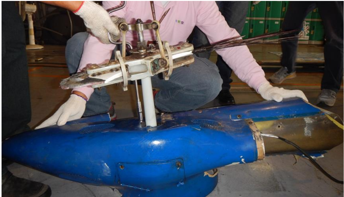
圖 1.16-12 尾旋翼損壞狀況
