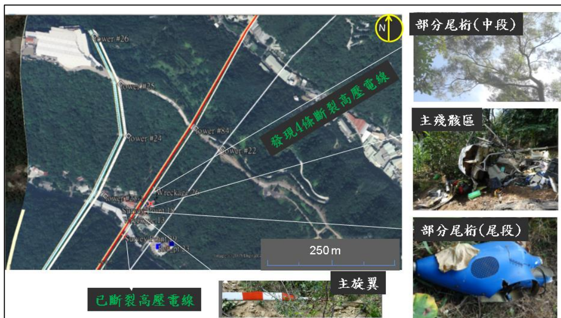
圖 1.12-4 事故區域空照圖、殘骸及電塔分布圖
