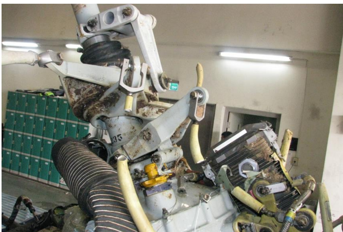
圖 1.16-19 變向盤及相關之連桿損壞情形
