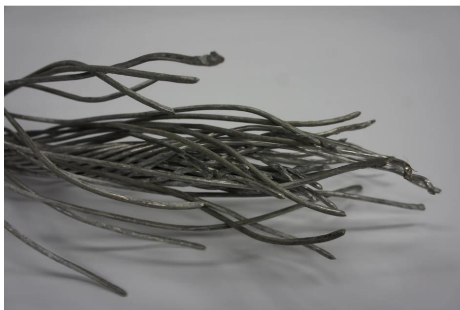
圖 1.16-22 斷裂電纜線 A 之巨觀觀察
