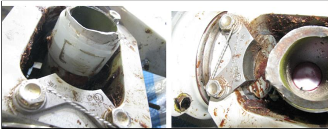
圖 1.16-4 主旋翼支撐桿與套軸撞擊痕跡
