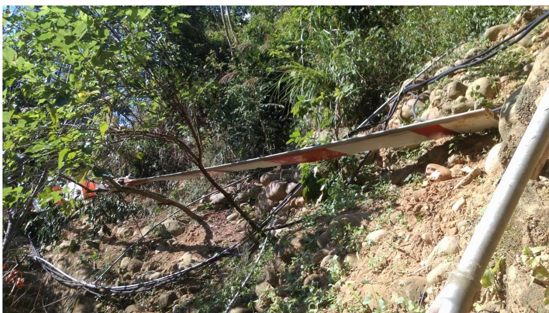
圖 1.12-10 主旋翼斷落情形
