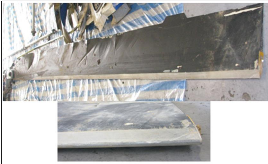
圖 1.16-1 主旋翼損壞狀況 1
