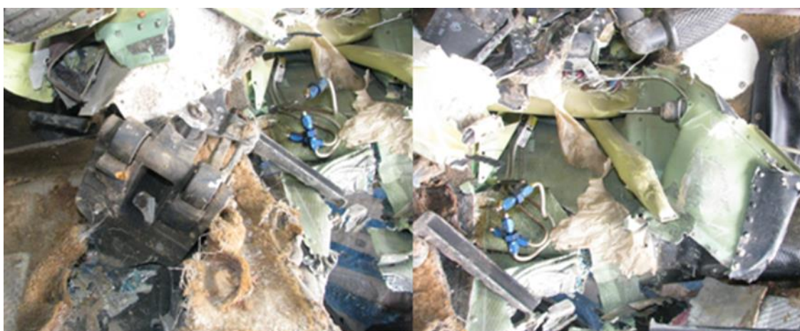
圖 1.16-17 方向控制踏板毀損狀況
