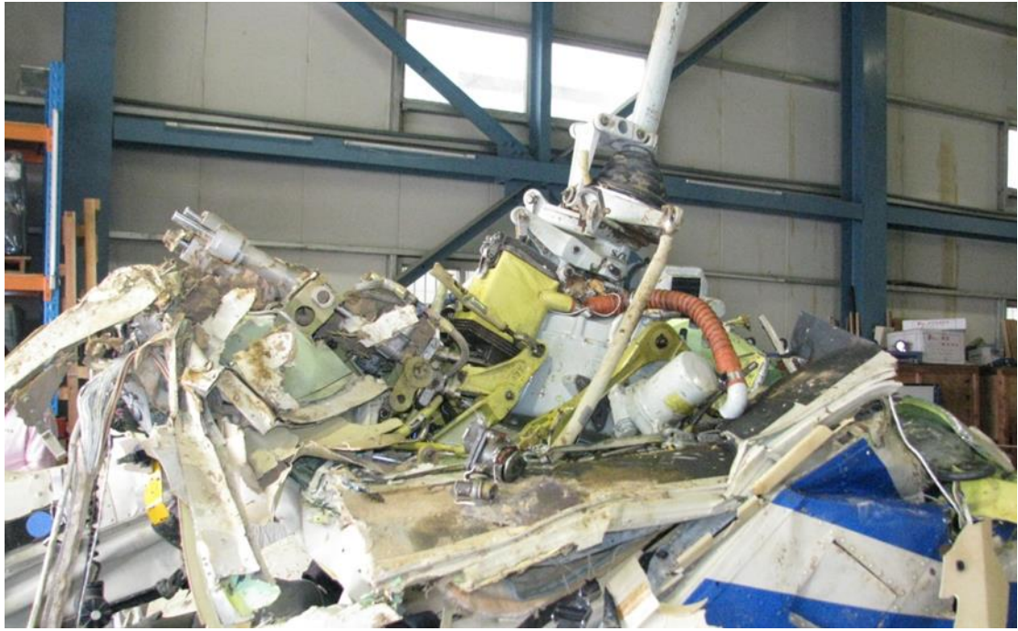
圖 1.16-6 主齒輪箱受損狀況
