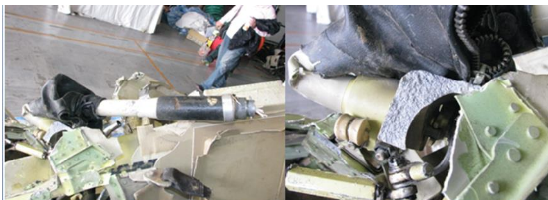
圖 1.16-16 集體桿斷裂狀況
