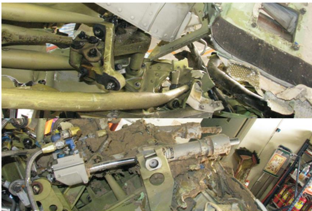
圖 1.16-18 控制機構扭曲變形狀況
