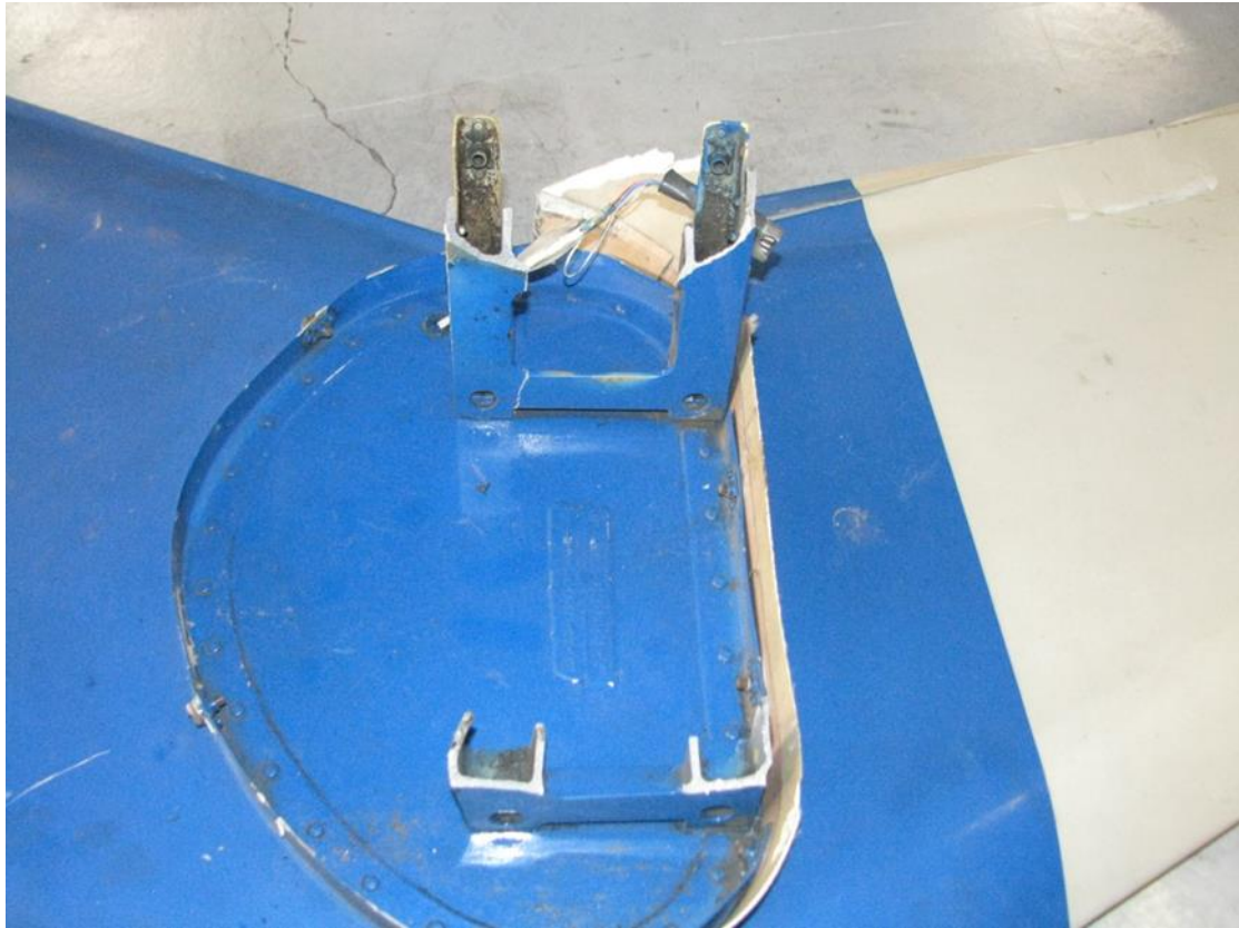
圖 1.16-14 連接尾部結構之支架損壞
