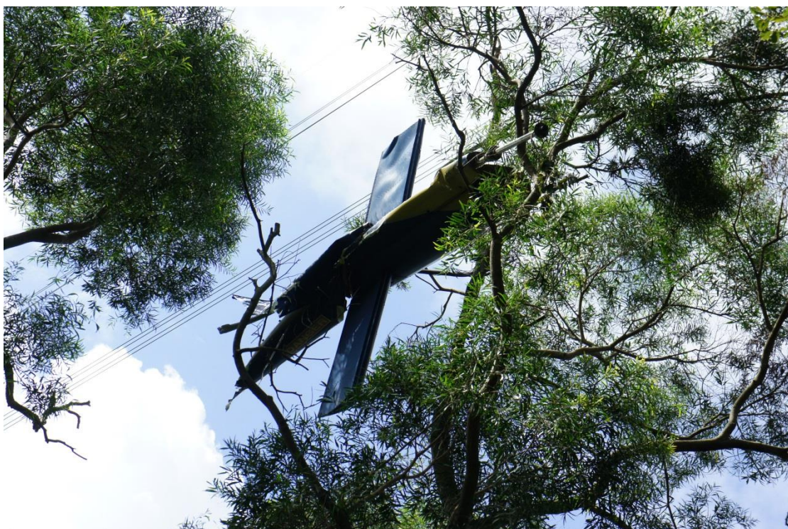
圖 1.12-13 水平尾翼斷落情形
