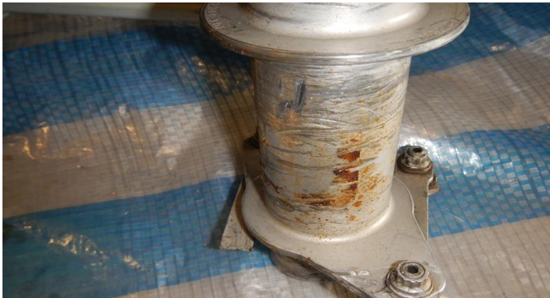
圖 1.16-5 主旋翼支撐套軸之纏繞痕跡
