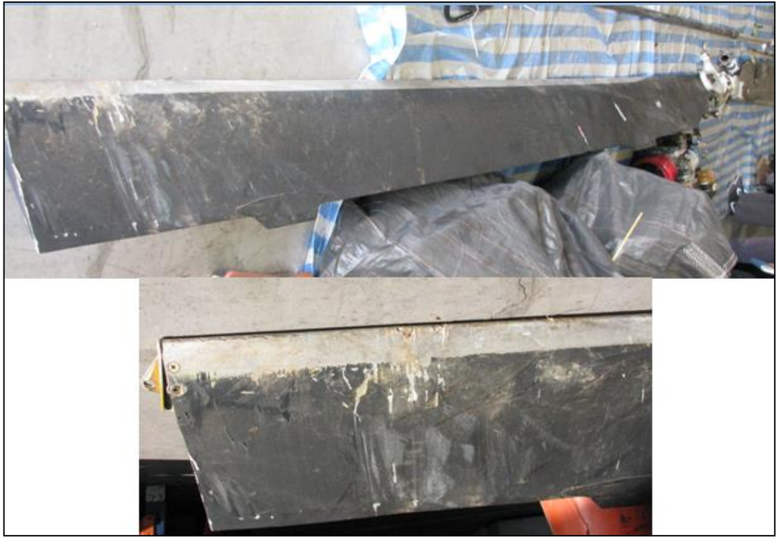
圖 1.16-2 主旋翼損壞狀況 2
