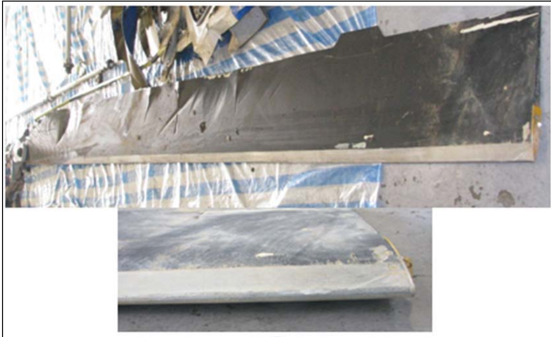
圖 1.16-1 主旋翼損壞狀況 1
