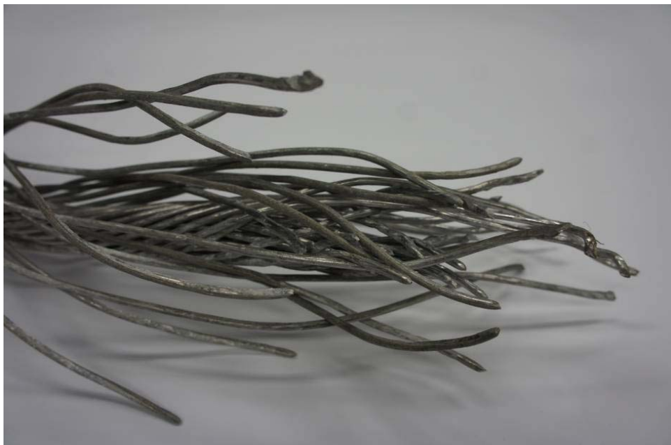
圖 1.16-22 斷裂電纜線 A 之巨觀觀察
