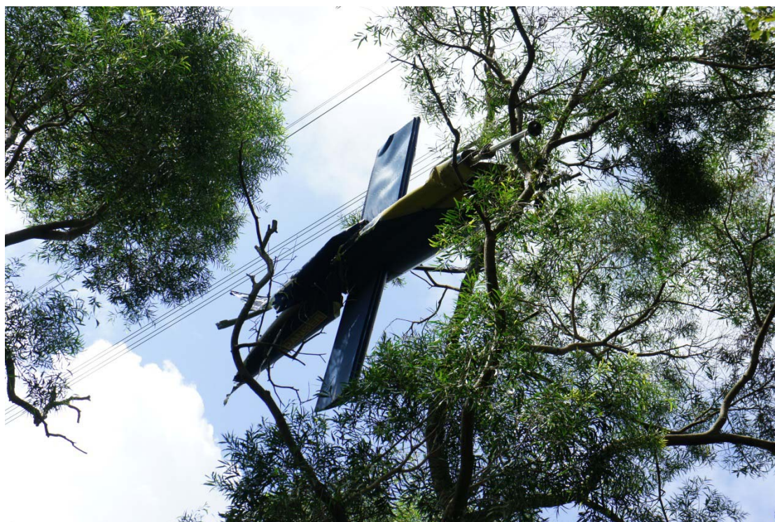
圖 1.12-13 水平尾翼斷落情形
