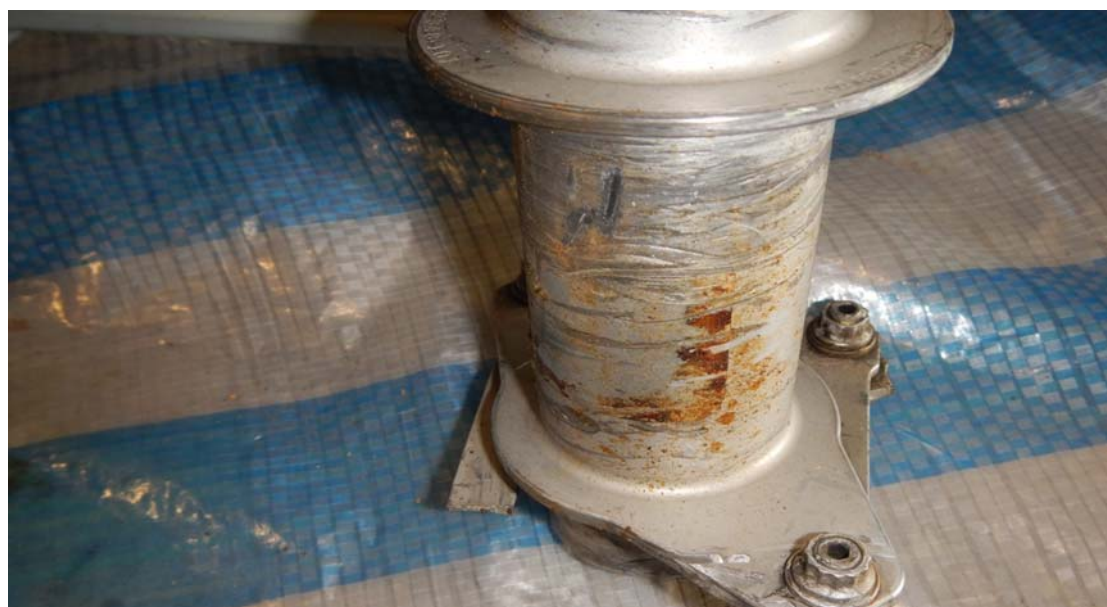
圖 1.16-5 主旋翼支撐套軸之纏繞痕跡
