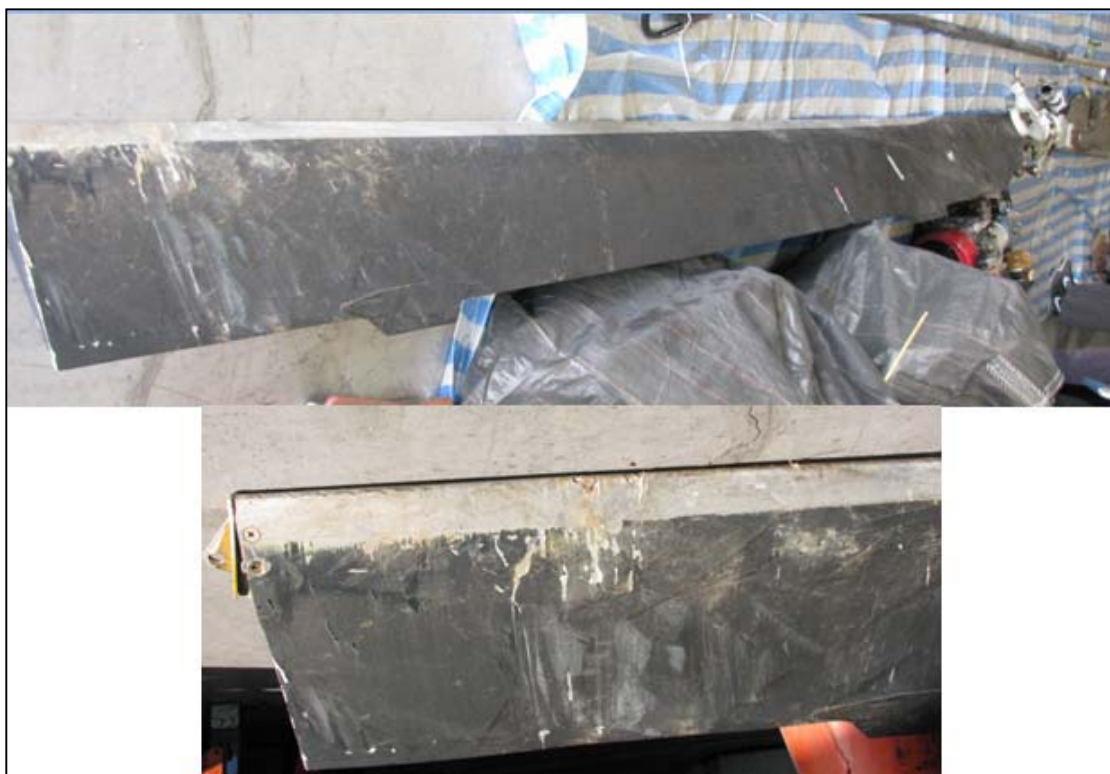
圖 1.16-2 主旋翼損壞狀況 2
