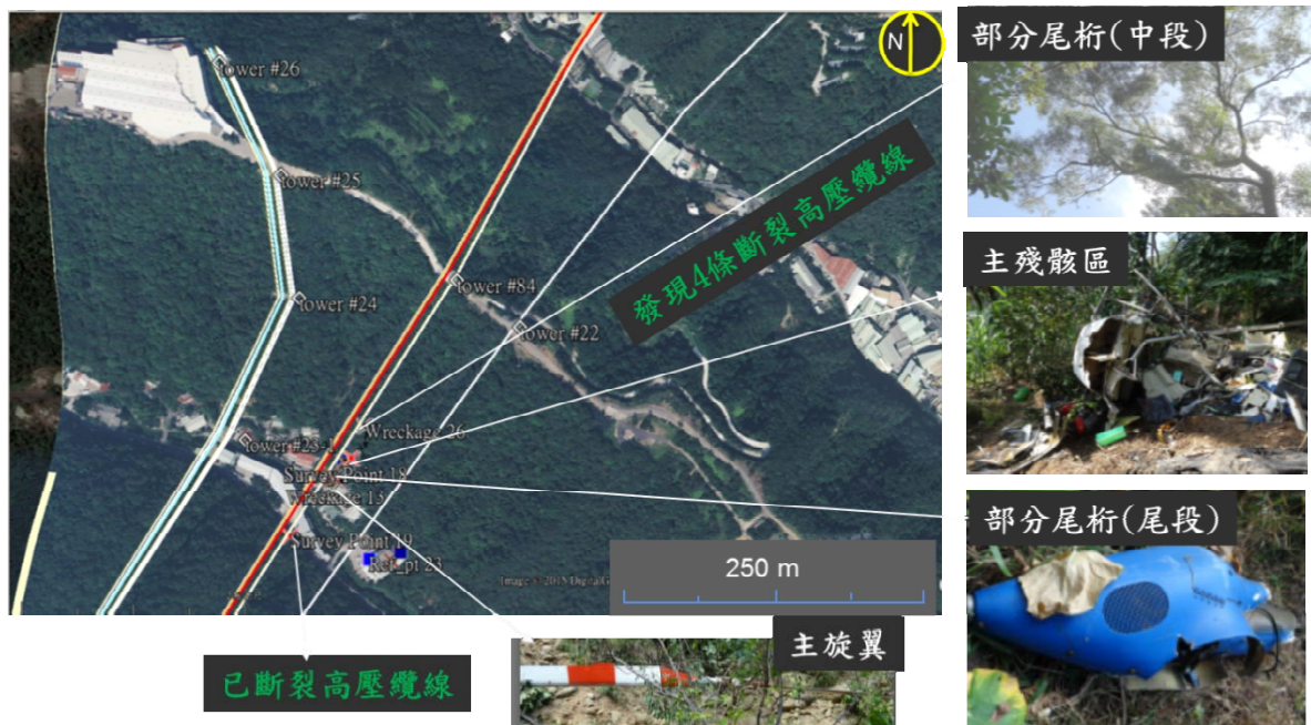
圖 1.12-4 事故區域空照圖、殘骸及電塔分布圖
