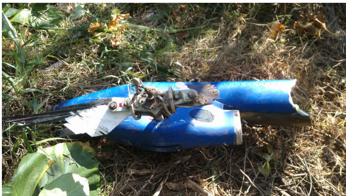
圖 1.12-11 尾旋翼斷落情形
