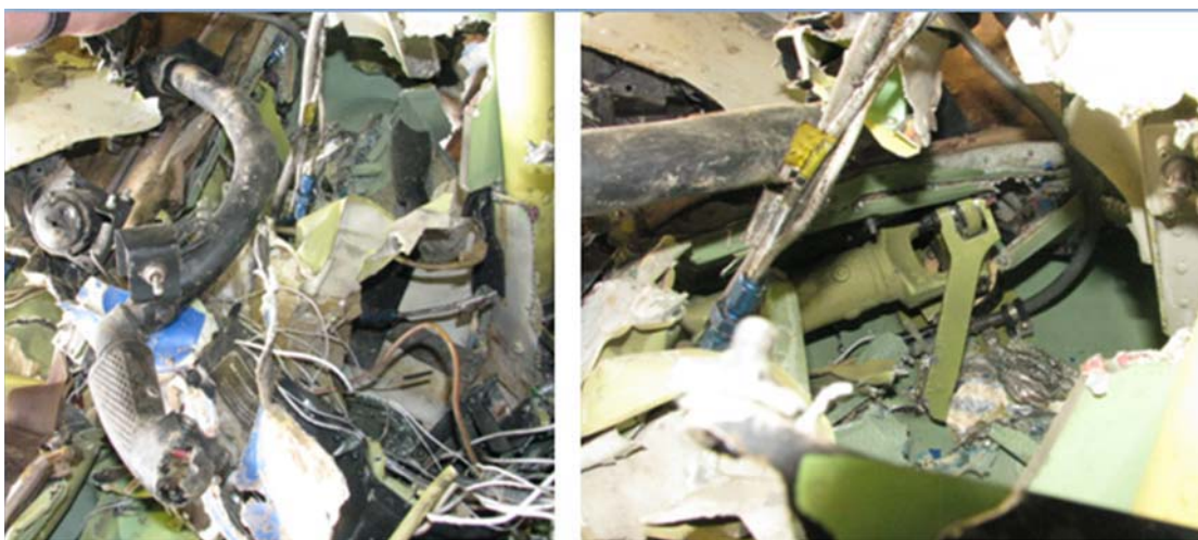
圖 1.16-15 迴旋桿損壞狀況
