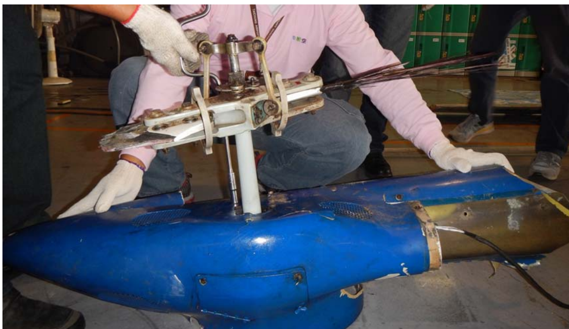
圖 1.16-12 尾旋翼損壞狀況
