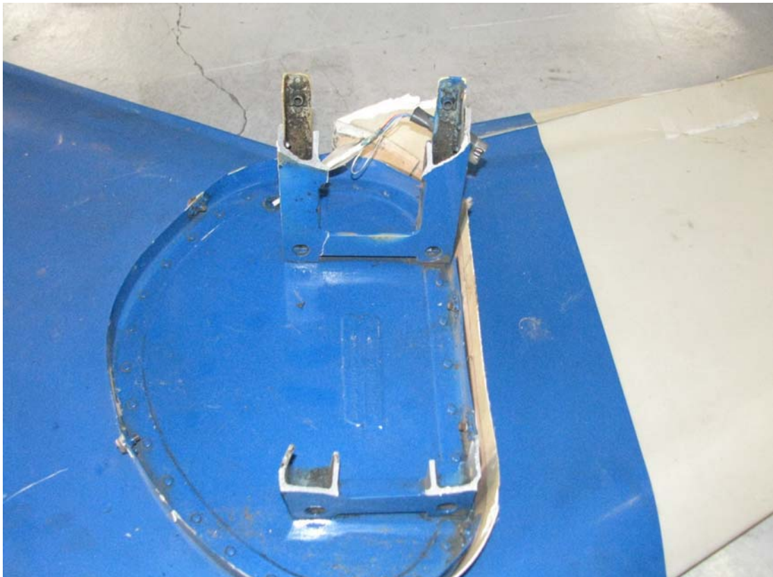
圖 1.16-14 連接尾部結構之支架損壞
