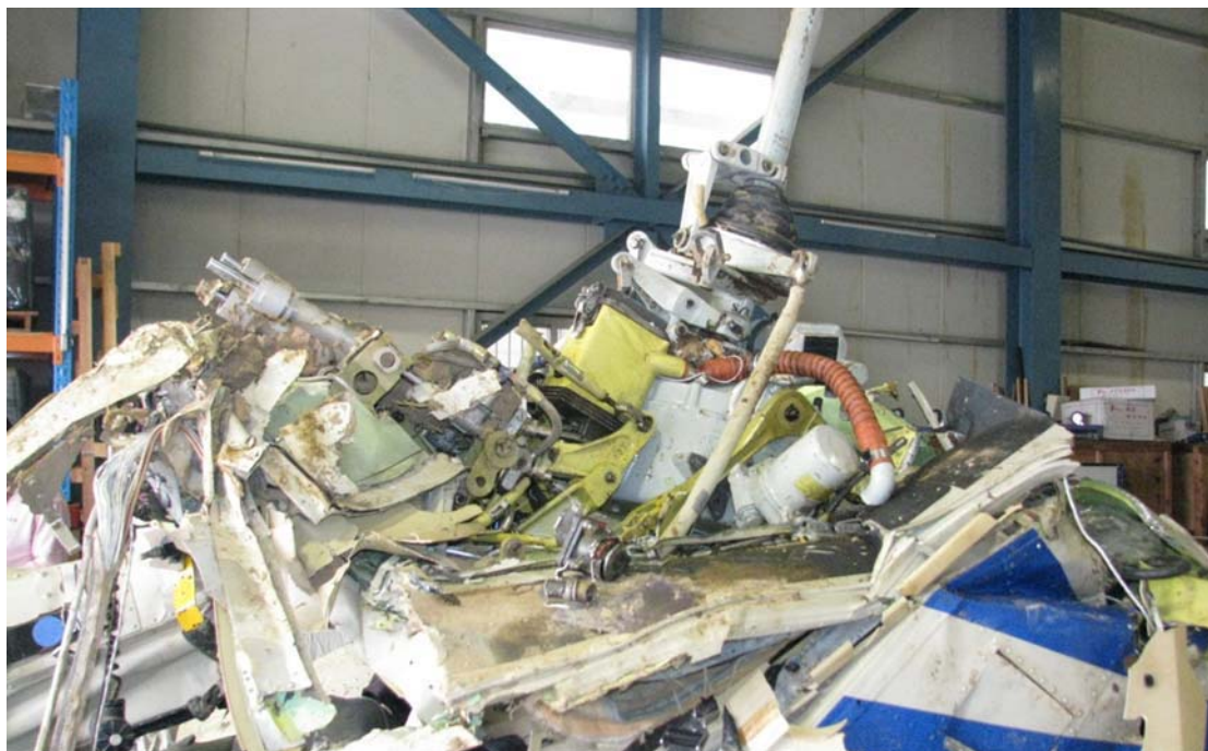
圖 1.16-6 主齒輪箱受損狀況
