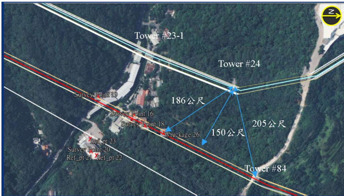
圖 1.12-3 事故地區電塔位置及纜線距離
