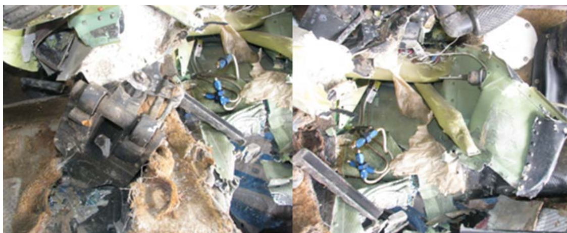
圖 1.16-17 方向控制踏板毀損狀況
