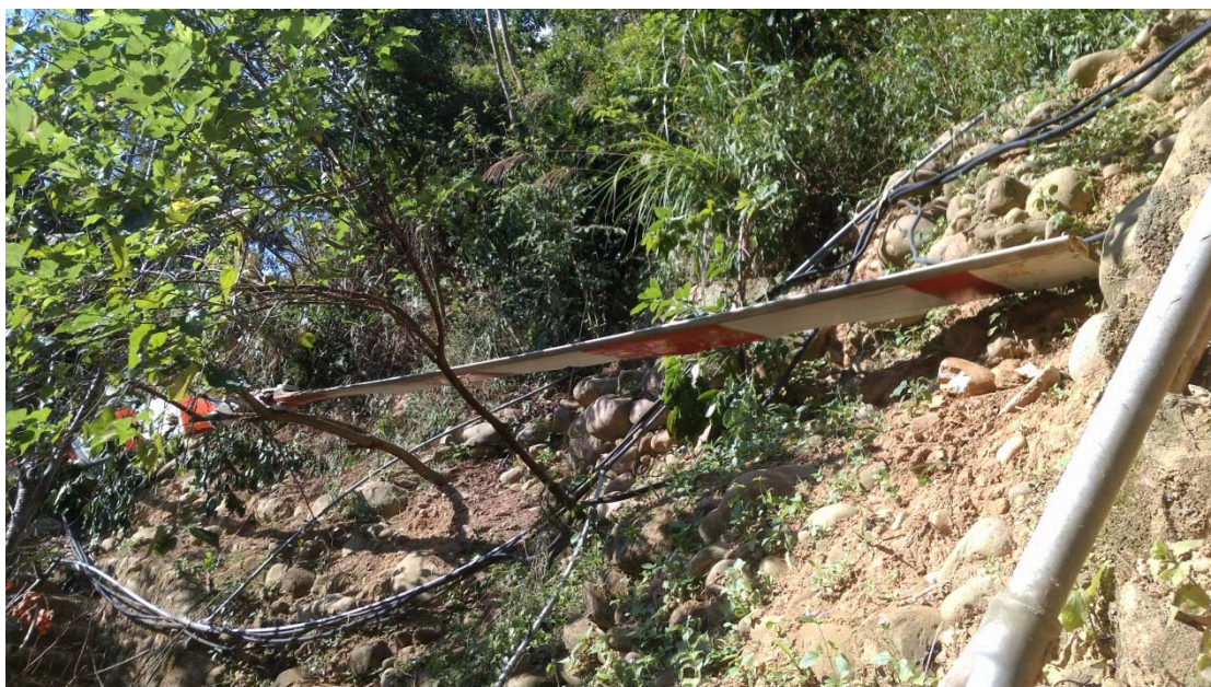
圖 1.12-10 主旋翼斷落情形
