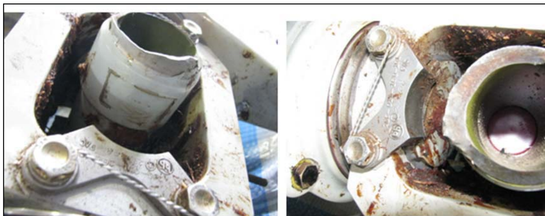
圖 1.16-4 主旋翼支撐桿與套軸撞擊痕跡
