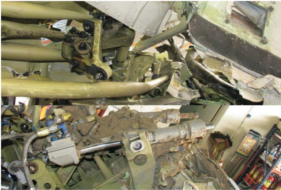
圖 1.16-18 控制機構扭曲變形狀況
