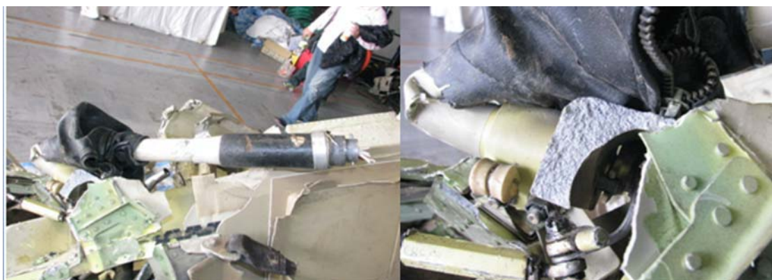
圖 1.16-16 集體桿斷裂狀況
