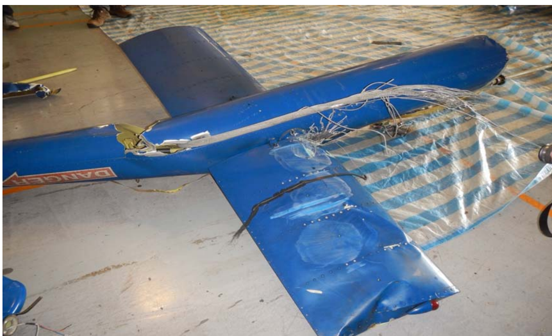
圖 1.16-10 水平尾與機身接合處與纜線纏繞及摩擦狀況 1
