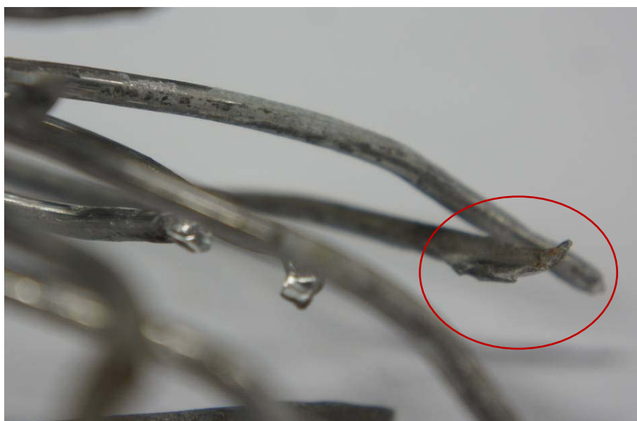
圖 1.16-23 斷裂電纜線 A 之外圈鋁線
