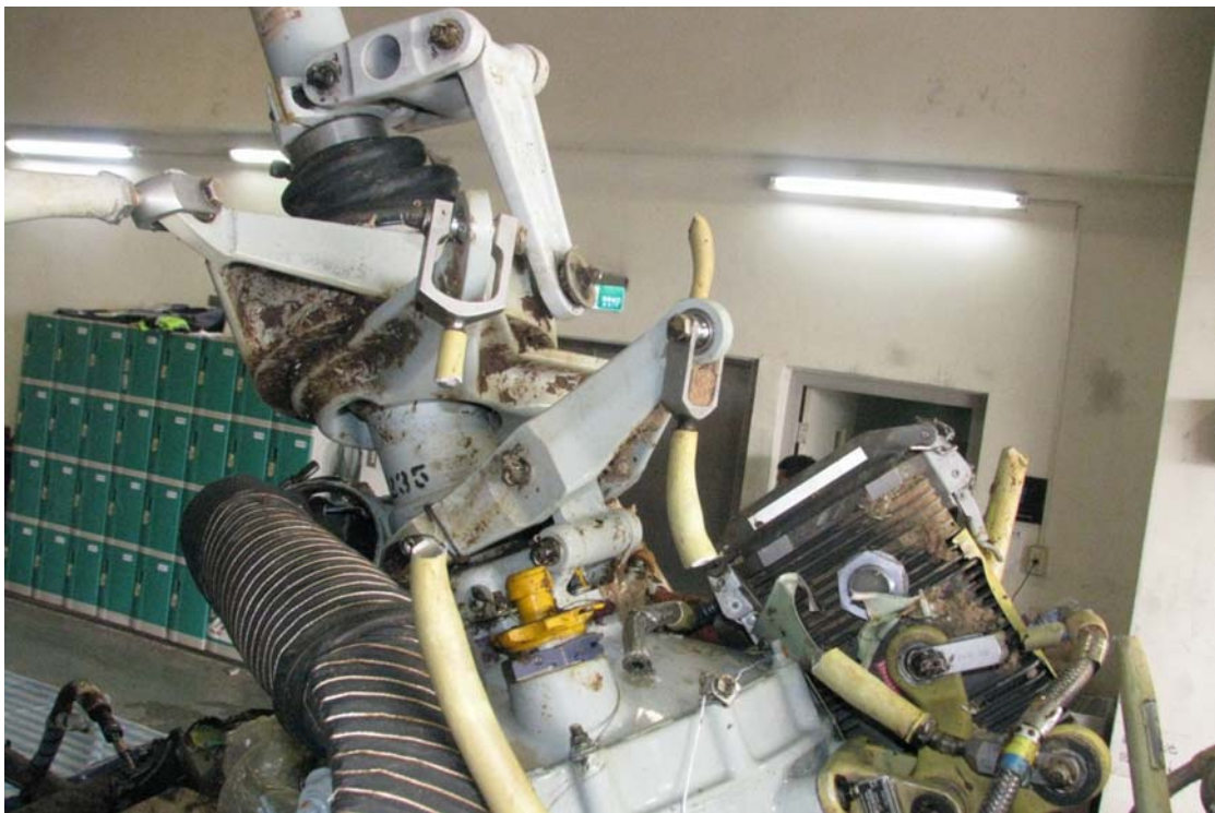
圖 1.16-19 變向盤及相關之連桿損壞情形
