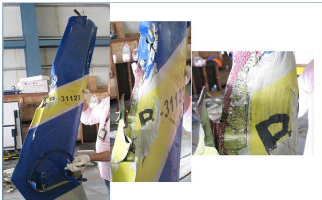
圖 1.16-13 垂直尾翼損壞狀況
