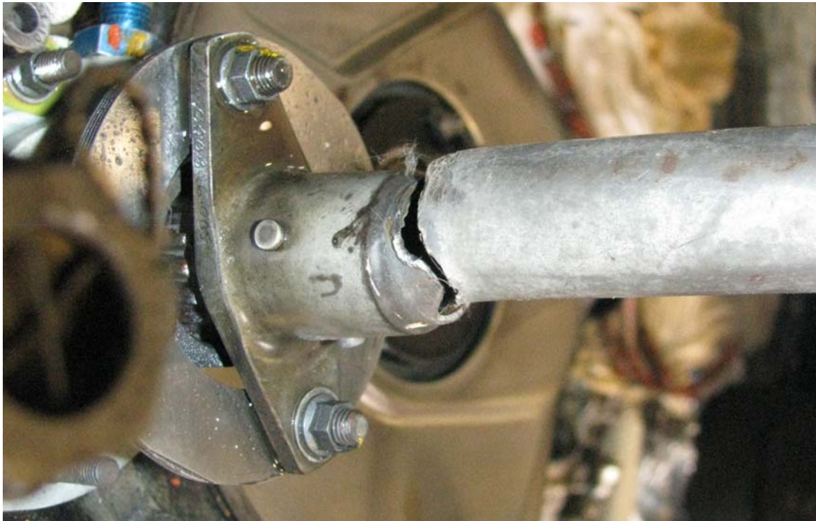
圖 1.16-8 尾旋翼傳動軸斷裂
