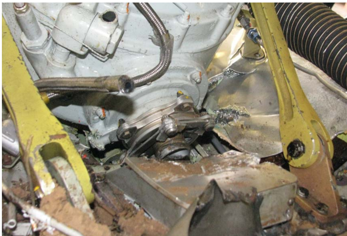
圖 1.16-7 主齒輪箱水平連接軸
