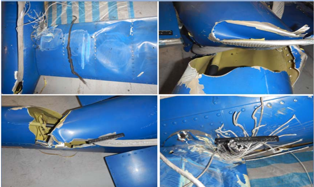
圖 1.16-11 水平尾與機身接合處與纜線纏繞及摩擦狀況 2
