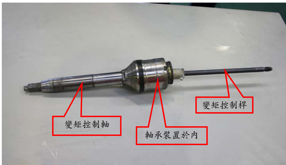
圖 1.12-22 變矩控制軸、變矩控制桿及軸承之相對位置
