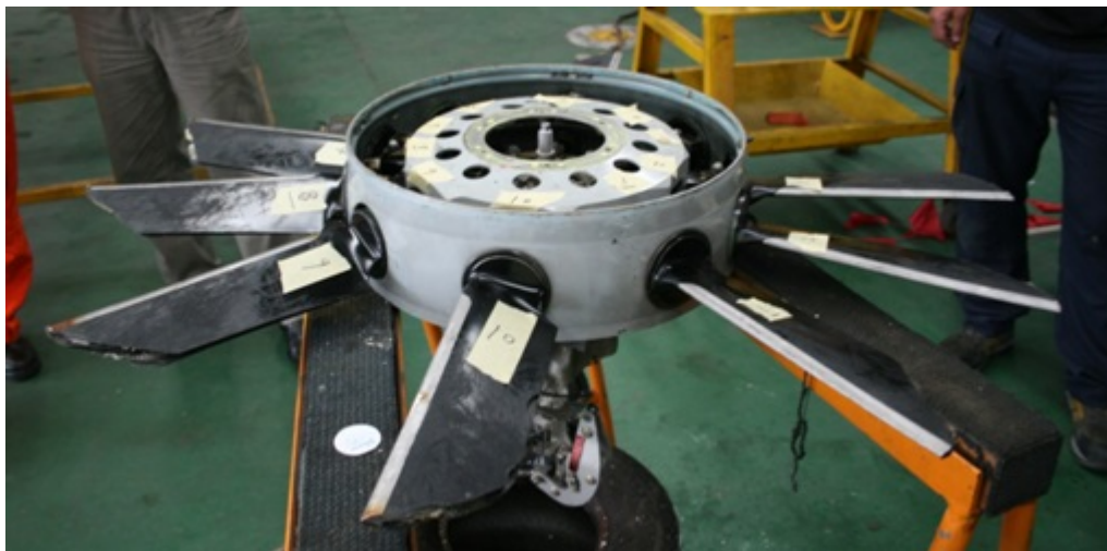
圖 1.12-17 尾旋翼片及尾齒輪箱損害情形（一）
