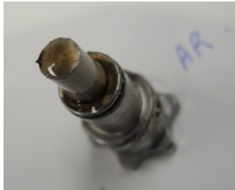
圖 1.12-30 右發動機手動磁性堵頭無金屬屑殘留
