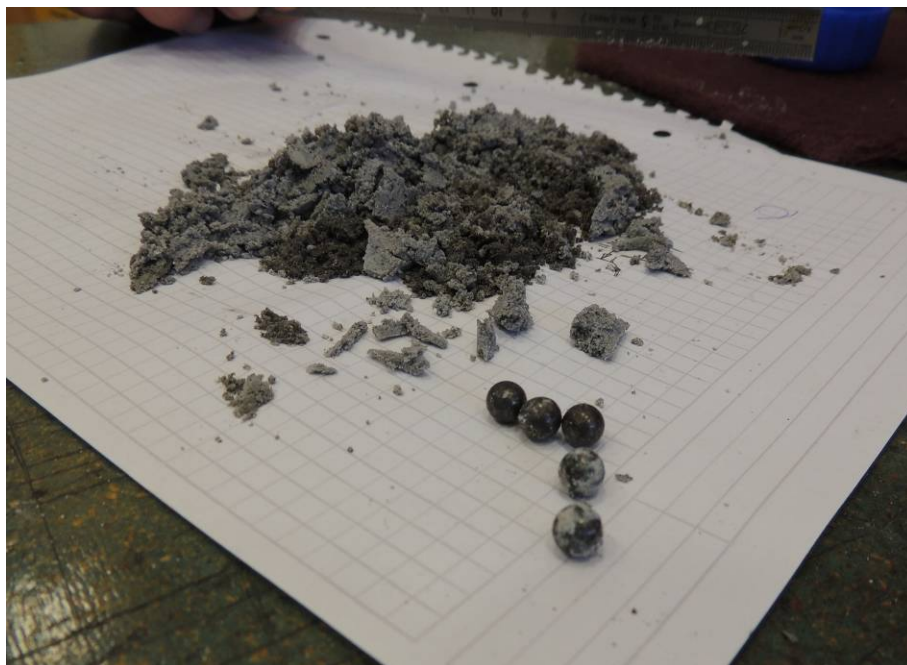
圖 1.16-7 尾旋翼變矩控制軸內部之金屬粉末及 5 顆軸承滾珠
