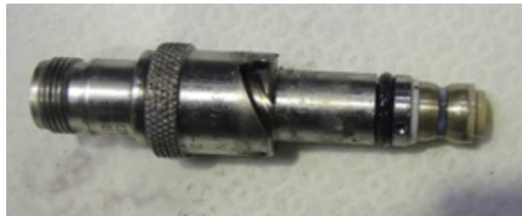
圖 1.12-27 左發動機電子磁性堵頭無金屬屑殘留
