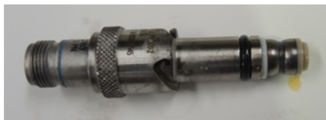
圖 1.12-29 右發動機電子磁性堵頭無金屬屑殘留
