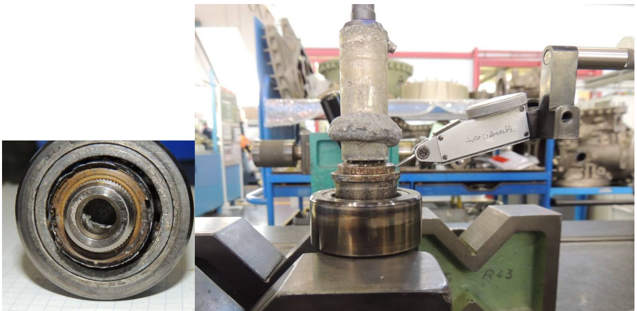
圖 1.16-10 量測滾珠軸承內環之偏移量
