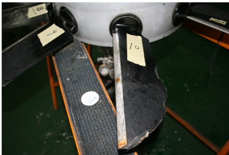
圖 1.12-18 尾旋翼片及尾齒輪箱損害情形（二）
