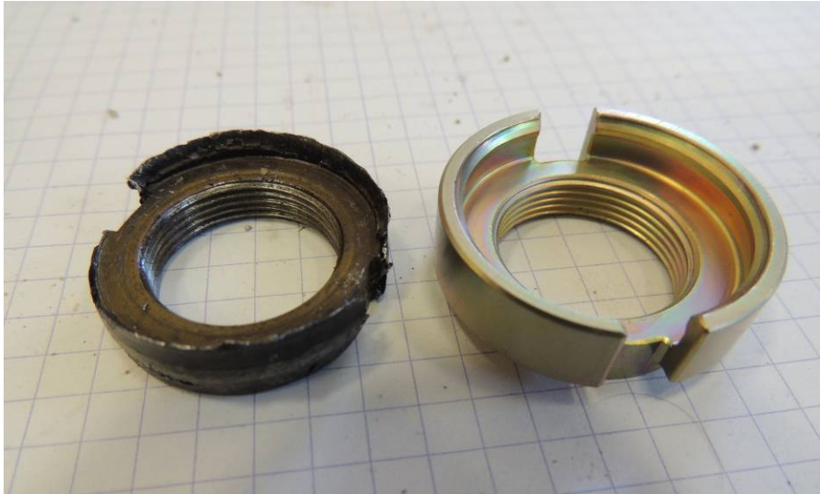
圖 1.16-19 受損軸承螺帽與正常軸承螺帽之對照
