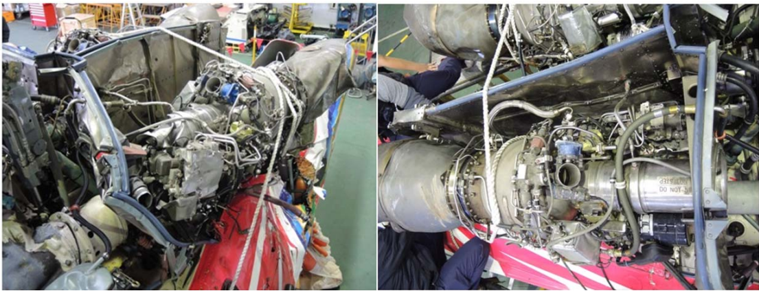
圖 1.12-26 左/右發動機壓縮器與渦輪機損害情形
