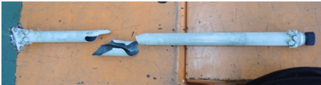
圖 1.12-15 扭力傳動軸前段斷裂情形
