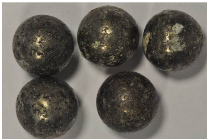
圖 1.16-16 掉入尾旋翼控制軸內部之 5 顆滾珠
