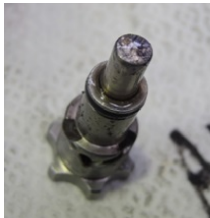
圖 1.12-28 左發動機手動磁性堵頭無金屬屑殘留
