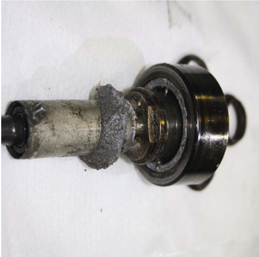
圖 1.12-25 軸承外環位移至螺帽側
