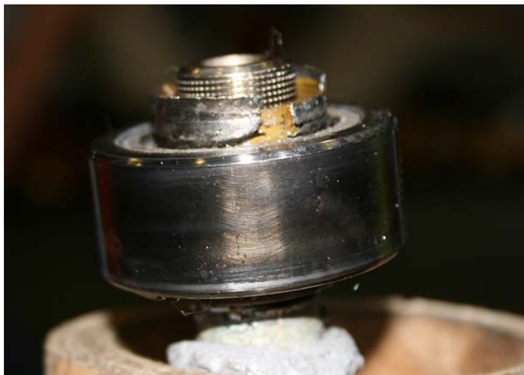
圖 1.12-24 軸承螺帽側內環擋肩磨失
