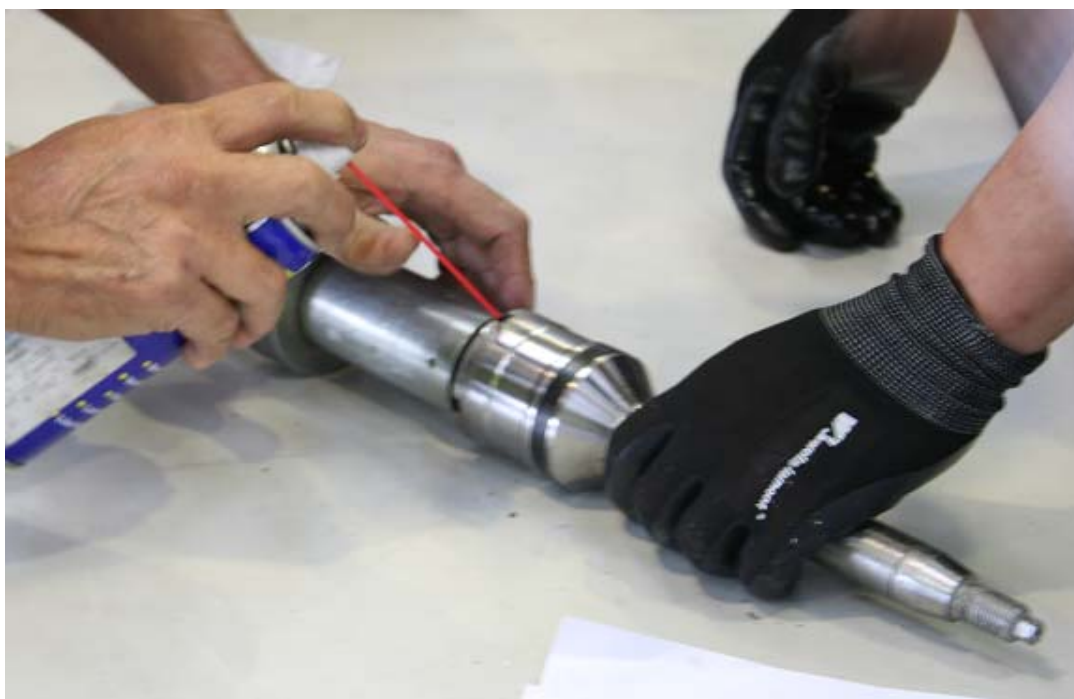
圖 1.12-23 拆解軸承作業中
