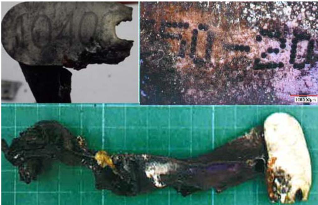
圖 1.16-3 額定電池容量標示及未完全焚燬之單電池紫色塑料外皮
