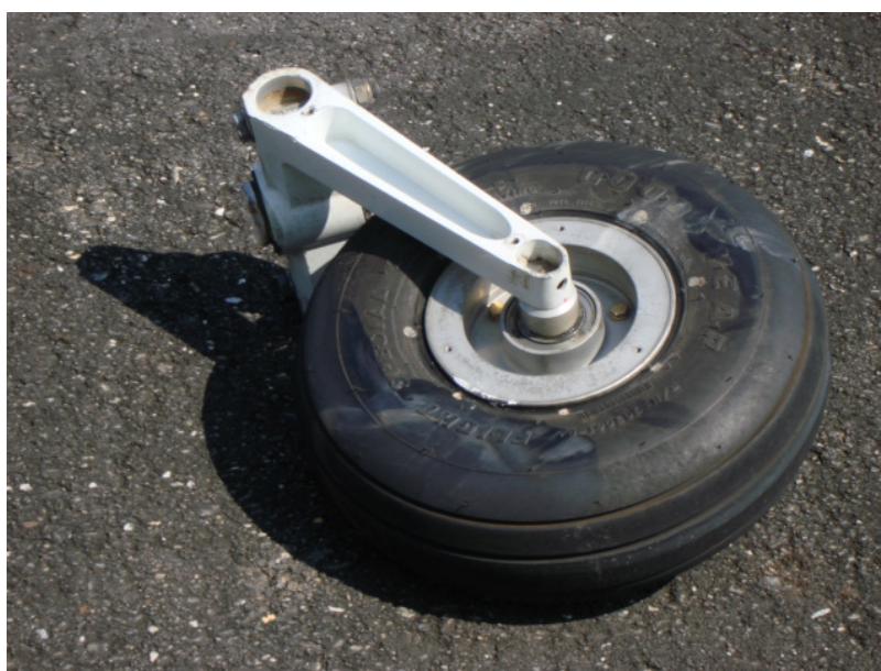
圖 1.12-2 鼻輪支柱斷裂脫離
