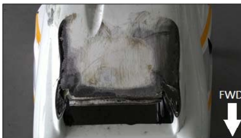
圖 1.12-4 發動機艙整流罩撞擊磨損
