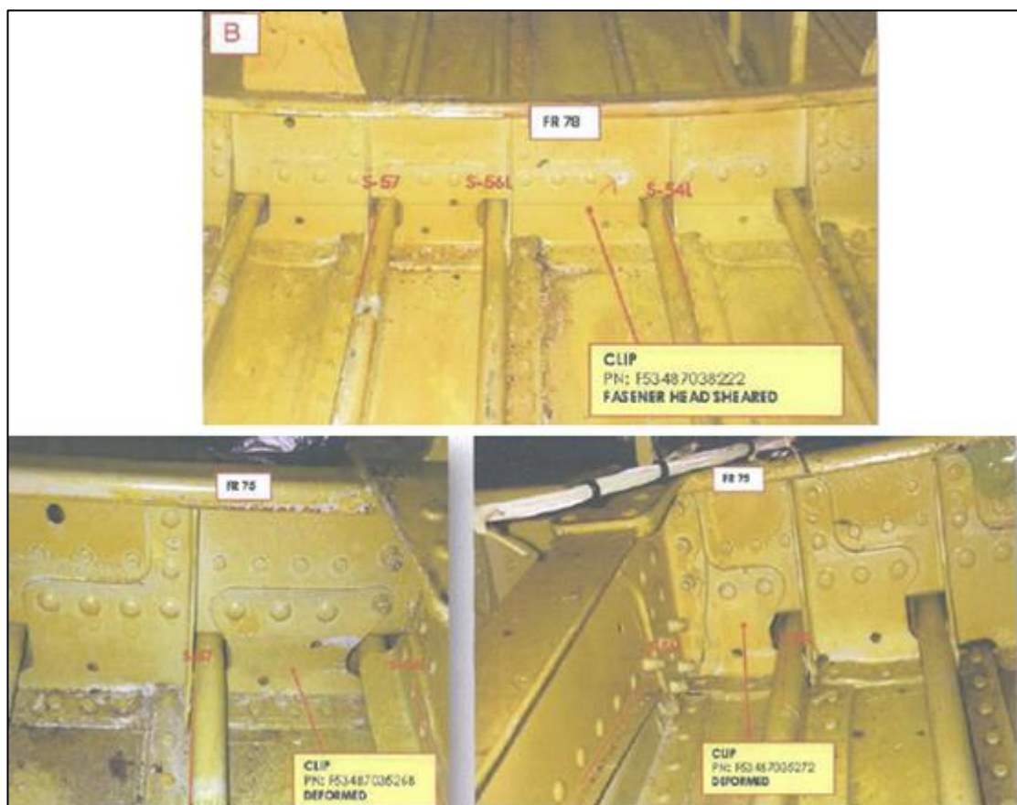
圖 1.12-5 連接片擠壓變形
