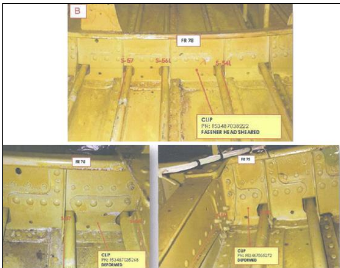
圖 1.12-5 連接片擠壓變形
