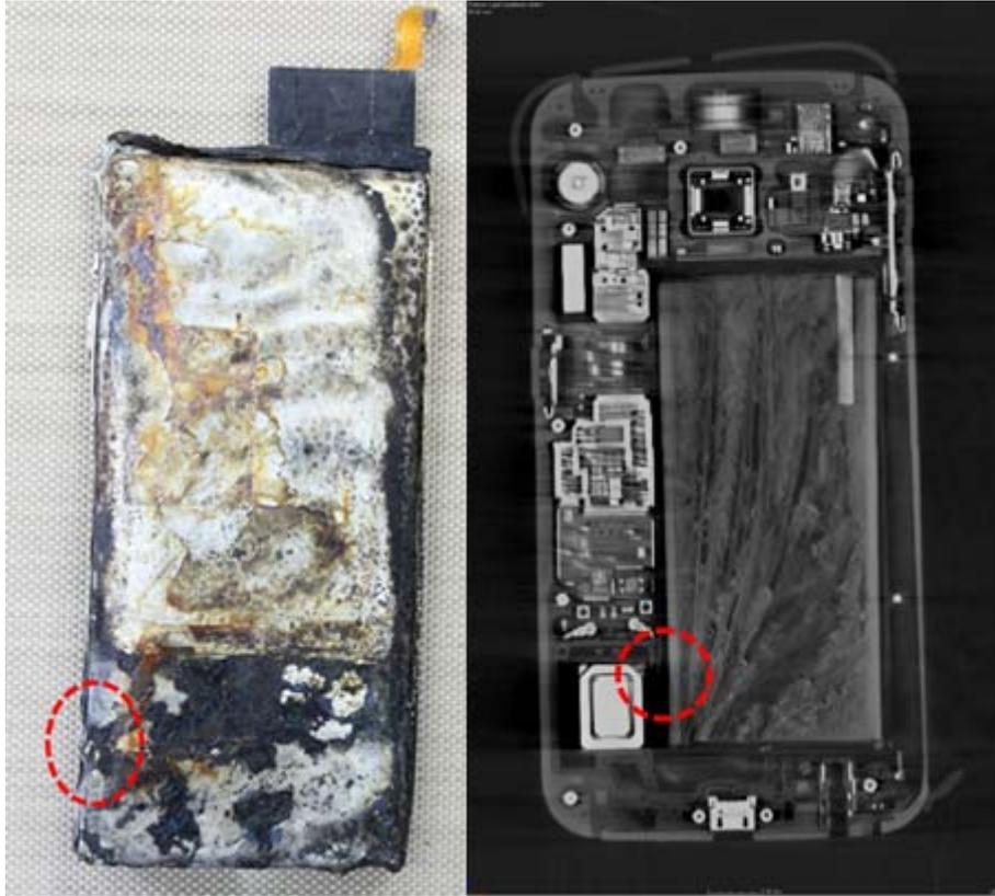
圖 1.18-2 電池左下角外觀與電腦斷層影像
