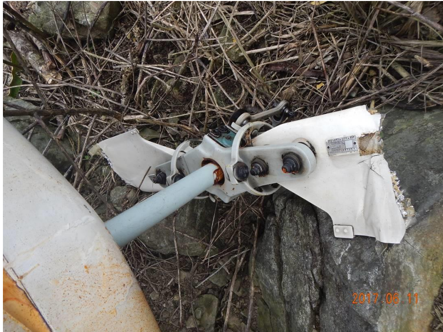
圖 1.12-10 兩片尾旋翼片折斷情形
