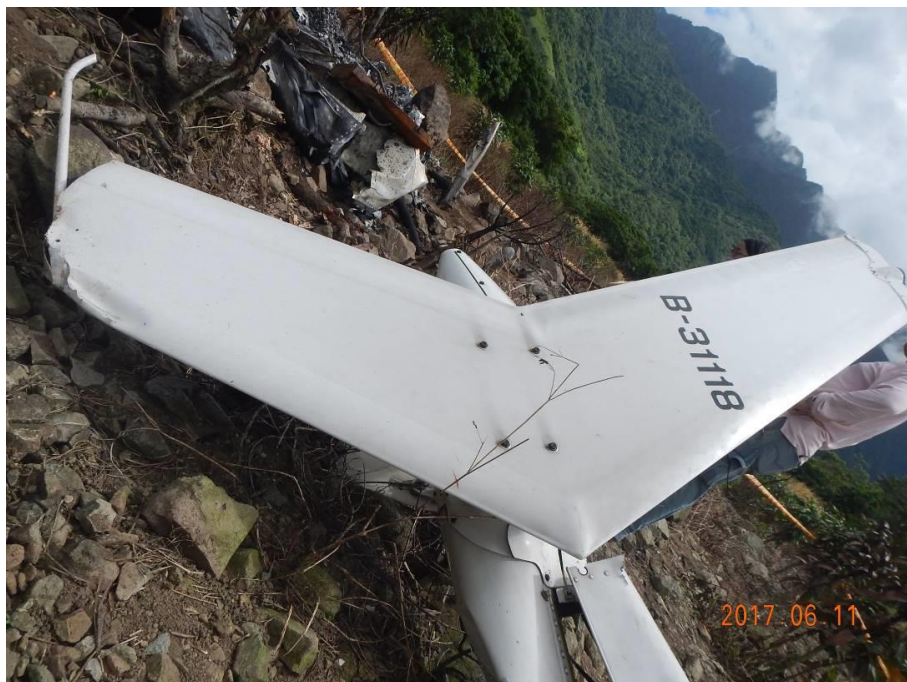
圖 1.12-11 垂直安定面損害情形
