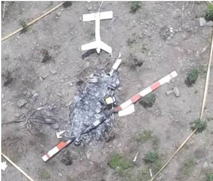
圖 1.12-6 尾桁斷落情形
