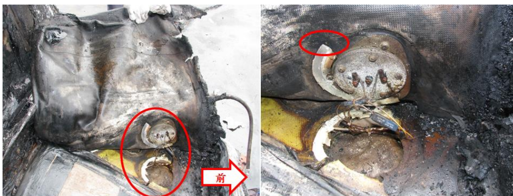
圖 1.16-4 油箱底部燒毀狀況
