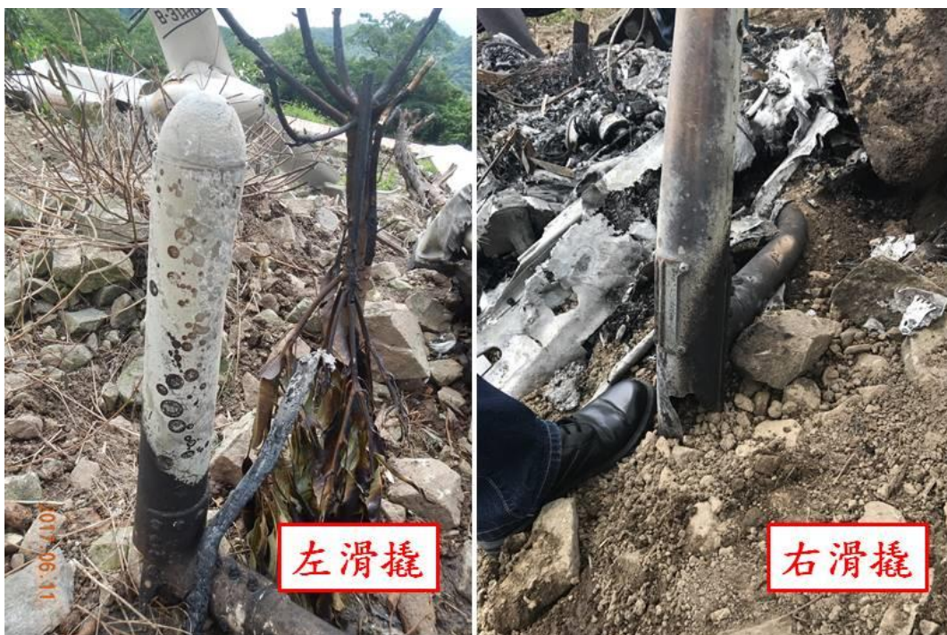
圖 1.12-9 左、右滑撬折斷插入地面情形
