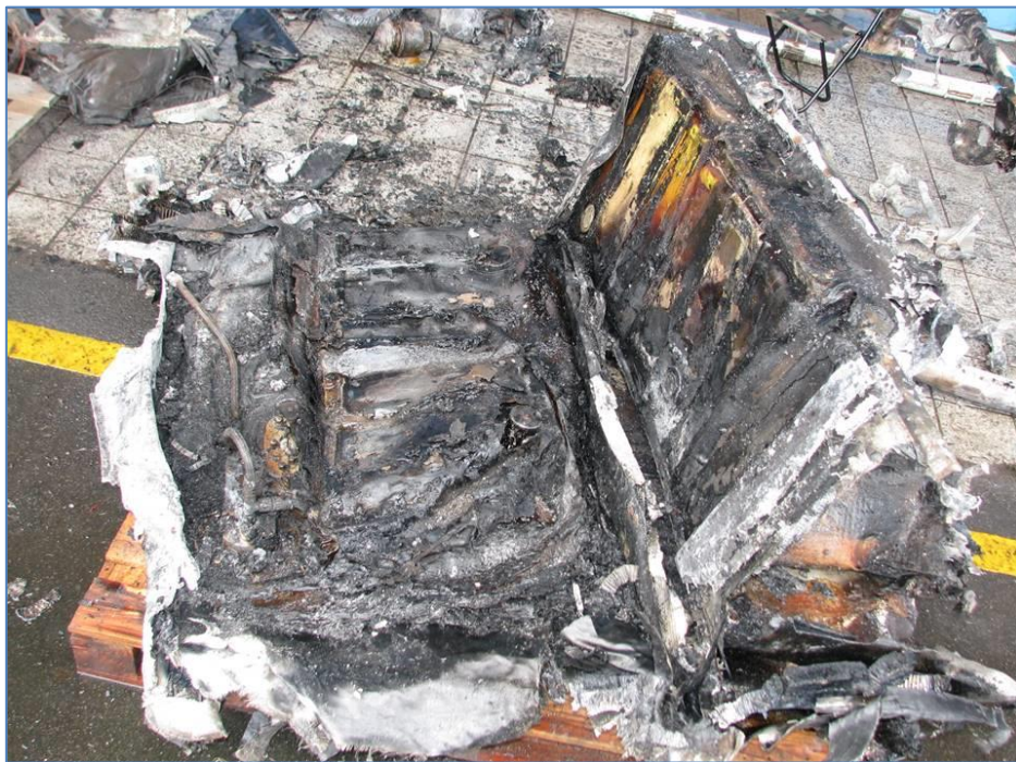
圖 1.16-1 L 型油箱燒毀情形
