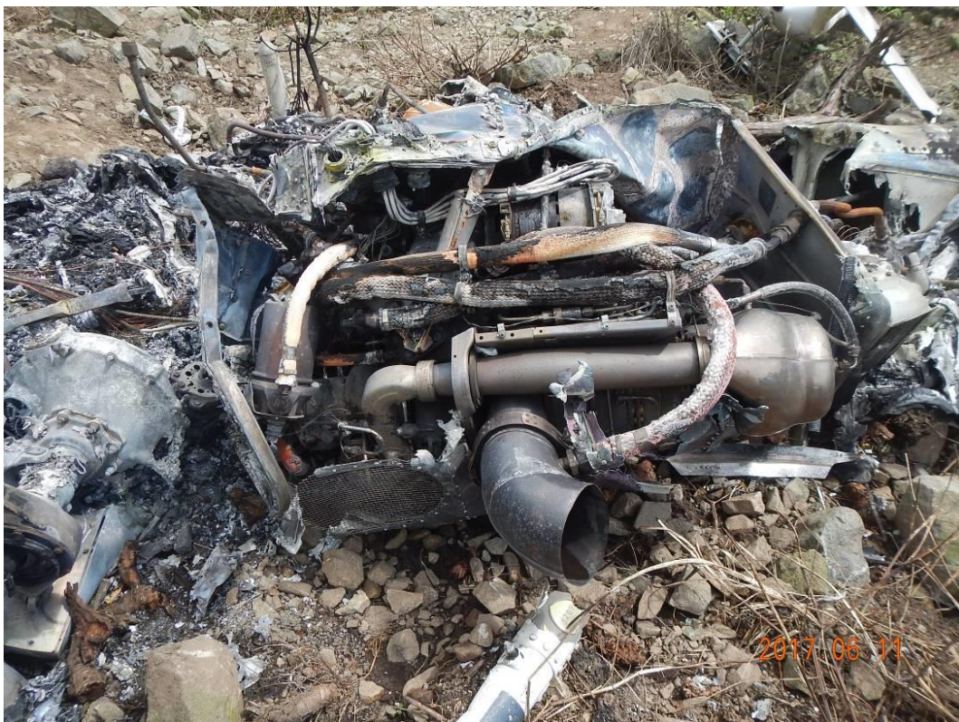
圖 1.12-13 發動機損害情形
