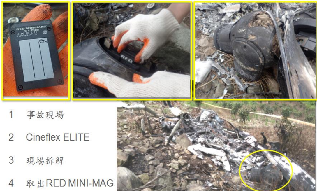
圖 1 Cineflex ELITE 現場拆解取記憶卡
