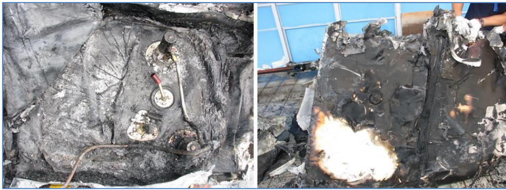
圖 1.16-2 油箱底部內外燒毀狀況
