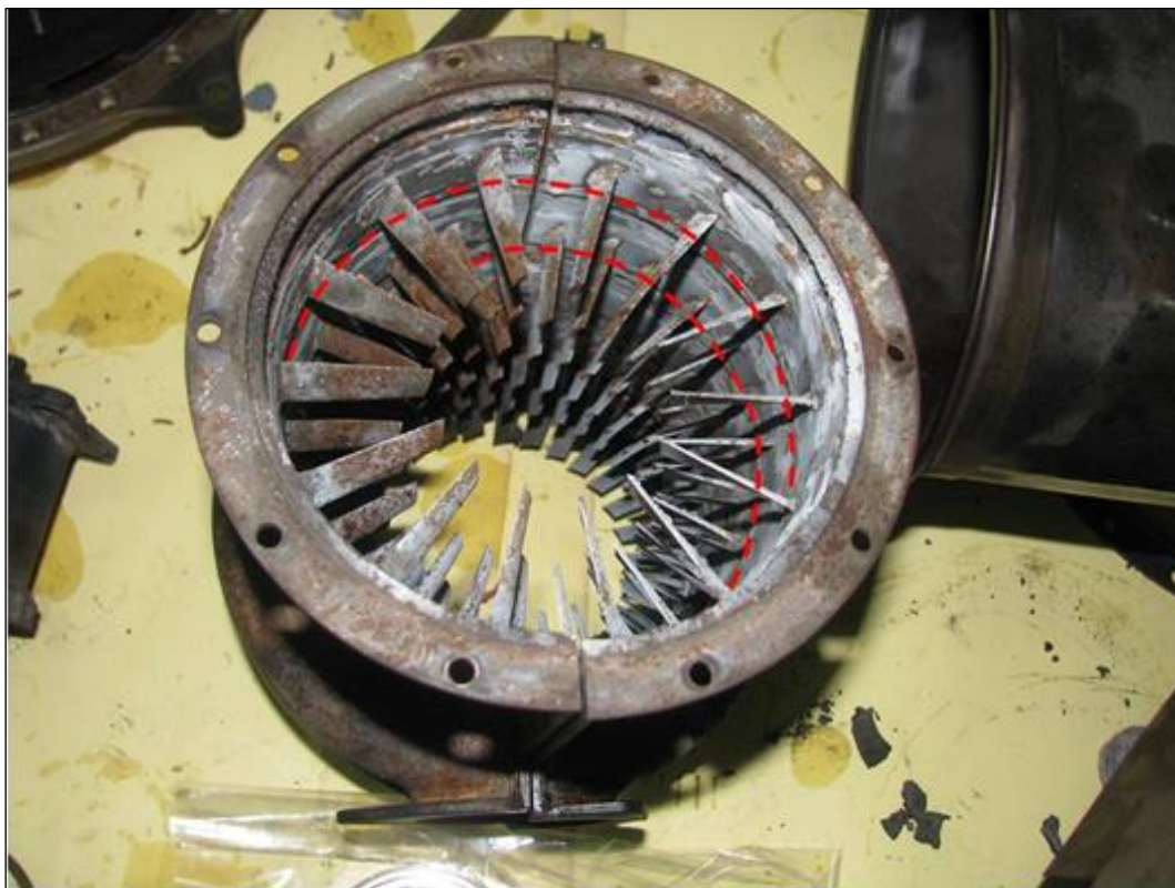
圖 1.16-5 壓縮器定子及葉片刮痕
