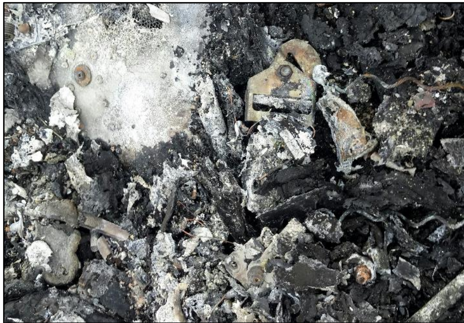
圖 1.15-1 安全帶鎖扣殘骸圖
