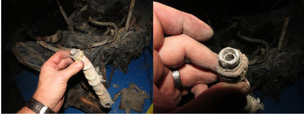
圖 1.12-12 燃油管接頭斷落情形
