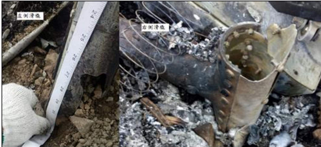
圖 1.15-2 左右滑橈插入地面狀況
