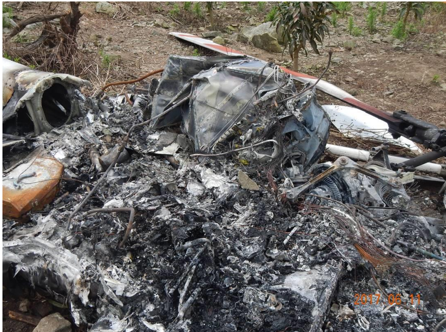
圖 1.12-7 機身結構及蒙皮完全焚毀情形
