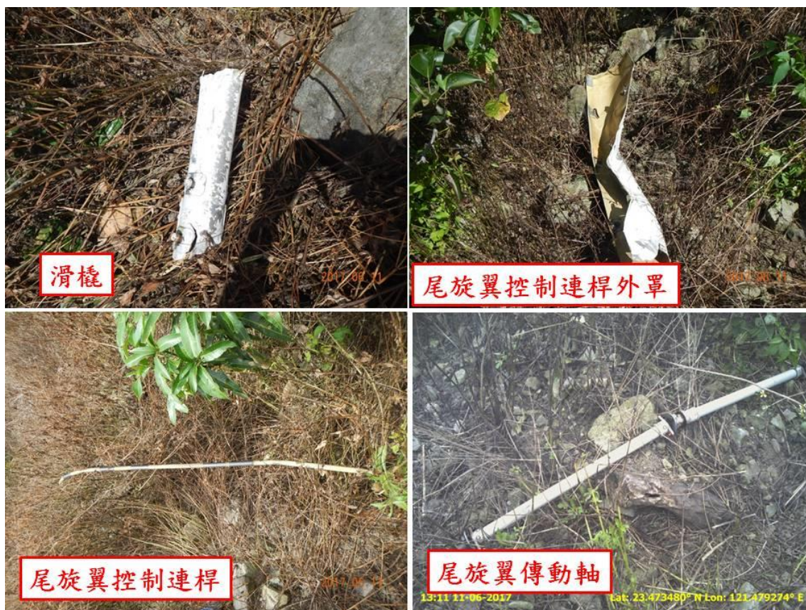
圖 1.12-15 散佈於主殘骸附近之殘骸
