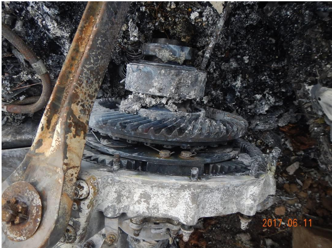
圖 1.12-8 主齒輪箱外殼燒熔內部齒輪裸露情形
