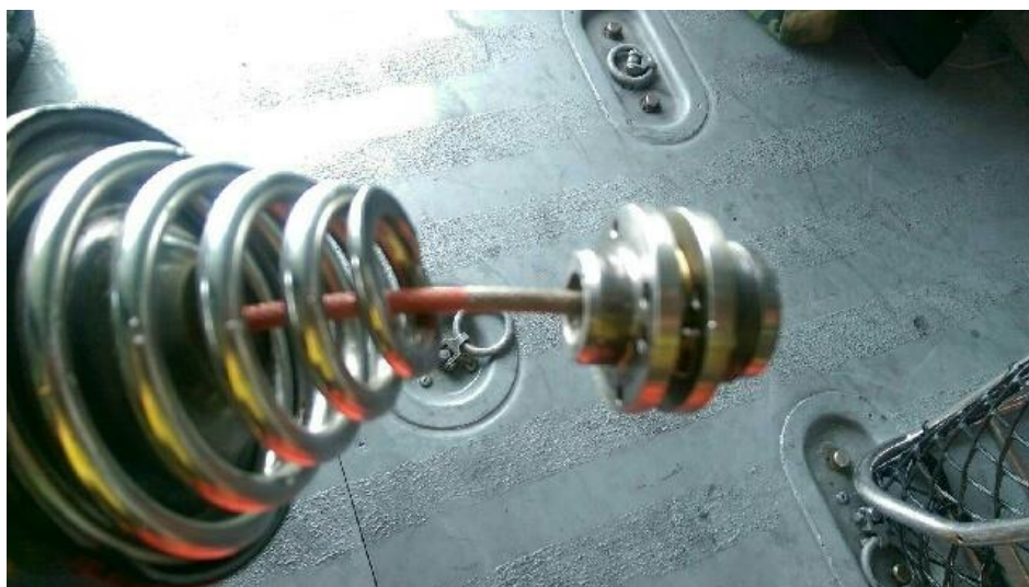
圖 1.12-1 與吊鉤軸承室脫離後之襯套螺帽
