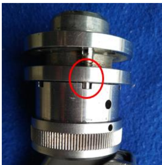
圖 2.2-1 固定螺絲進入軸承室之城堡狀凹槽情形
