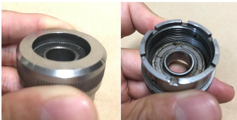
圖 1.16-2 軸承室底部與軸承室內部
