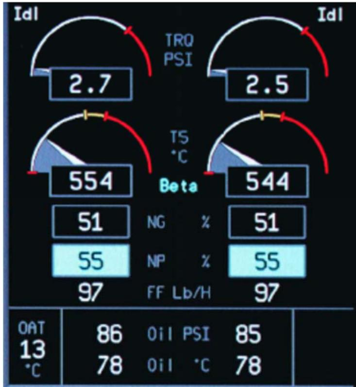
圖 1.6-2 發動機指示面板顯示藍色 Beta 指示
