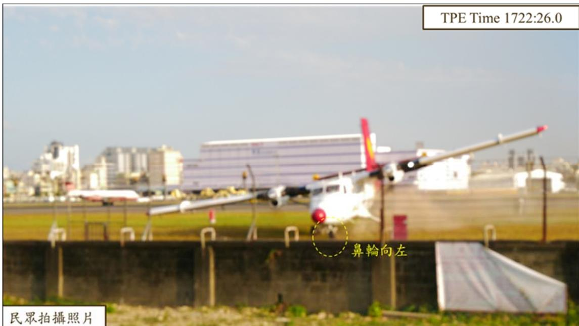
圖 1.11-13 事故機航向與跑道方向垂直照片
